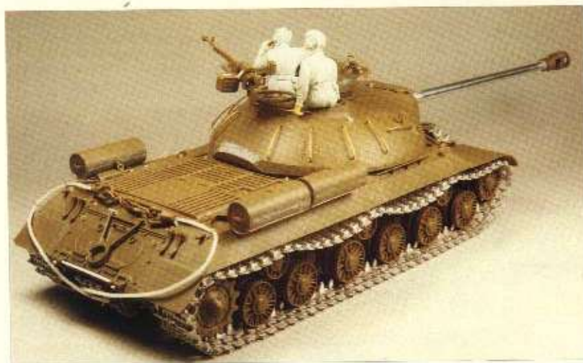
En bas. Sur cette photo, on aperçoit la forme de la tourelle coffrée au niveau du masque du canon ainsi que les améliorations apportées au phare et à l'avertisseur.
