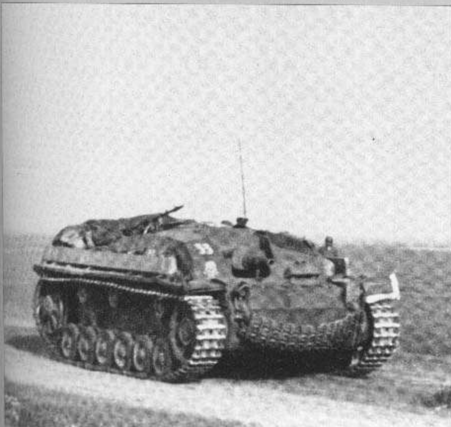
Ci-dessus. Ce Sturmgeschütz portant le numéro d'identification 33 est un modèle III C. L'un de ses garde-boue a été arraché tandis qu'une section de chenille pend d'une manière peu esthétique à l'avant.
