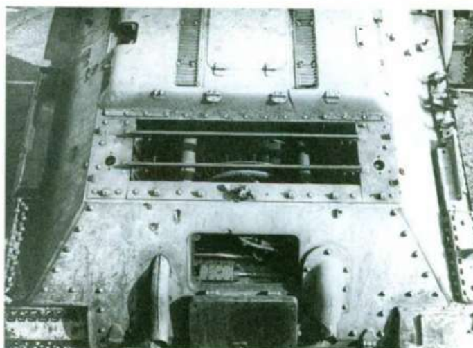
Ci-contre. Vue de l'arrière d'un T34/76A. Il est encore doté d'une trappe d'accès rectangulaire, alors que sur les modèles plus tardifs, celle-ci est ronde. On aperçoit le moteur diesel V2 de 500 ch. L'une des protections du tuyau d'échappement manque. (IWM)
