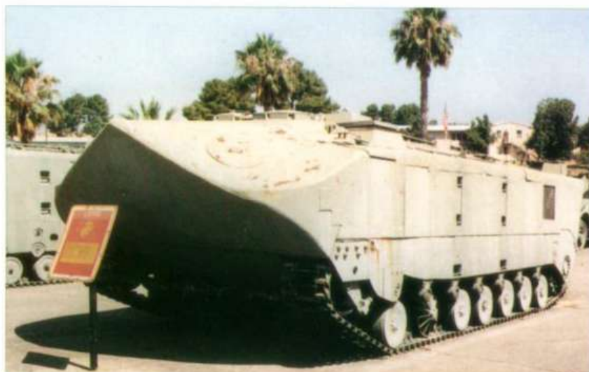
Ci-dessus. Exposé de nos jours au musée des engins amphibies de Camp Pendleton, sur la côte californienne, ce LVTPX1 est un prototype à proue modifiée destinée à offrir une visibilité supérieure au pilote et à améliorer la pénétration dans l'eau. Sur cette version, l'avant s'ouvre en deux parties, l'étrave se relevant. (Photo D. Chomette)
