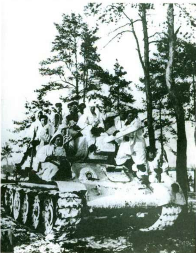
Ci-contre. Un T34/76B durant les combats de l'hiver 1941. Il possède des roues entièrement en acier et n'accueille pas moins de 14 fantassins sur ses superstructures. (IWM)
