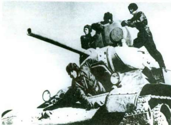
Ci-dessous. Un T34/76B et son équipage de quatre hommes. Les grandes trappes offrent un accès facile à l'intérieur, mais cet avantage est annulé par le poids des portes elles-mêmes. (IWM)
