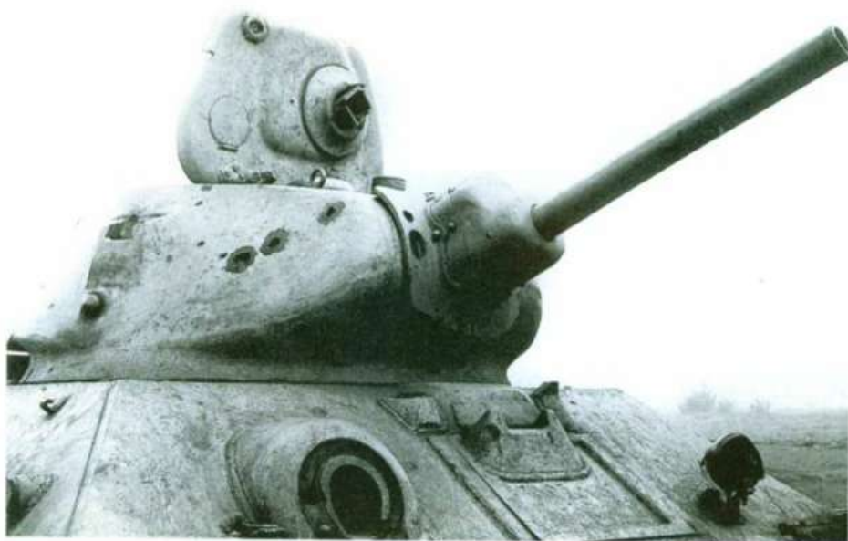
Ci-dessus. Gros-plan sur l'avant et la tourelle d'un T34/76 modèle A. La grande trappe d'accès à la tourelle est trop lourde et gêne considérablement la vision du chef de char lorsqu'elle est ouverte. (IWM)
