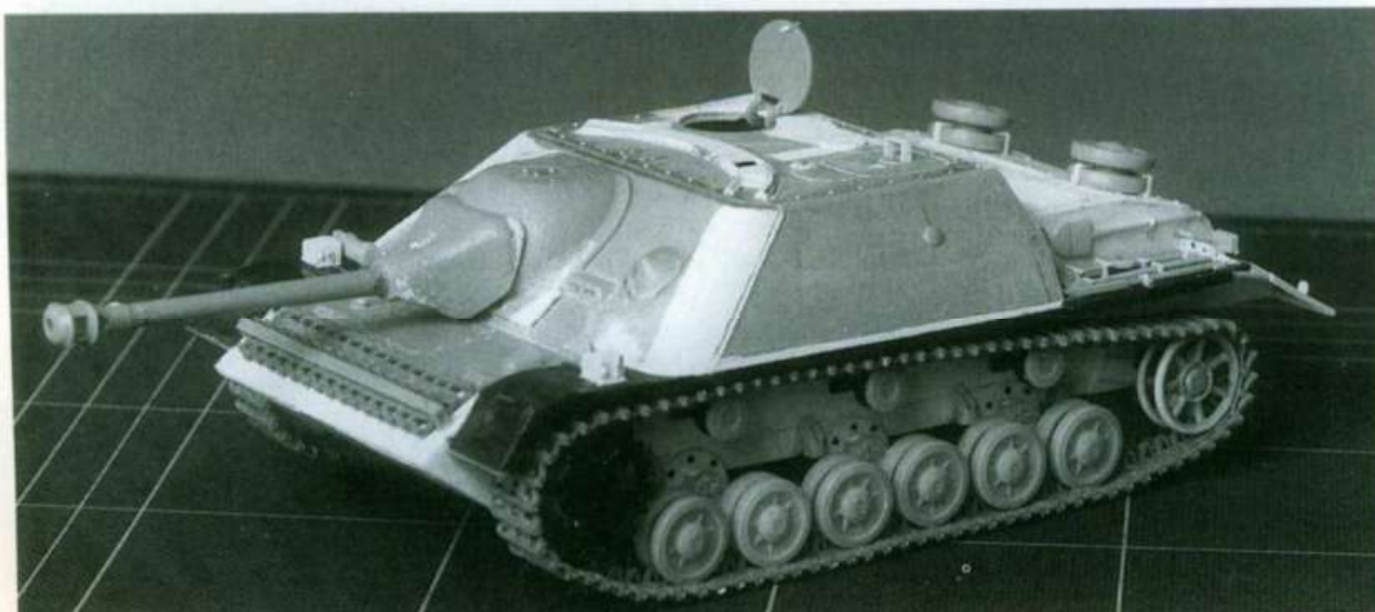
Ci-contre Cette vue permet d'apprécier le travail effectué sur la casemate du Jagdpanzer IV, notamment au niveau de l'arrondi des angles du blindage frontal. Le canon de 7,5 cm KwK L/48 est un modèle à tube court muni d'un frein de bouche.
