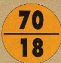
Plaque de tonnage, peinte, d'un tracteur Diamond T 980 et de sa remorque porte char
