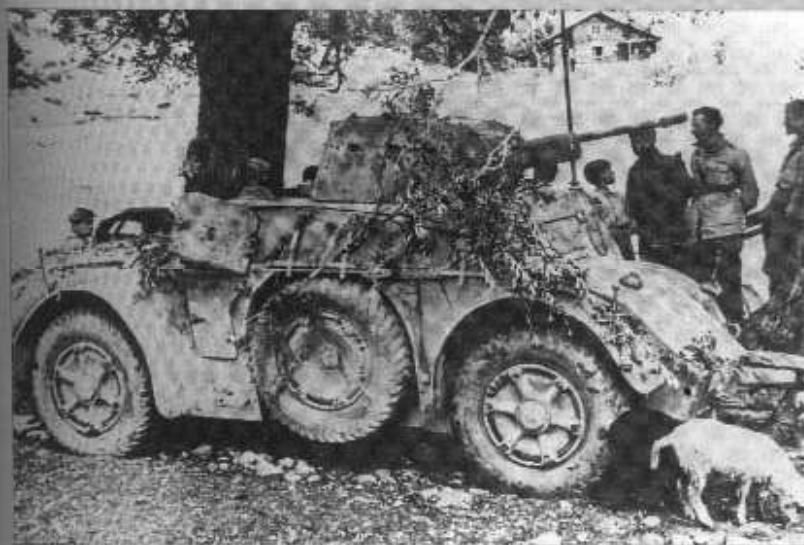
Ci-contre. A en juger par les tenues civiles et militaires des personnages en arrière-plan, on peut supposer que cette AB41 est sans doute utilisée par des maquisards italiens. Le dessin cranté des pneus est inhabituel (comparer avec les photos précédentes). Les fixations situées au-dessus de la roue de secours servent probablement à maintenir des jerrycans. (Photo Bovington Tank Museum)
