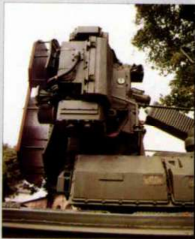
Ci-dessus, à droite. Vue de l'arrière. La plaque en forme de goutte cache la sortie d'un des hydrojets
