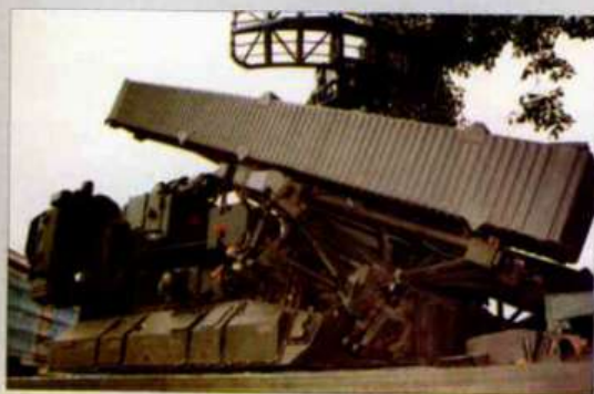
Ci-dessus, à gauche. Cet ensemble de boîtiers de formes diverses assemblés les uns aux autres est un des supports d'antennes de guidage
