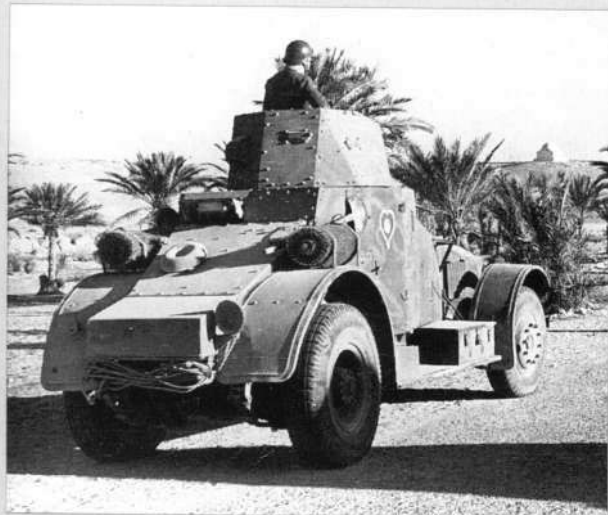
Ci-dessus. Vue en Tunisie en 1939-1940, cette Laffly 80 AM du 2 e peloton (as de cœur) du 2 e escadron du 4 e RCA (insigne peint au centre de l'as), a toute sa partie arrière repeinte, vraisemblablement en ocre jaune; les rouleaux de grillage sur les garde-boue arrière, non présent en métropole servent au franchissement des bancs de sable mou. (Photo ECP Armées)
