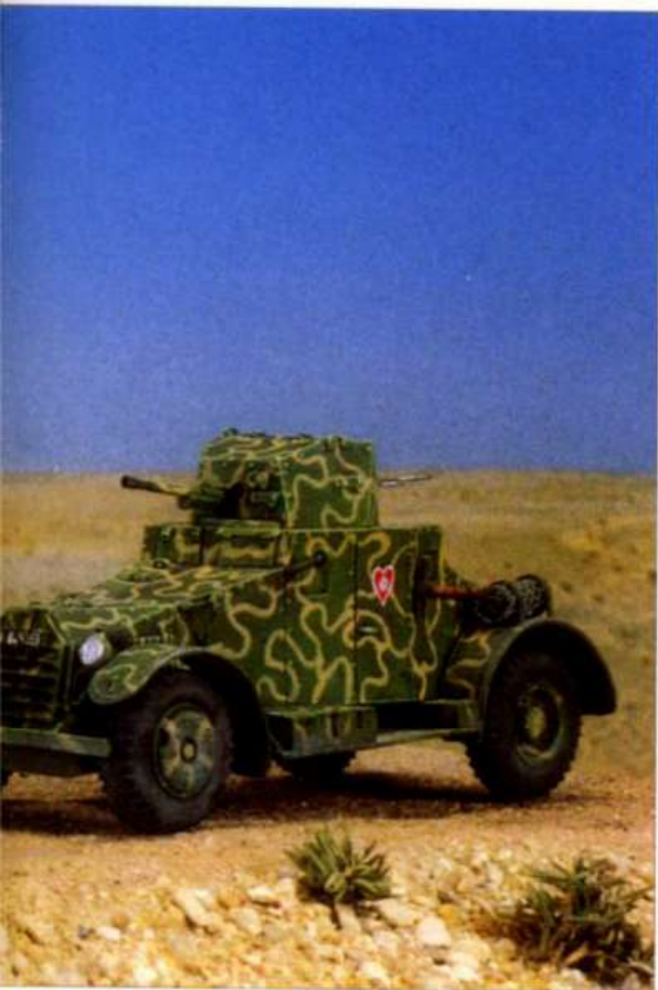
Ci-dessus. Sur l'AMD S 15 TOE, la disposition du pot d'échappement est des plus étranges et sûrement très inconfortable pour les passagers de la benne !
