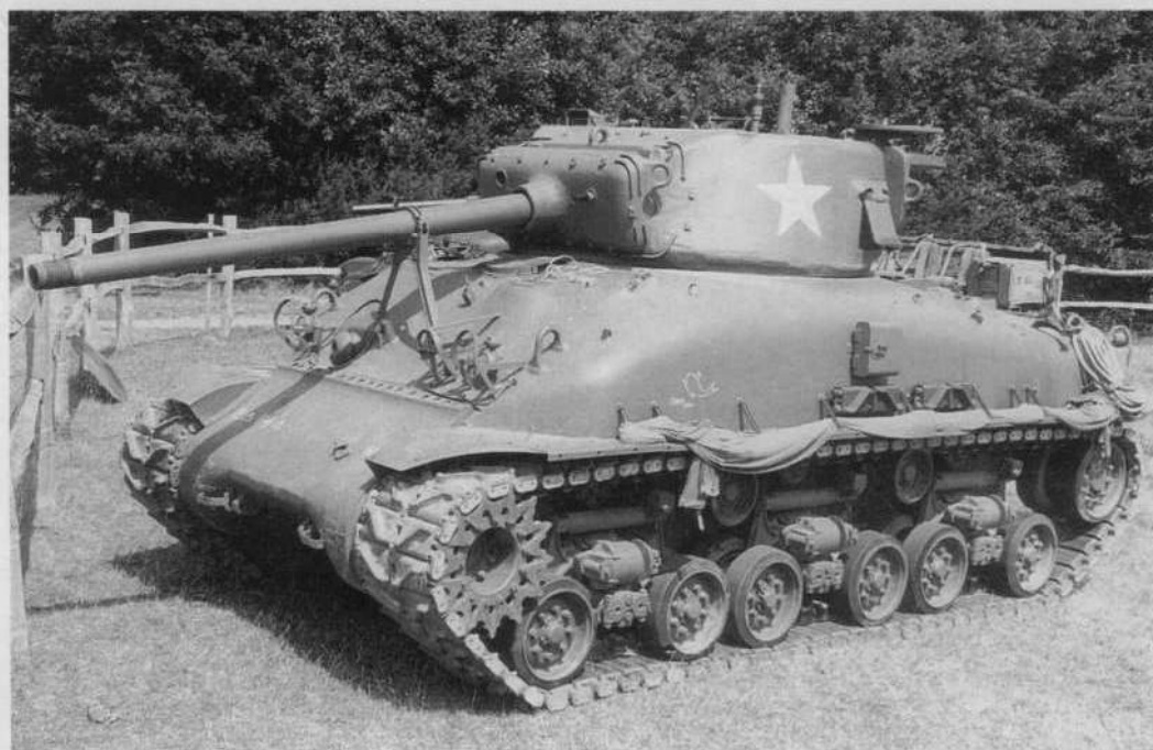
Ci-contre. Sherman M4A1E8 HVSS (Horizontal Volute Spring Suspension). Un engin qui, à priori, n'est pas engagé pendant la Seconde guerre. (Photo Gray Fraser)
