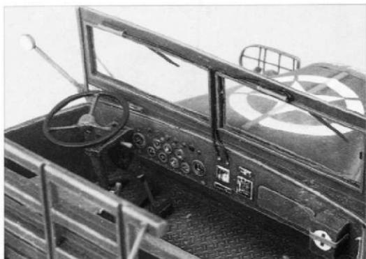
Le pare-brise provient de la maquette Tamiya, sur lequel la jupe a été remplacée par de la feuille d'étain. L'étui est réalisé de la même manière avec, comme gabarit, celui en plastique (affiné au papier de verre). De la bande plastique d'épaisseur 0,25 mm reproduit les supports d'attache au guidon.
