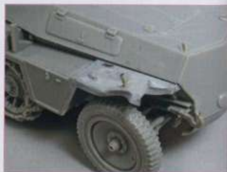
Ci-contre. Le garde-boue, entièrement refait à l'identique avec un morceau de feuille d'aluminium d'une barquette de produits surgelés, est déformé pour illustrer les dommages dus aux combats ou à un accident. Divers éléments sont ajoutés comme l'attache de la hache ou le support de l'antenne gabarit
