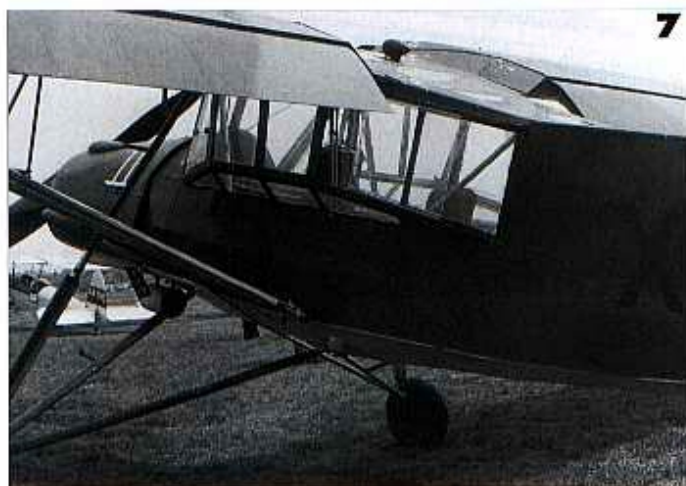
7 - La cabine vitrée caractéristique qui permet d'avoir un champ de vision vers le bas grâce au décalage d'une partie de la verrière. (W. Lathuillé)
