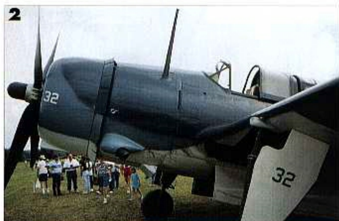
3 - La prise d'air inférieure sous le capot-moteur, une partie des volets de refroidissement, la pipe d'échappement, etc..
