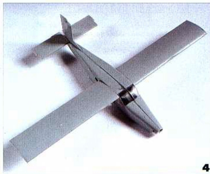
4 - La maquette Classic Plane sur laquelle le pare-brise est à refaire plus large. Plusieurs cartes plastique ont été collées de façon à obtenir une pièce un peu plus grande que l'ouverture avant. Cette forme est ensuite mise en forme par ponçage et sert de «master» pour remouler un nouveau pare-brise thermoformé. Chaque aile d'un seul tenant devra être légèrement dégauchie car elle présente un petit fléchissement.
