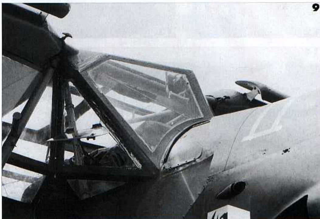
9 - Détails du pare-brise anguleux et du capot-moteur dont on peut voir le décalage par rapport au fuselage. (W. Lathuillé)
