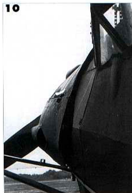
11 - Une vue générale du capot-moteur du Storch et de son train d'atterrissage gracile. Son surnom lui va comme un gant, la cigogne. Notez la porte qui épouse la forme du fuselage. (W. Lathuillé)
