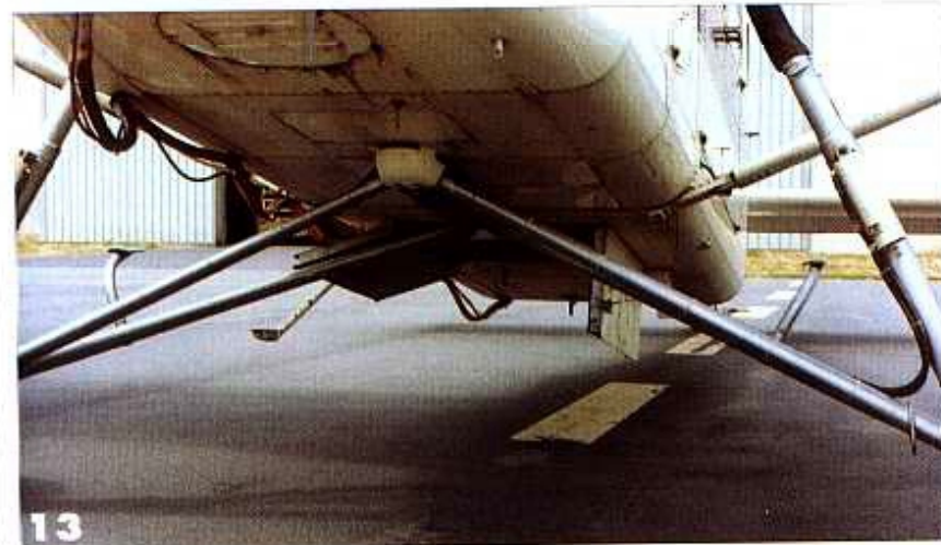
13 - Les bras du train d'atterrissage avec une vue du dessous de l'appareil et de ses trappes ventrales. Ce logement peut être utilisé pour l'emport de systèmes de reconnaissance. (J-L Achez)
