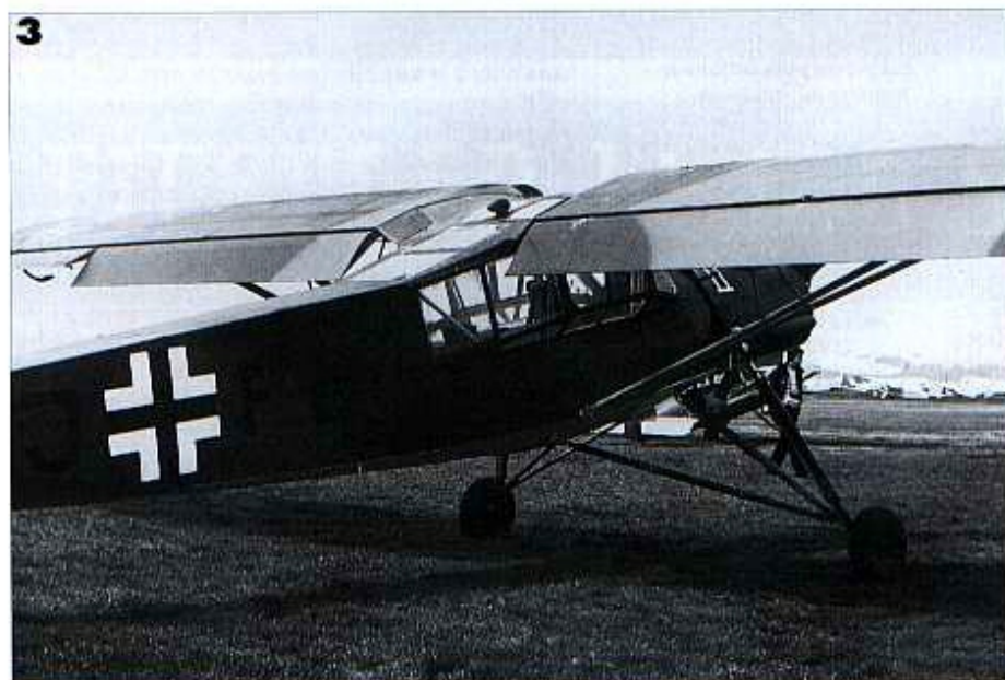
1 - Fieseler Fi 156 Storch vu à la Ferté Alais dans les années 70. Notez l'angle des volets de courbure (W. Lathuillé)
