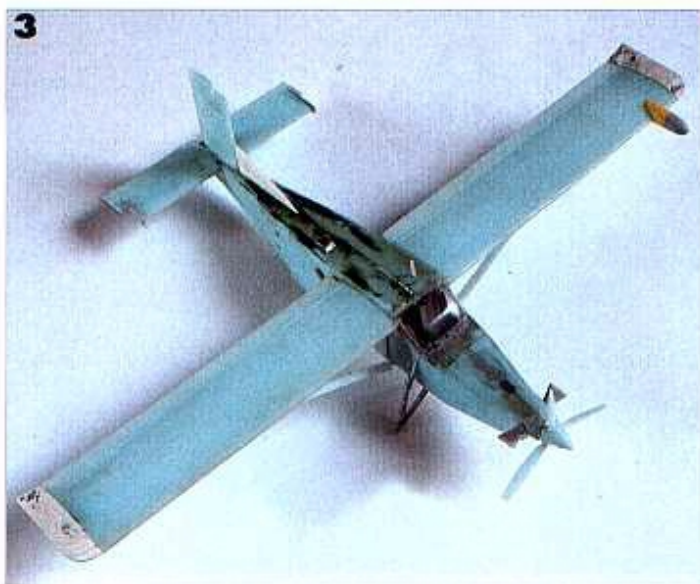
3 - La maquette Hi Planes Models avec tous les points de détails propres à la version de l'ALAT : extrémités de la voilure, radar sur le bord d'attaque, pied de dérive plus grand, etc. Sur le fuselage on voit la bande de carte plastique insérée pour agrandir la largeur de celui-ci.
