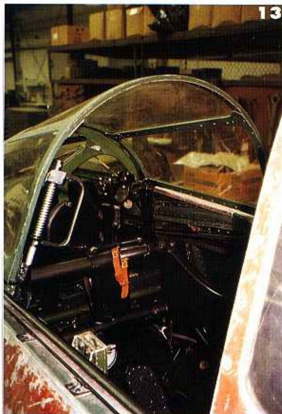
13 et 14 - La partie arrière de la verrière qui a été achevée et mise en place. On voit sur la vue de profil, la rainure de la partie collissante, non installée pour l'instant. La teinte rouge brunnâtre qui subsiste est un apprêt de protection.
