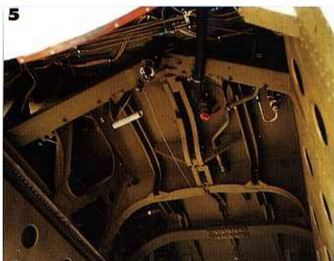
5 - Une portion du fond de la soute à bombes avec les nombreux renforts de structure, les tuyauteries, etc.
