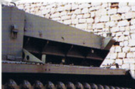
車体後部左側面の排気グリル。前方より見る。
