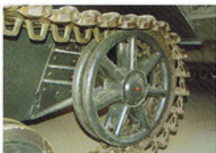
浴槽構造の誘導輪。同じく1943年10月以降は鋳造式の誘導輪が導入される。
