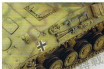
車体前面左側には後継手用視察グラスを配置。その下の円形パネルはブレーキ点検用パネル。
