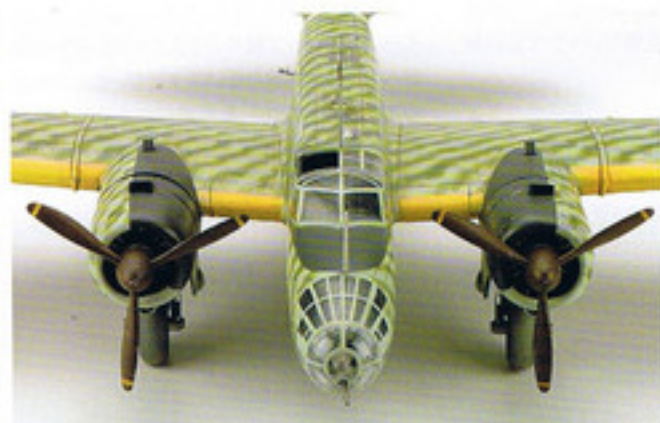
日本機らしく幹の多い風防。操縦席の上部は塩ビ板をヒートプレスし開状態に。
