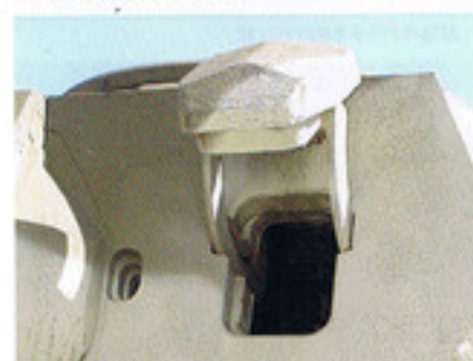
砲手用クラッチを開けた状態。照準口は用トイなし。
