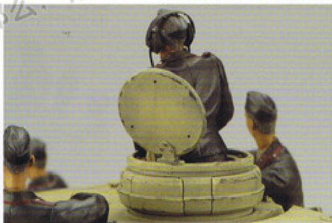
中期～後期生産車の一部の車両ではH型同様の1枚開き式キューボラ・ハッチを採用。
