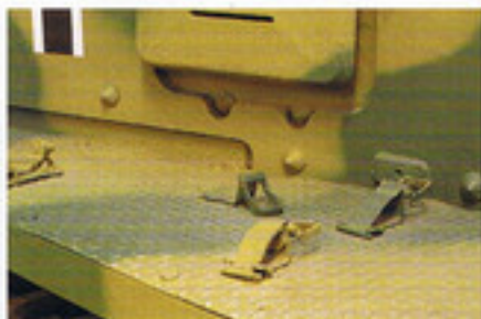
右フェンダー前部。弁やクランクの留め具が付いている。
