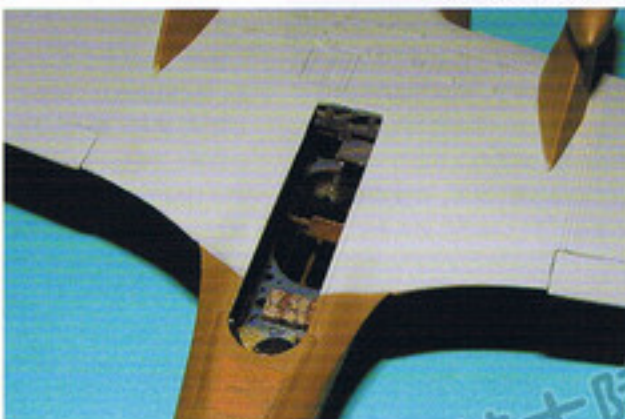
▼機体下部、砲撃手ゴンドラは別に塗装し、全体塗装の後に取り付ける。
