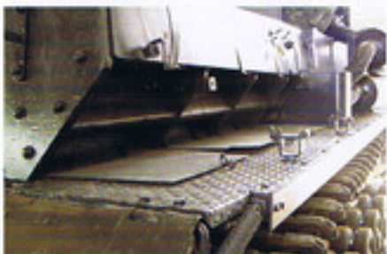
車体後部右側面の排気グリル。後方より見る。
