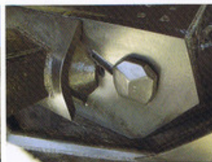
砲塔前面左には主砲照準口と砲手用クラッチを配置。
