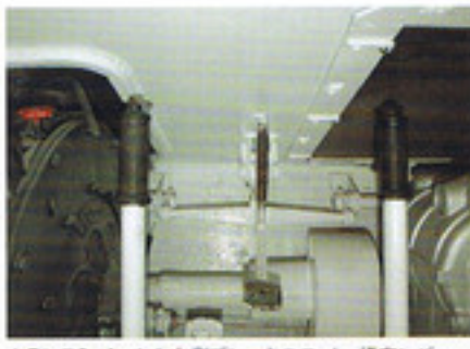
トランスミッションと左側ブレーキユニット、換向レバーの上部が見える。
