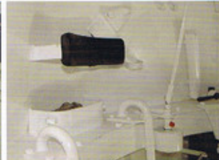
砲塔後壁に設けられた車長用ヘッドレスト。
