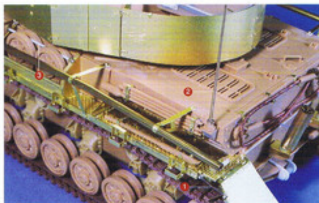
1:リアマッドガードの固定スプリングはブレイブモデルの極小スプリング使用。2:アンテナはパーフェクトメタルSRのパーツを使用。3:手前転輪ラックの固定シャフトはプラ棒で作製。
