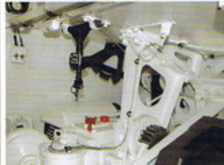
砲塔内左前部。砲手用照準器は取り外されている。
