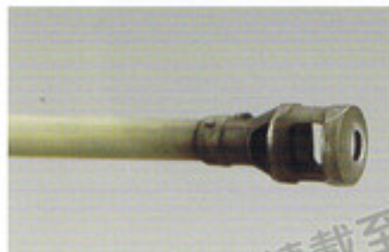
マズルブレーキは、シングルバフル式からダブルバフル式に変更。
