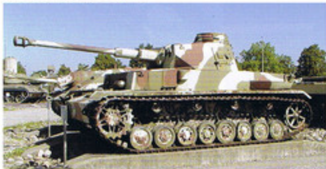
スイス、ツーンの戦車博物館に展示されているIV号H型中期生産車。パーツの欠損が多く、転輪の一部はIII号戦車のものを装着、また上部転輪、履帯もオリジナルとは異なっている。
