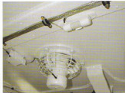
砲塔前方の天板にはベンチレーターを設置。
