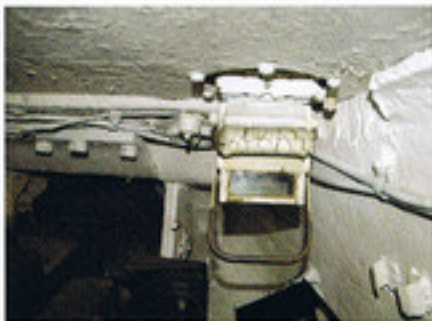
▲砲塔内右前部上面に設置された装填手用ペリスコープ。
