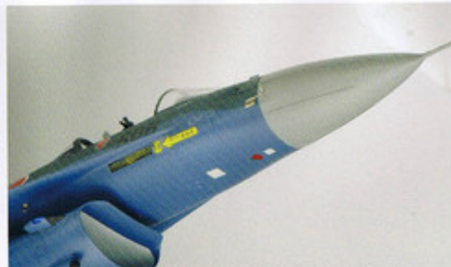
機首下面は一見変更がないように見えるが、実は約3.5mm延長、1.2mm拡張。
