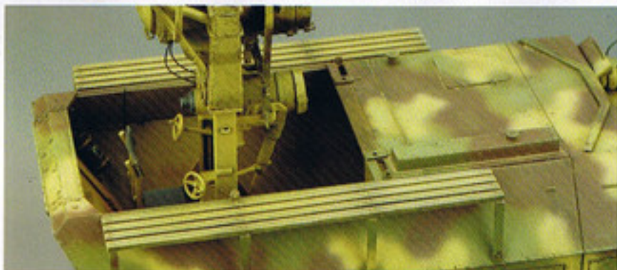
車体後部に大型赤外線投射ライトを装備。投射ライトは全周旋回可能だ。
