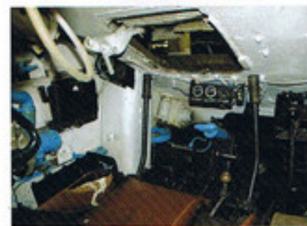
▲車体前部左側に設けられた操縦手席。茶色のシート座面の前方に操縦レバーや計器板、フットペダル類が見える。
