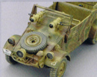
運転手席と助手席に1基ずつのFG1252赤外線スコープが設置されている。
