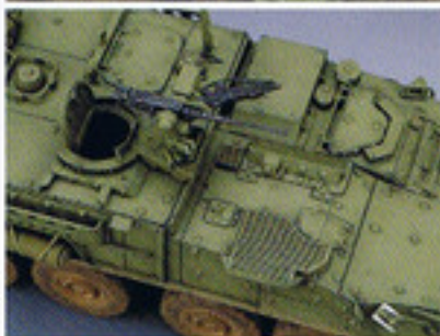
ストライカーの基本型M1126では、空輸等の制限により機関砲ターレットではなくRWSプロテクターと呼ばれる小型のリモコン操作式兵器ステーションを装備。
