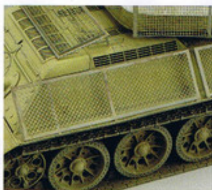
スプリングアーマーを装着する際は、外部燃料タンク取り付け用の穴は塞いでおこう。
