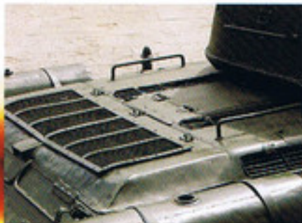
▲車体後部の機関室上面。前方にV-2ディーゼルエンジン、その後部にラジエーター冷却器を配置。
