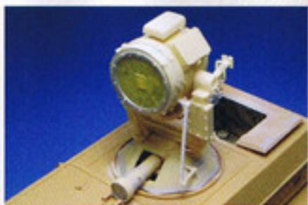
赤外線投射ライトはNKCのレジン製パーツ使用。ディテール仕上げ、成形状態ともに良くできている。
