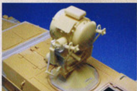
赤外線投射ライトはNKCのレジン製パーツ使用。ディテール仕上げ、成形状態ともに良くできている。
