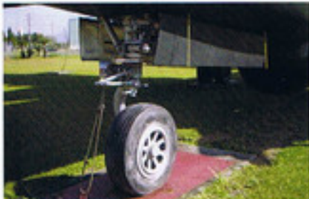
シルバーで塗装された前車輪。展示状態のため、オレオがフル圧縮になっている。
