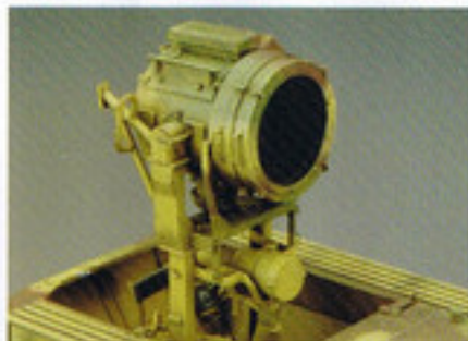
車体後部に大型赤外線投射ライトを装備。投射ライトは全周旋回可能だ。
