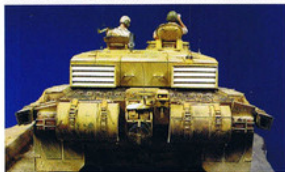
砲塔の白いパネルは、味方の誤射を防ぐための敵味方識別用のCIPパネル。
