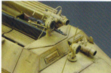
ファルケの特徴である操縦手用赤外線暗視装置と同装置付きのMG42機銃架。
