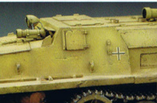
Sd.Kfz. 251/20ウーファーと同様に操縦手視察口前に赤外線増視装置を装備。操縦手用増視装置は20cm径赤外線ライトとFG1252赤外線スコープの組み合わせ。
