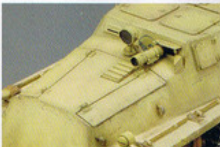
Sd.Kfz. 251/20ウーファーと同様に操縦手視察口前に赤外線増視装置を装備。操縦手用増視装置は20cm径赤外線ライトとFG1252赤外線スコープの組み合わせ。
