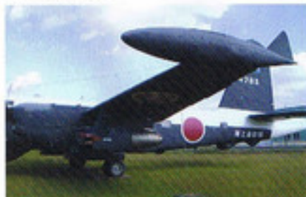
左翼の翼端ナセルと補助ジェットエンジンIHI J3-7Cのナセル。
