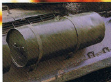
▲車体後部右側面に設置した前部燃料タンク。
