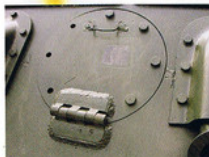
▲車体後面の中央に設置されている点検ハッチ。
