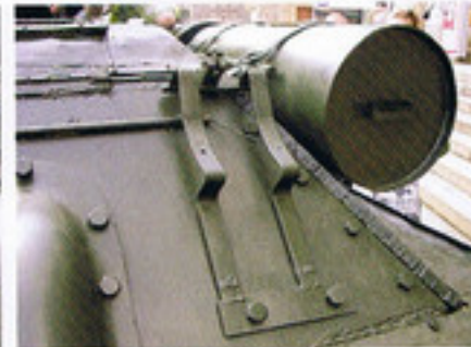
▲車体後面両側(写真は右側)には燃料タンクの固定具を設置。
