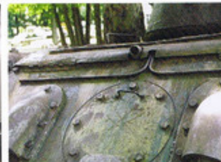
▲点検ハッチ上部のパイプは外部燃料タンク用の給油管。
