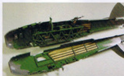
胴体にコックピットを組み込み。胴体側面は羽布張りなのでバフで塗装。
