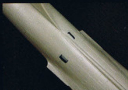
胴体上面の補助エアインテイクを2ヶ所開口。ブラバンのドアを内側から付ける。
