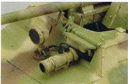
車体前面の操縦手視察口の前に設置されたFG1252赤外線スコープ。その横には赤外線ライトを設置。キットの指示どおりだと砲身直下になるので、オフセットしたほうが良いかも。
