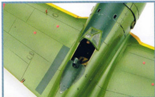
▲中島系戦闘機の特徴でもある開口部を極力小さくしたコクピット。
