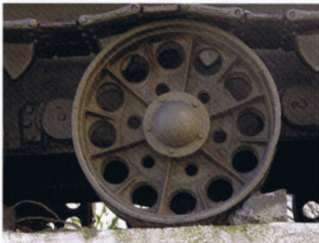
▲写真の転輪はゴムリム部がなくなっている。
