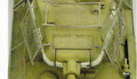
砲台上面にもスプリングアーマーを装着。市街戦では建物の上階から撃ち込まれることもあるので、この措置はかなり有効。
