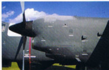
エンジンナセル側面。そこかしこにエアスクープやスリットが設置されている。
