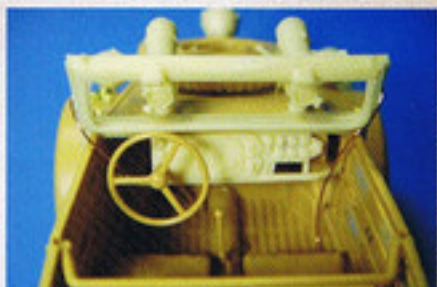
フロントの計器パネルも通常型とは異なり、助手席側に小さなスイッチを配したパネルが追加されている。
