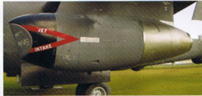
鹿屋基地に展示されている2機のP-2Jのうちの1機、4783号機。P-2J最終号機である。左翼の補助エンジンナセル。通常通り空気取入口カバーを付けた状態。
