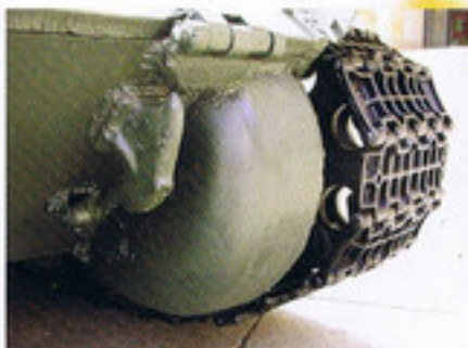
▲車体後部下側のデファレンシャルカバーの張り出し部と牽引フック。
