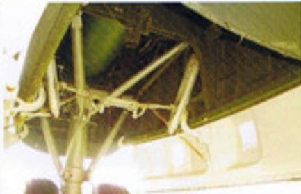
胴体内部。脚柱はシルバー、カバー内部は白、胴体内部はインテリアグリーンで塗装。
