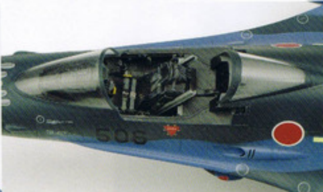
コックピット部。第1風防は塩ビ板をバキューム成型して自作。内部もエッチングパーツでMFDを取り付けるなどディテールアップ。
