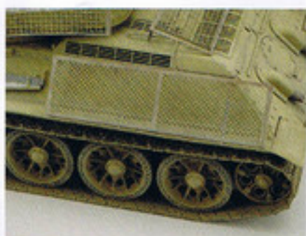
スプリングアーマーを装着する際は、外部燃料タンク取り付け用の穴は塞いでおこう。
