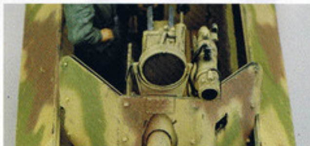
防盾中央に赤外線投射ライトを設置。防盾右側には赤外線装置用の電源器を追加装備している。
