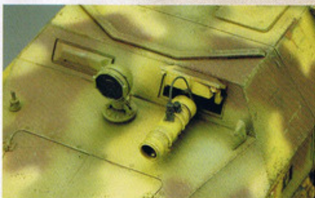
操縦手用視察口にFG1252赤外線暗視スコープを装備。その横には20cm径赤外線ライトが設置されている。
