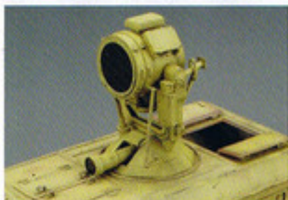
赤外線投射ライトは60cm径Sw.36サーチライトに赤外線フィルターを装着。ライトの下にはBG1251赤外線スコープを設置。
