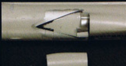
胴体下面は合計3ヶ所のエアインテイクがある。ドラッグシュート格納部も開口した。
