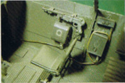
助手席側にも配線を追加。これらの配線はMG機銃架の陸視装置に繋がる。
