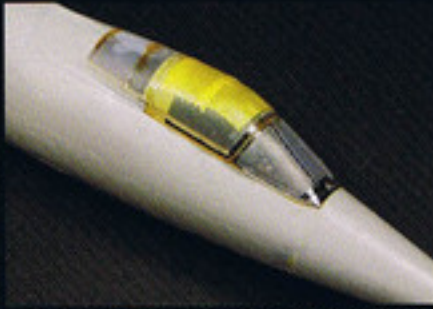
キャノピーは胴体と一緒に塗装するため、マスクングゾルで仮止めしておく。
