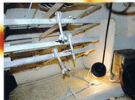
▲砲塔内後部。4段式の砲弾ラックには12発(1段×3発)の砲弾を収納できる。
