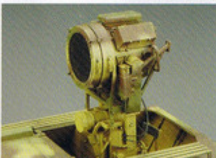
赤外線投射ライトは60cm径Sw.36サーチライトに赤外線フィルターを装着したもの。
