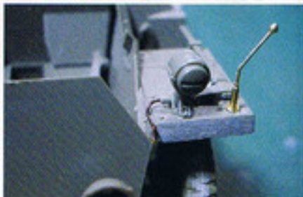
左フロントフェンダーに付くボッシュライトのライトコードを真ちゅう線で追加。
