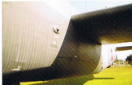
主翼取り付け部と爆弾倉。外板の継ぎ目は溶接となっているため滑らか。
