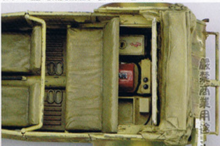
リアシートの後部に赤外線暗視装置用の電源ボックスが置かれている。
