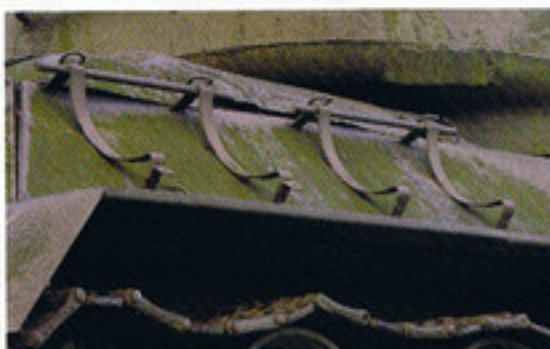
▶車体右側の燃料タンク固定具。右側には2個、左側は1個の燃料タンクを装着。
