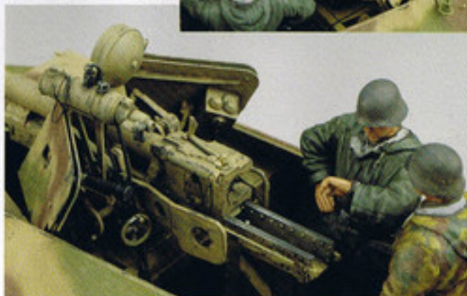
防盾中央に赤外線投射ライトを設置。防盾右側には赤外線装置用の電源器を追加装備している。
