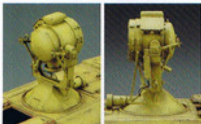
赤外線投射ライトは60cm径Sw.36サーチライトに赤外線フィルターを装着。ライトの下にはBG1251赤外線スコープを設置。
