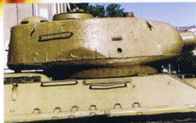
T-34/85の砲塔。写真はいずれもポーランドの軍事博物館に展示されている車両で、側面部の形状が若干異なっている。
