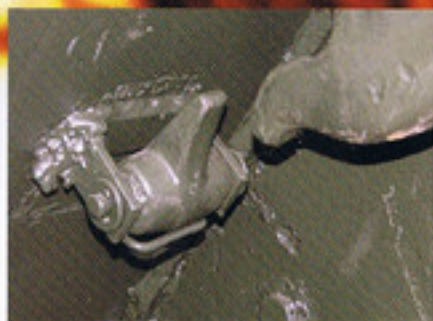
▲車体後部の牽引フック。フックの下に牽引ロープが外れないようにするためのストッパーが設置されている。
