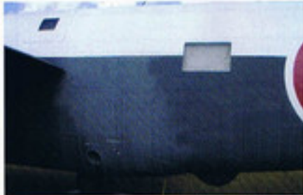
主翼後部の胴体左側。下部のレドームは64号機以降から装備された新設計のもの。
