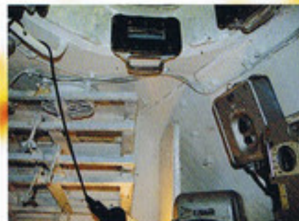
▲砲塔内後部。4段式の砲弾ラックには12発(1段×3発)の砲弾を収納できる。
