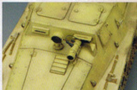
Sd.Kfz. 251/20ウーファーと同様に操縦手視察口前に赤外線増視装置を装備。操縦手用増視装置は20cm径赤外線ライトとFG1252赤外線スコープの組み合わせ。
