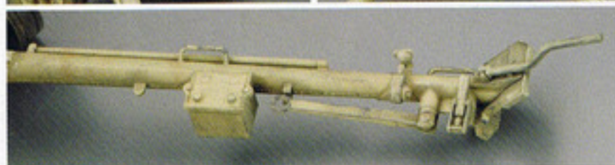
右側に暗視装置用のバッテリーボックス(?)を装着。
