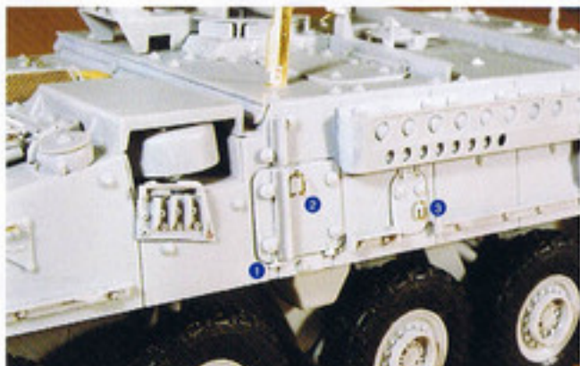
1: ヒンジのシャフト部をプラ棒で作製。2: 取っ手を真ちゅう棒で作製。3: 取っ手を真ちゅう棒で作製。
