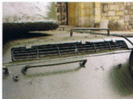
▲車体後部の機関室上面。前方にV-2ディーゼルエンジン、その後部にラジエーター冷却器を配置。
