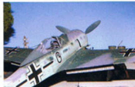
コックピットとフラップのみエデュアルドのエッチングパーツでディテールアップした。
