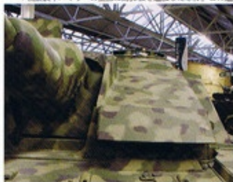
▼視察装甲バイザーの上部に防弾板を追加した車体。この追加防弾板は現地部隊によるもので、戦中撮影された実車写真でも確認できる。
