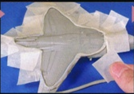
▼塗料が乾く前にシンナーにひたした平筆で表面に延ばしていく。
