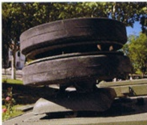
▲冷却器用吸気口カバー上に装備した予備転輪。未使用の転輪ではゴムリム表面にパーティングラインがあることに注目。
