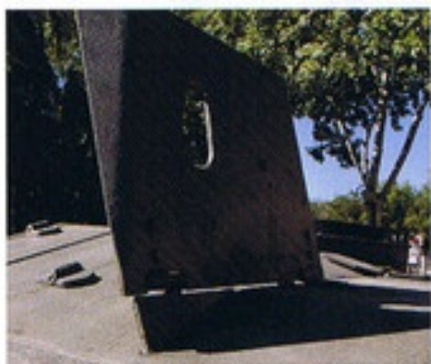
▲戦闘室右側の装填手ハッチ前には可起式の機銃用防盾を装備。 ▼装填手用ハッチ。装填手用ハッチ右側の小さな板（2つの穴がある）はシュルツェン架の取り付け部。
