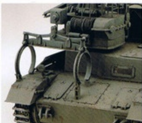
▲砲弾吊り上げアームは未使用時は、写真のように車体前部に固定する。
