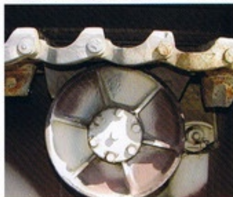
▲後期生産車で多用されたリブ付き鋼製上部転輪。
