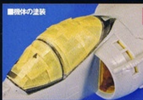
▲キャノピーを機体に接着しエアインテイク内部をマスキング。▼透明度を上げたUSグレーでパネル中央部にハイライトを付ける。
