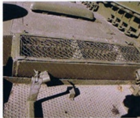
▲機関室右側面の吸気口。開口部にメッシュを装着。
