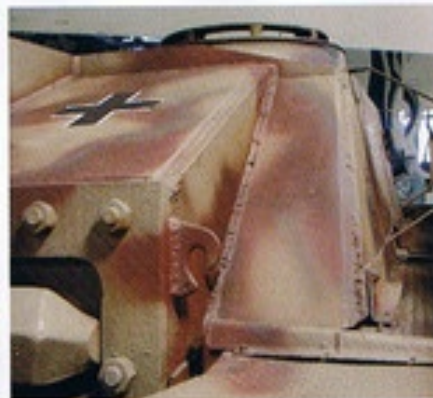
▲戦闘室前面、主砲下部。駆逐機カバーとの隙間を埋めるための防弾板が確認できる。
