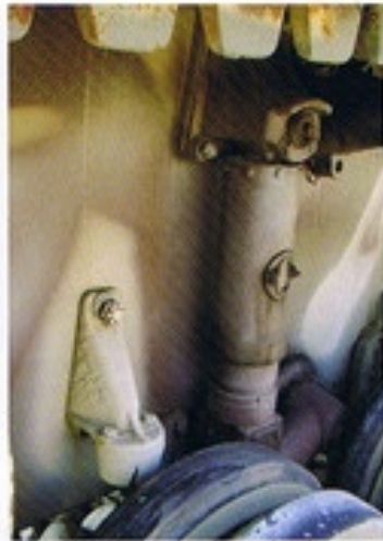
▲ショックアブソーバーの横に見える台形状の突起物はダンパー。
