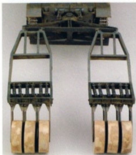
▲車体前部に装備した地雷除去装置。ローラーで地雷を踏み潰れる方式。
