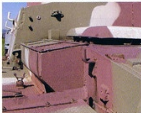
▲機関室左側。キャブレター用吸気口カバーの下側や吸気口の張り出した部分の形状がよく分かる。
