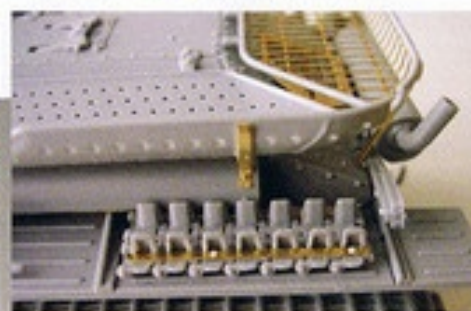
▼左フェンダー後部の履帯止めにもボルトを追加。
