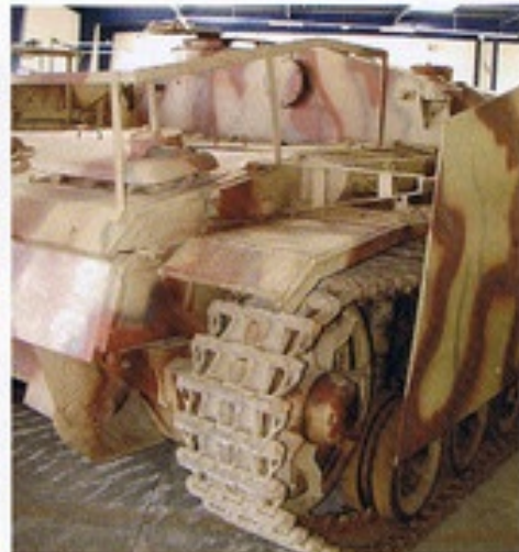
▲車体後部左右側面付近。フェンダーやシュルツェン支持架などの取り付け方がよく分かる。
