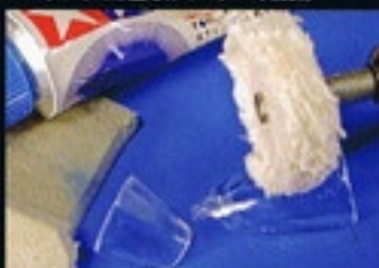
▲キャノピーのパーティングライン処理。耐水ペーパーで磨いた後、タミヤのコンパウンドで仕上げ。
