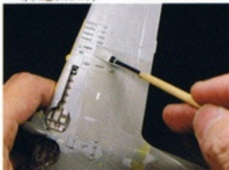
▼下面色は明灰白色（三愛系）。塗ムラは気にせず、均一の厚さに塗るのがコツ。
