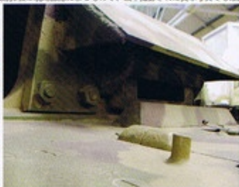
▼視察装甲バイザーの上部に防弾板を追加した車体。この追加防弾板は現地部隊によるもので、戦中撮影された実車写真でも確認できる。
