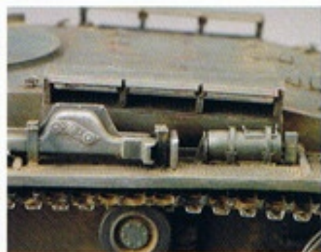
▲機関室側面の吸気口には砂塵や地雷の破片等が入らないようにするための防護板が追加されている。
