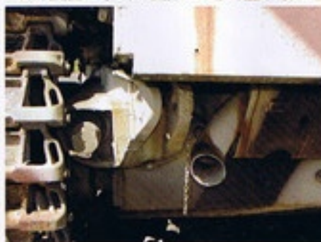
▲車体後部の排気口とその下のマフラーを見たところ。 ▼車体下部後面の牽引フックと履帯テンション調整具（写真左側）。牽引フック下には尾灯を装着。
