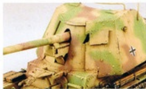
▲砲身はアルミ製パーツとプラ製パーツを選択できる。 ▼機関室内の塗装は、機関室と車体を接着する前にやりたい。
