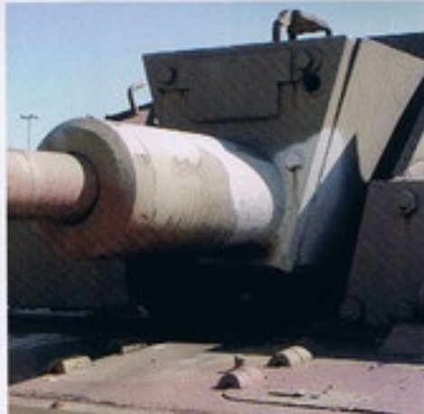
▲こちらの展示車は戦闘室前面右側に追加装甲板を装着。 ▶初期型タイプの駆逐収座機カバー。カバー前面左上部の穴は同軸機銃の機銃口。
