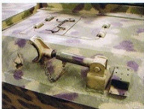
▲▶ 後期生産車から取り付けられるようになった車体前部の主砲 固定用トラベルクランプ。クランプの左横（写真では右横）の基 部にはノックライトが付く。ツーン展示車（右写真）ではクラン プに支持板が付いているが、当然これはオリジナルにはないもの。
