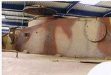
▼車体後部の機関室前部のエンジン点検ハッチには、キャブレター周吸気口カバーを設置。
