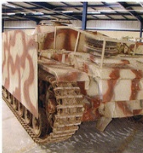
▲車体後部左右側面付近。フェンダーやシュルツェン支持架などの取り付け方がよく分かる。
