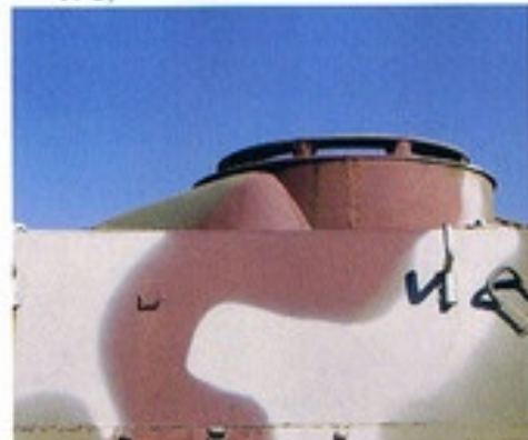
▼戦闘室左側面上部。写真の車体はフックを追加装備している。
