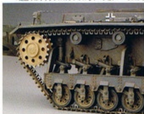
▼足廻りはオリジナルのシンプルなトーションバーサスから一変。車高アップは、当然、地雷爆発の衝撃から車体下部を守るための措置。
