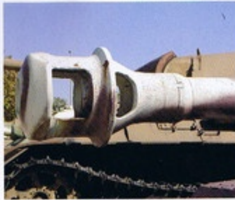
▲主砲マズルブレーキ。マズルブレーキは形状の異なるバリエーションがあるので、特定の車体を機型で再認する場合は形状を要チェック!
