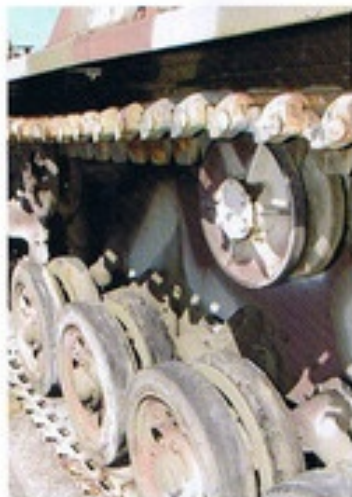
▲フーン展示車の足回り。こちらの車体の上部転輪は後期生産のリブ付き鋼製タイプ。
