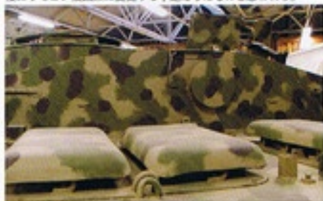
▲写真の車体は機銃用防盾の後面にリモコン式機銃架取り付け部（円形）が設置されている。円形蓋をボルト止めしているため、おそらく取り付け部を先に設置しておいて、後にリモコン機銃架に変更する予定だったものと思われる。
