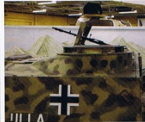
▼戦闘室上開左に設けられた車長用キューボラ。写真の車体は後期生産車なので、キューボラ前面に銃弾用ブロックを設置。
