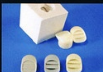
▲キットの座席ノズルパーツからディテールアップした原型を作りレジンで複製。
