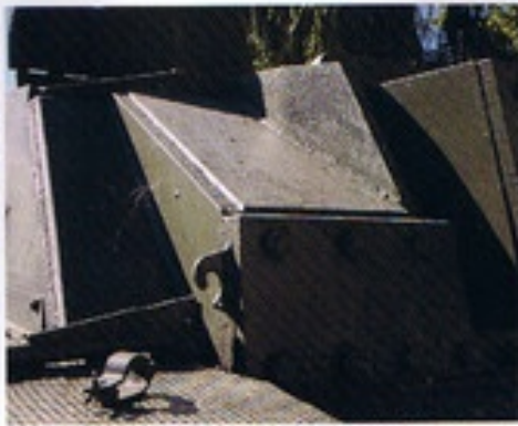
▲こちらの展示車は戦闘室前面右側に追加装甲板を装着。 ▶初期型タイプの駆逐収座機カバー。カバー前面左上部の穴は同軸機銃の機銃口。
