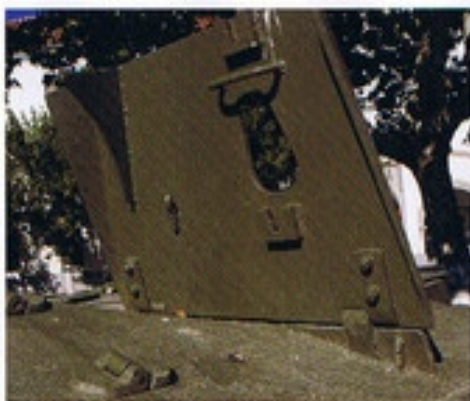
▲写真の機銃用防盾はMG34用だが、MG42を使用する車体では防盾開口部の穴が左右に大きくなっている。
