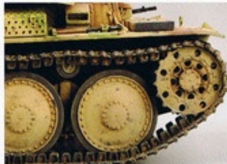
▼砲室後部の軽の穴が開いた板もリアルな仕上がり。パイプ状ラックはエッチング（加工済み）で再現されている。▲本キットの履帯もリアルで組み立て簡単な“マジック履帯”と名づけている。
