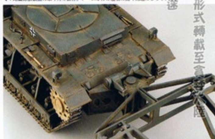
◀地雷除去装置の取り付け部分。アーム本体は左右に動く構造になっている。
