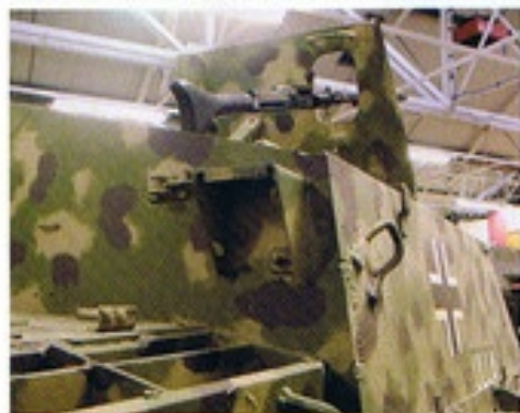
▲戦闘室後部アンテナ基部のクローズアップ。
