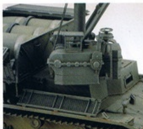
▲砲弾吊り上げクレーンも良くできています。実車は電動式で砲塔周囲モーターを動力源として使用していた。
