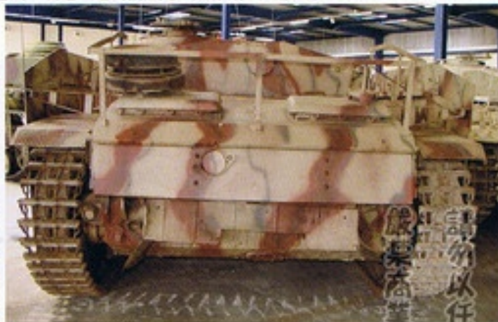
▲車体後部左右側面付近。フェンダーやシュルツェン支持架などの取り付け方がよく分かる。
