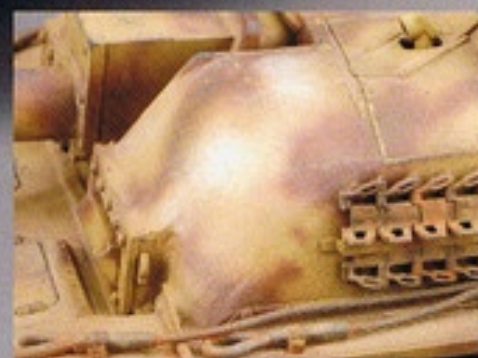
▲戦車前部左右にコンクリートを盛りつけて防弾力を強化させた車両を再現。
