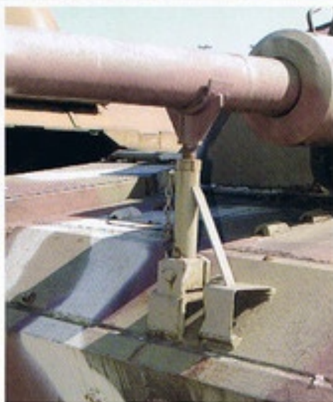
▲▶ 後期生産車から取り付けられるようになった車体前部の主砲 固定用トラベルクランプ。クランプの左横（写真では右横）の基 部にはノックライトが付く。ツーン展示車（右写真）ではクラン プに支持板が付いているが、当然これはオリジナルにはないもの。
