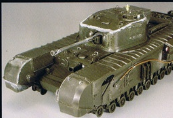
▲車軸工員の留め具と牽引ロープ、取っ手はアルミ製の棒やエッチングパーツ、金属線で作製。
