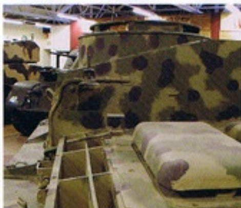
▲写真の機銃用防盾はMG34用だが、MG42を使用する車体では防盾開口部の穴が左右に大きくなっている。
