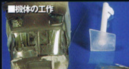
▼前部キャノピーもヒートプレスで作成。右側は割れた状態に。
