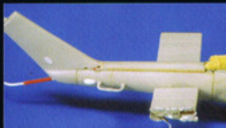
▼テイルブームの破損部分はアルミ板でスクラッチした。
