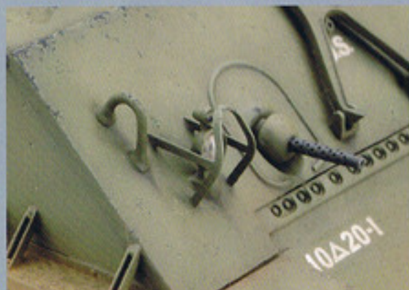
▲ライトガード、ペリスコープガードはエッチングパーツを使用。
