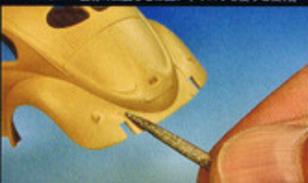
▲パーツ表面、パネリングラインなどにペーパーを貼付けて整形。 ▼バンパー部分の凹部などは細い平ヤスリを使うと便利。
