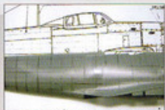
▲前面図を1/32に拡大コピーし、リベットライン、パネルラインを書き込む。
