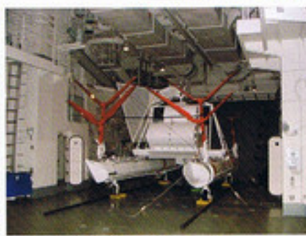
▲「ぶんご」艦尾庫内にあった航空機格納庫MK105。ヘリコプターで引いて揚海する。「ぶんご」では同機をヘリ格納庫にも搭載していて、クレーンで海面に下ろしたそうだ。
