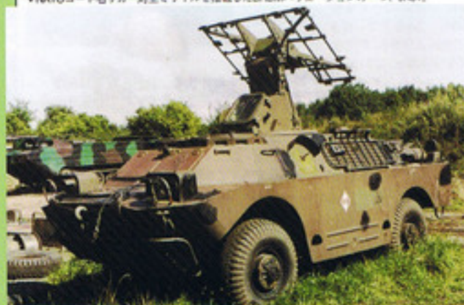
▲この変わった車両はPT91水陸両用兵員輸送車。 ▼NATOコード名サガー対空ミサイルを搭載したBROMバリエーションの一つ、9K31。
