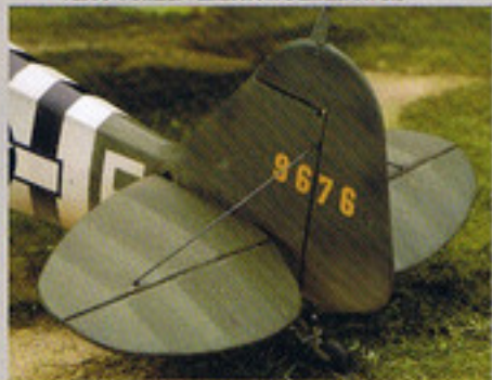
▲パイパーカブのシンプルな簡易装置。 ▼尾翼水平安定版の固定支持索も金属線で作製。
