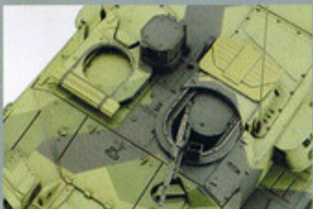
▲トップアタック対策のために砲塔上面の乗員スペース部分に追加装甲が装着されている。
