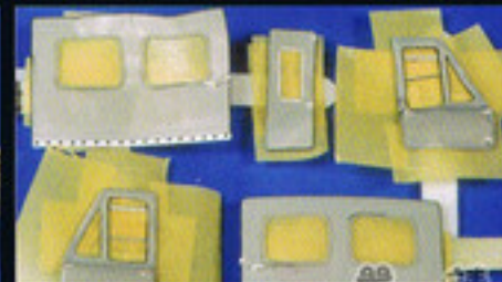
▼塗装前に窓と内部をしっかりとマスキングしておく。
