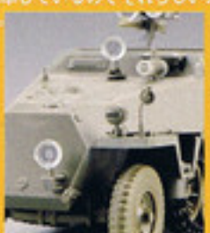
▲車体前面とMG42機銃型に装着された赤外線暗視装置&ライト。
