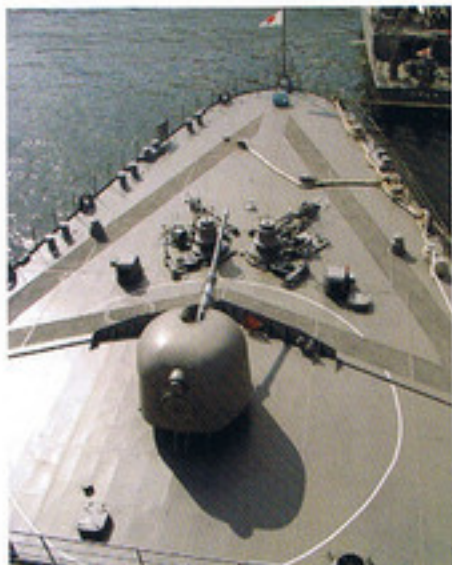
▲「ぶんご」前甲板 70mm砲装備。他に白漆やざら土を入れた歩道ラインが「うらが」と異なる。 ▼「うらが」煙突。前に防熱材が2箇所かれているのが解るだろうか？
