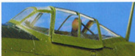
▲前期の増加試作機に見られる簡易装甲板によるヘッドレストへ変更。 ▼四角い開閉き込みリンクカバーを設置。飛前から流用した懸吊索を胴体中央にセット。
