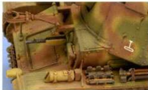
▲CVMの留め具はアペールのエッチングパーツなどに交換。
