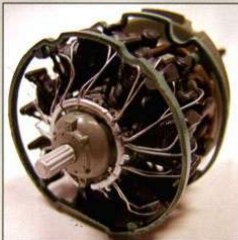
▲キットの見せ場のひとつ、見事に再現された栄一型発動機。プラグコードのみを追加工作。
