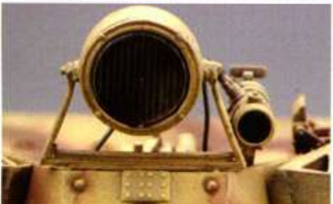
▲操縦手用FG1250赤外線暗視スコープは後部にプリズム式のアタッチメントを付け、操縦部を車内に取り入れている。 ▼防盾上部に取り付けられたZG1221アクティブ式夜間暗視システム。ZG1221は36cm径赤外線投射ライトとFG1250赤外線暗視スコープで構成されている。
