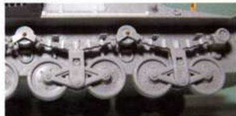
▲主砲防盾はキットのパーツを使用。防盾内側の周囲を削り肉厚を薄くすると印象が良くなる。 ▼板バネに付くパーツ2はプラバンの細切りに変更。上部転輪はボギー部と誘導輪を接着した後にバランスを見ながら接合するとよい。
