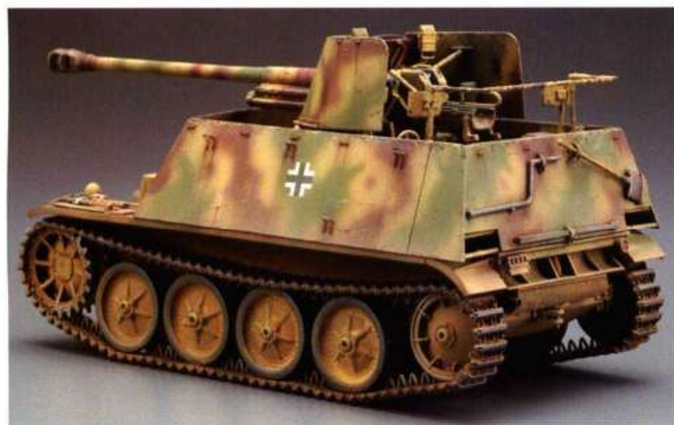
▲車体上部のタイダウン、フック、足かけなどを追加。 ▼車体後部はキットの装甲板で覆ったタイプの例。真鍮メッシュで囲んだタイプも造られている。
