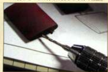
▲少ないパネルラインを彫り直し。 ▼舵などの取り付けは真ちゅう棒で補強。
