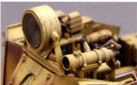
▲操縦手用FG1250赤外線暗視スコープは後部にプリズム式のアタッチメントを付け、操縦部を車内に取り入れている。 ▼防盾上部に取り付けられたZG1221アクティブ式夜間暗視システム。ZG1221は36cm径赤外線投射ライトとFG1250赤外線暗視スコープで構成されている。
