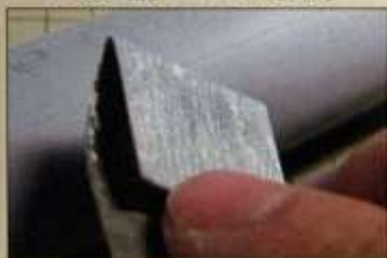
▲デカキットは中性洗剤でゴシゴシ洗う。 ▼#800~耐水ペーパーで研ぎ出し。
