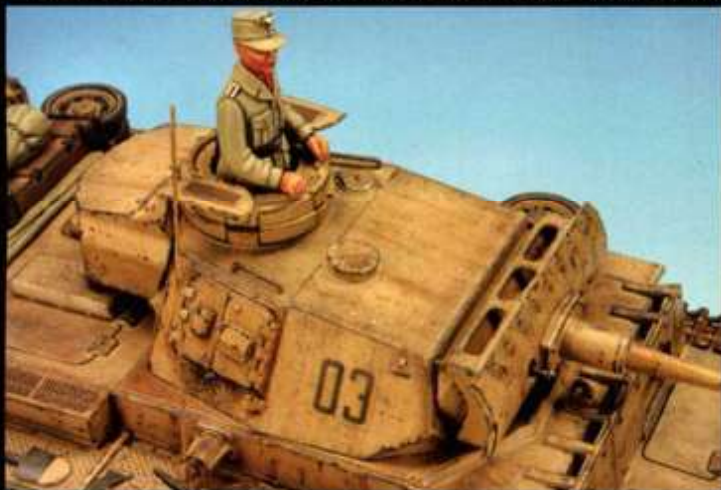
▼砲塔上面両側に付く取っ手は鋼線に変更。防盾の増加装甲板左右側面に小さな穴を開いた。
