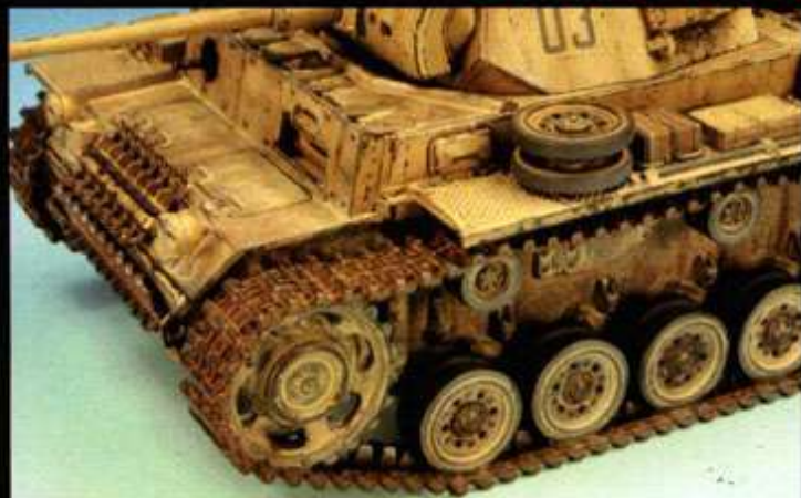
▲フェンダーの一部を取り外し、使い込まれた感じを表現。 ▼工具留め具のU字形のクランプは伸ばしランナーで作製。
