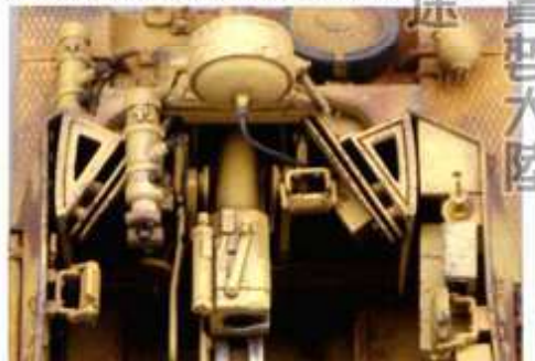
▼防盾右内側にはZG1221の操作ボックスが追加されている。
