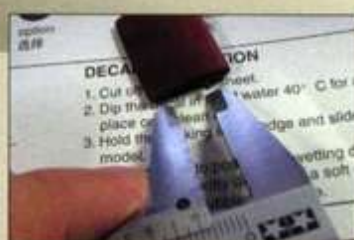
▲ノギスで計り、ピンバイスで穴開け。 ▼潜望鏡マストの迷彩はデカールが付属。
