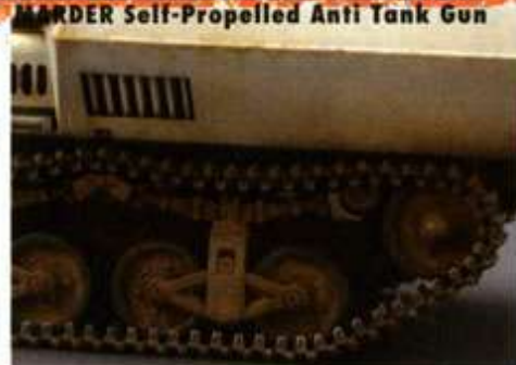
▲履帯はフリウルのメタル製造結式「Lorraine」(品番ATL-59)に交換。 ▼車体前面装甲板やディファレンシャルカバー周囲にリベットを追加。
