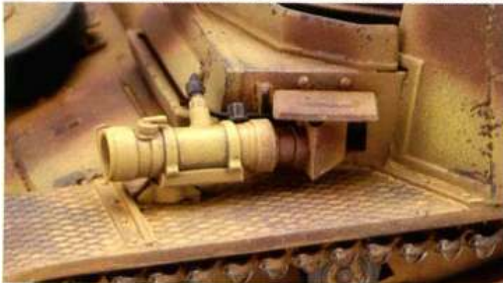
▲操縦手用FG1250赤外線暗視スコープは後部にプリズム式のアタッチメントを付け、操縦部を車内に取り入れている。 ▼防盾上部に取り付けられたZG1221アクティブ式夜間暗視システム。ZG1221は36cm径赤外線投射ライトとFG1250赤外線暗視スコープで構成されている。
