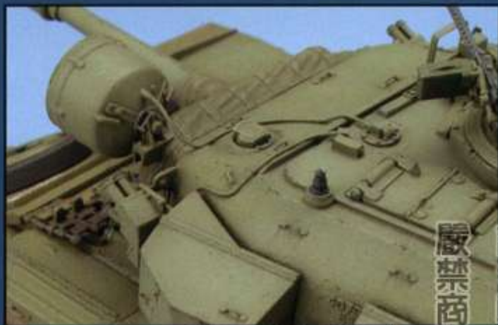
▲防盾左上に装備された大型ライトは、IRサーチライトタイプ。 ▼装填手ハッチは後期砲塔タイプ。Mk.3改修タイプのMk.5では、この装填手ハッチの形状と周囲のライトが異なっている。
