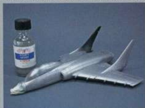
▲アルクラッドIIのALC101アルミニウムを基本色として使用。薄く3回塗りで仕上げるが、1回ごとに表面に定着していない粒子を取り去り、オレンジの皮のようなでこぼこを防ぐ。
