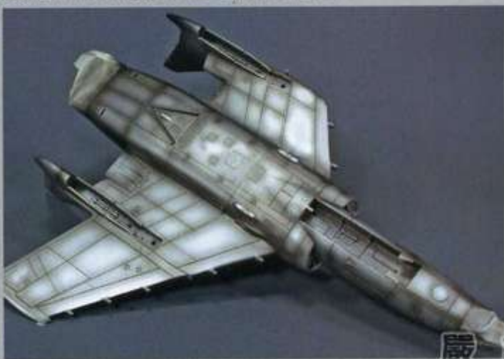
▲アルクラッドIIのALC101アルミニウムを基本色として使用。薄く3回塗りで仕上げるが、1回ごとに表面に定着していない粒子を取り去り、オレンジの皮のようなでこぼこを防ぐ。
