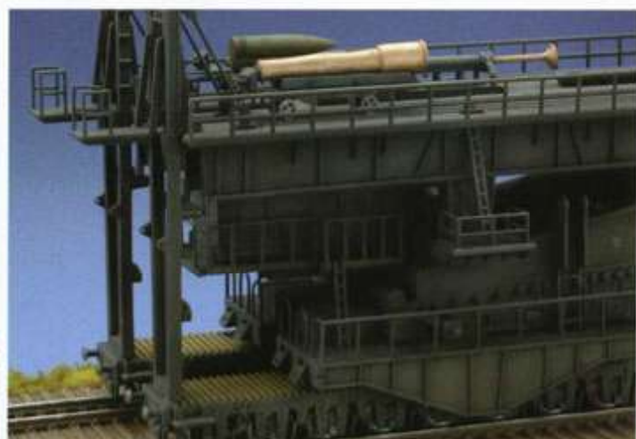
▲1/144とはいえ、これだけ大きくなると、かなり細かくパーツ化されており、むしろ1/35AFVキットより細かなパーツ分割である。 ▼車台後方の弾薬運搬部分。弾頭と装薬筒それぞれの移動レールが左右に配されている。
