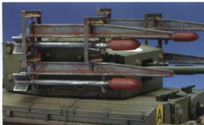
▲実車は、RP-3とランチャーレールはタイフーン戦闘機やモスキート用のものをそのまま使用している。 ▼ランチャーレールを固定するブラケットは、金属のアンクル材等を組んだ応急的な造りである。▼車体の基本的な部分は、キットをそのままに組んでいる。
