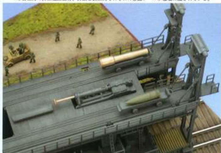
▼車台後方には弾薬、筒の揚弾装置（リフト）が設置されている。
