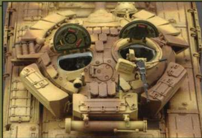
◀▲砲塔部のリアクティブアーマーは前型T-72Bに装着されていた「コンタクト」の改良型「コンタクト5」で、HEAT弾に対する防弾性が向上している。
