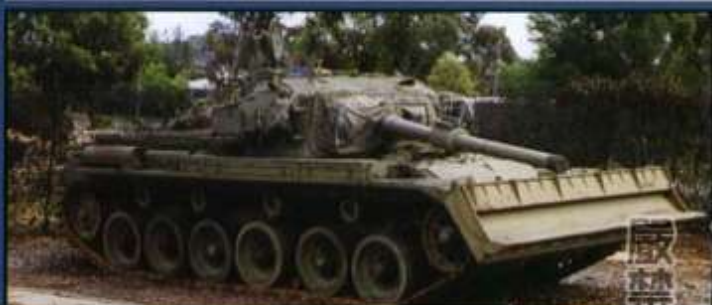
▼異なるタイプのドーザーブレード装備車。車体前面にトラベリングブロックが追加されている。予備転輪取り付け基部の位置が左右で異なっているが、このタイプも実車写真で多く確認できる。
