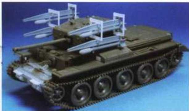
◀▶ グレーのパーツは他 キットより流用。白い部 分はプラバンで自作した 部分。
