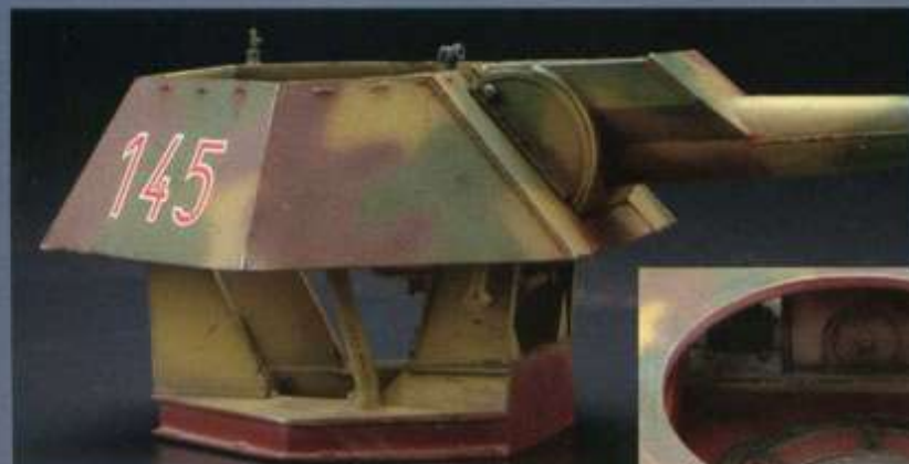
▲砲塔バスケットの支持架と床板が丈夫な構造になっているのは、砲塔ごと車体から取り出し地上に設置できるようにしているためと思われる。
