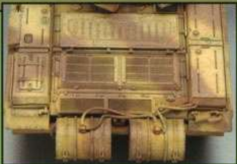
▲機関室部分のレイアウトはT-72BMになっても変更は施されていない。
