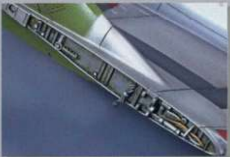
▲着艦フックはツヤありホワイトで全体を塗装し、0.4mmテープでマスキングして黒いストライプを塗る。最後にメタリックな色を混ぜたツヤありクリアで仕上げる。
