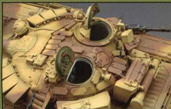
▲T-72B以降、リアクティブアーマーはさまざまな装着方法が見られたが、BMにおいて確立したようで、T-90もほぼ同じレイアウトになっている。
