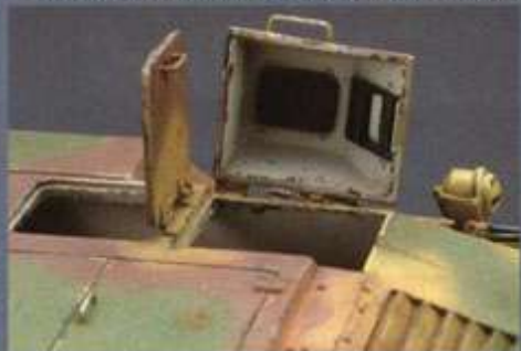
▼操縦手カバー内側には保護パッドと視察孔のモールドが施されている。
