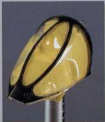
▲陸揚装置の塗装。ALC105ポリッシュドメタルで塗装した脚柱類は、ブルーとイエローの透明色でウォッシングする。スミ入れは黒と茶の油彩で行う。 ▼クリアパーツは低い回転数に落としたリョーターでゆっくりと磨く。前部キャンビーはクリアテックスのブラックで筆塗りしたあと、透明部分をマスキング。
