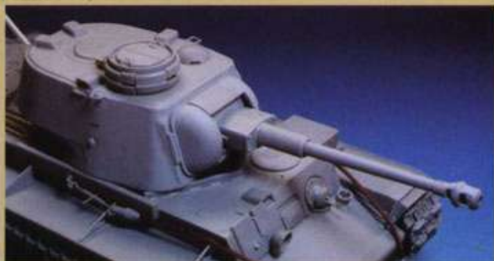
▼キットには車体後部のラックのパーツが入っていないので、プラバンで自作。機関室と車体後部の吸排気口のメッシュはアベールのエッチングパーツに交換した。
