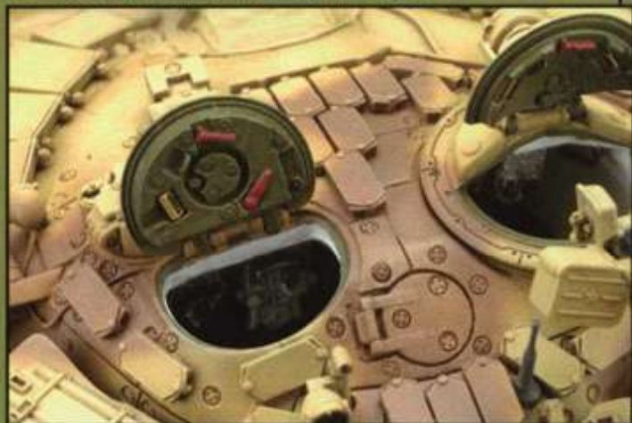
▲T-72B以降、リアクティブアーマーはさまざまな装着方法が見られたが、BMにおいて確立したようで、T-90もほぼ同じレイアウトになっている。
