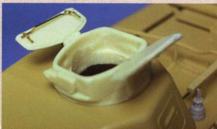
▲ドイツ軍仕様のキューポラはエアデール・キャストینگ1/35 ソミュア S35 付属のレジ ン製パーツを使用。▼キットには牽引用の金属チェーンまでセットされている。
