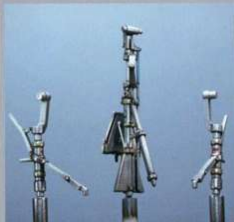
▲陸揚装置の塗装。ALC105ポリッシュドメタルで塗装した脚柱類は、ブルーとイエローの透明色でウォッシングする。スミ入れは黒と茶の油彩で行う。 ▼クリアパーツは低い回転数に落としたリョーターでゆっくりと磨く。前部キャンビーはクリアテックスのブラックで筆塗りしたあと、透明部分をマスキング。
