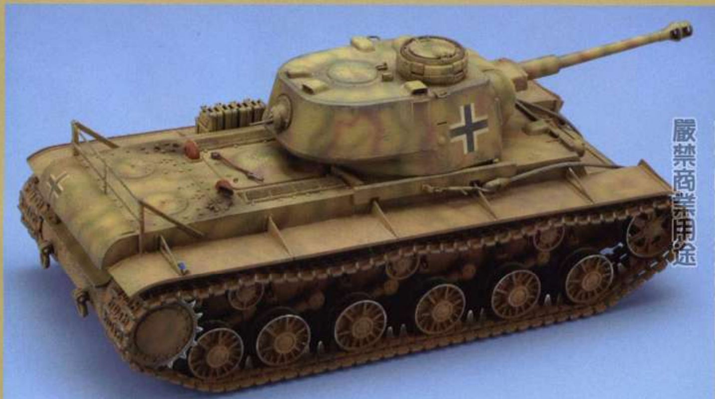
▲何事にも拘るドイツ人らしく、車長席のある天板をわざわざくり抜いてキューボラを設置するという結構手間が掛かった改修を行っている。
