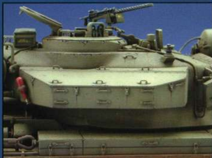
▲センチュリオンのデザイン上の特徴ともいえる砲塔側面の大型道具箱。 ▼操縦手ハッチ周辺。
