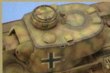
▲何事にも拘るドイツ人らしく、車長席のある天板をわざわざくり抜いてキューボラを設置するという結構手間が掛かった改修を行っている。
