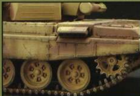
▲T-72の転輪は、初期生産車は8本リブ・タイプ（タミヤのキット）だったが、間もなく6本リブ・タイプに変更された。
