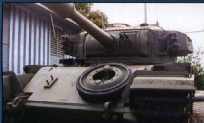
▲Mk.5/1を前方から見る。車体前面には2インチ厚の増加装甲板を装着。防盾の7.62mm同軸機銃の右横には並列して測距用の12.7mm機銃が設置されている。2挺の銃身（放熱筒）の太さと銃口の大きさの違いに注目。▼機関部上に大量のジェリカンを装備。
