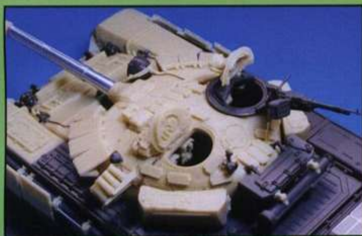
▼エンジンのメッシュと予備燃料タンクの配管類はタミヤのキットに付属している。車体後部のワイヤーロープはカラヤの「Tow Cables」(品番TCR07)を使用。
