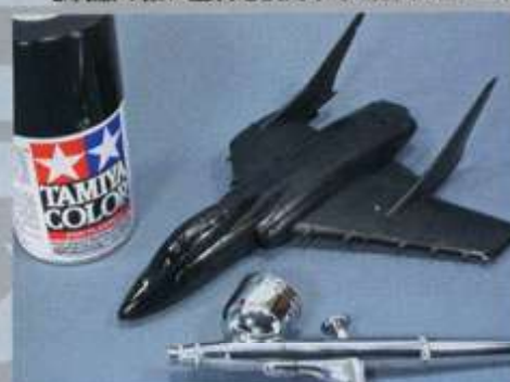
▲アルクラッドIIをペイントする前に、下地のプライマーとしてタミヤのTS-14グロスブラックを直接スプレー。もしくはエアブラシで塗装する。この色は機首のレドームと同じ色なので、次の作業の前にマスキングしておく。
