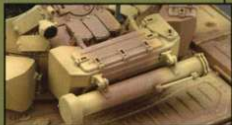
▼砲塔後面には工具箱とシュノーケルパイプを設置。
