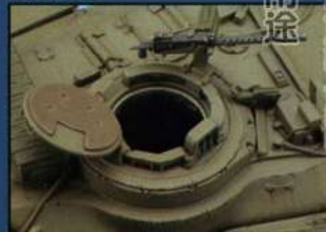
▲防盾左上に装備された大型ライトは、IRサーチライトタイプ。 ▼装填手ハッチは後期砲塔タイプ。Mk.3改修タイプのMk.5では、この装填手ハッチの形状と周囲のライトが異なっている。
