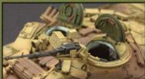
▼車長用キューボラの12.7mmNSVT機銃クチュースは車内よりリモコン操作可能。
