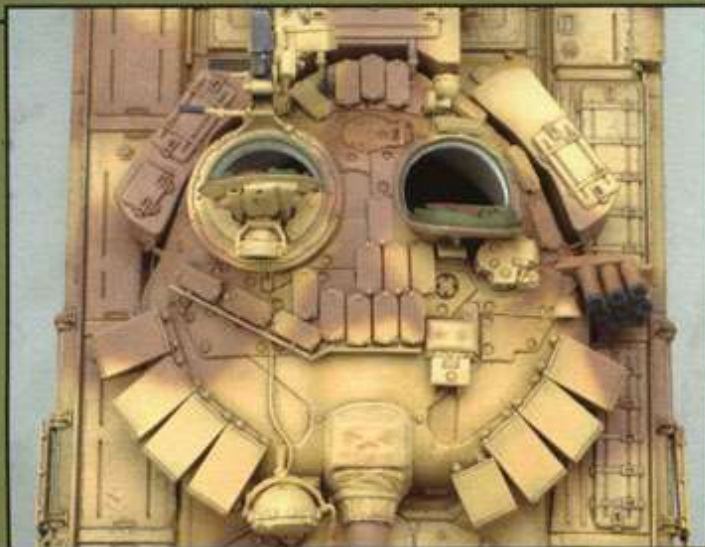
◀▲砲塔部のリアクティブアーマーは前型T-72Bに装着されていた「コンタクト」の改良型「コンタクト5」で、HEAT弾に対する防弾性が向上している。
