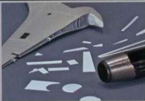
▲方向舵のジョイントはパンチ&ダイセットを使用して製作。
