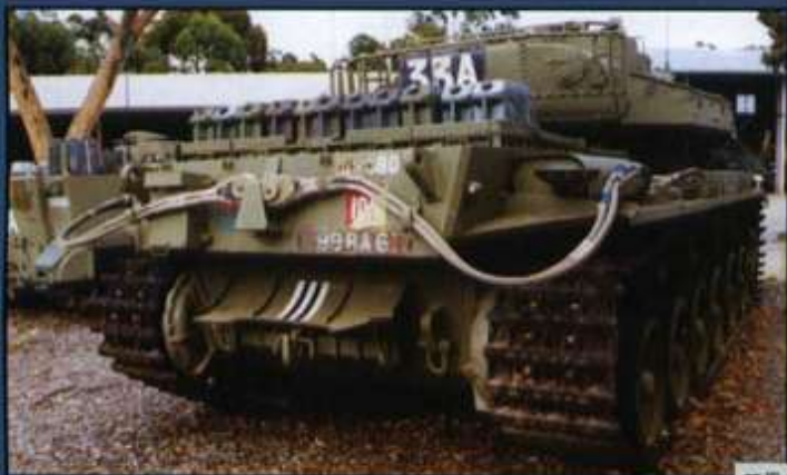
▲Mk.5/1を前方から見る。車体前面には2インチ厚の増加装甲板を装着。防盾の7.62mm同軸機銃の右横には並列して測距用の12.7mm機銃が設置されている。2挺の銃身（放熱筒）の太さと銃口の大きさの違いに注目。▼機関部上に大量のジェリカンを装備。
