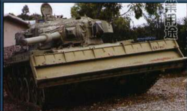
▼異なるタイプのドーザーブレード装備車。車体前面にトラベリングブロックが追加されている。予備転輪取り付け基部の位置が左右で異なっているが、このタイプも実車写真で多く確認できる。
