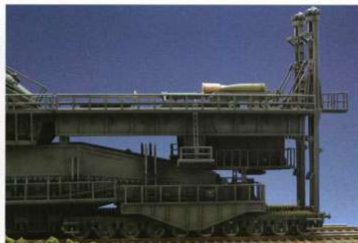
▲1/144とはいえ、これだけ大きくなると、かなり細かくパーツ化されており、むしろ1/35AFVキットより細かなパーツ分割である。 ▼車台後方の弾薬運搬部分。弾頭と装薬筒それぞれの移動レールが左右に配されている。
