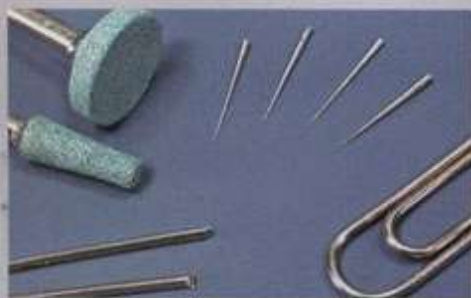
▲エアブレーキの円錐状の補強材はクリップを削って自作。内面はレッド、外面はグリーンプライマーで塗装する。
