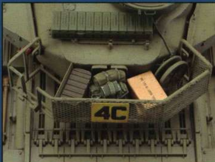
▲砲塔後部の大型バスケットの左側（メッシュがない部分）はサーチライトの収納部。 ▼車体後部左右マフラー周辺。
