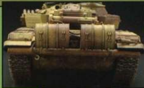
▲履帯はウェット・タイプピン式のHMSH。現在ではT-55、T-62もほとんどこの履帯に変更されている。
