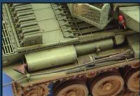
▲砲塔後部の大型バスケットの左側（メッシュがない部分）はサーチライトの収納部。 ▼車体後部左右マフラー周辺。
