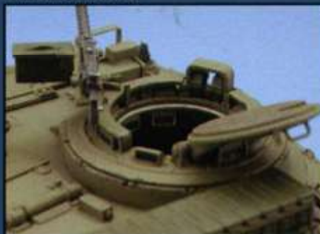
▲防盾左側の同軸機銃の右横には12.7mm測距用機銃の銃身が付き出している。
