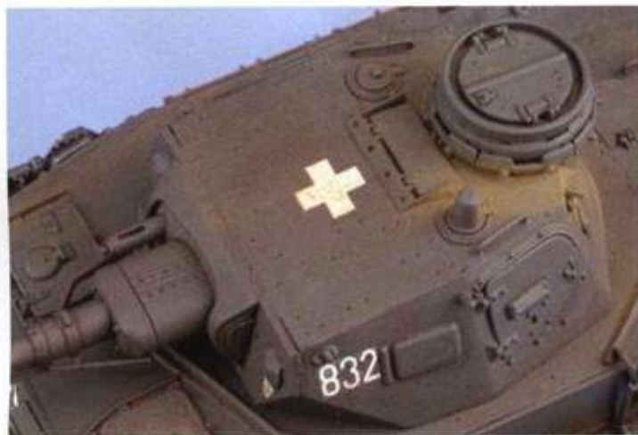
▼B型とC型との相違点は防盾の開口部の上下幅が狭くなったことと同軸機銃に装甲スリーブが付いていること。
