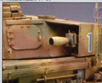
▲砲塔前面中央にMK103 3cm機関砲、左右に7.5cm FlK 43無反動砲を各1門搭載。 ▼砲塔前部の左右両側に防弾板で覆ったカバーを新設し、そこに7.5cm無反動砲を固定している。
