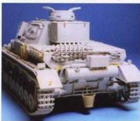
▲車体下部側面の20mm増加装甲板も再現されている。
