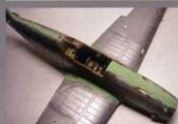
▲胴体、主翼の各接合部は瞬間硬化剤にて押さえ込み作戦。
