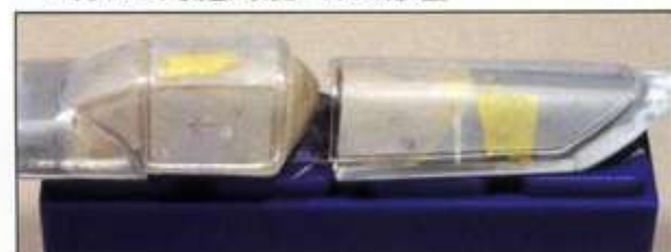
▲プロペラはBH109Eのものを短縮して使用。 ▼キットパーツを原型にしたヒートプレス用の型。
