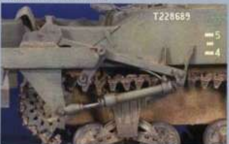
▲車体前方に装着された地雷除去装置“フレイル”。 ▼フレイルのアームは左右で構造が異なる。回転ドラムへの動力伝達は右アームで行われる。
