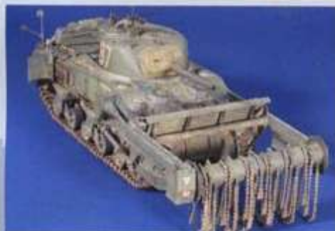
▲車体前方に装着された地雷除去装置“フレイル”。 ▼フレイルのアームは左右で構造が異なる。回転ドラムへの動力伝達は右アームで行われる。
