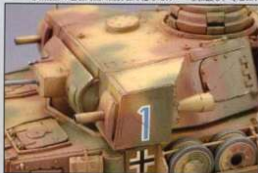
▲砲塔前面中央にMK103 3cm機関砲、左右に7.5cm FlK 43無反動砲を各1門搭載。 ▼砲塔前部の左右両側に防弾板で覆ったカバーを新設し、そこに7.5cm無反動砲を固定している。
