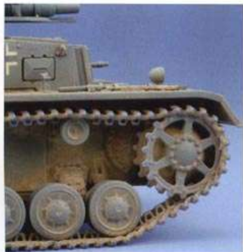
▲駆動輪はE型から導入された新型タイプを再現。
