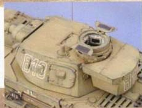
▲B型からD型への生産移行にあたって グラーブの形が変更されている。
