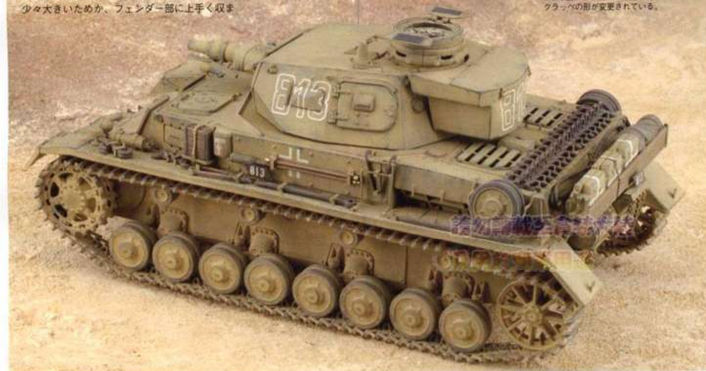
▲B型からD型への生産移行にあたって グラーブの形が変更されている。
