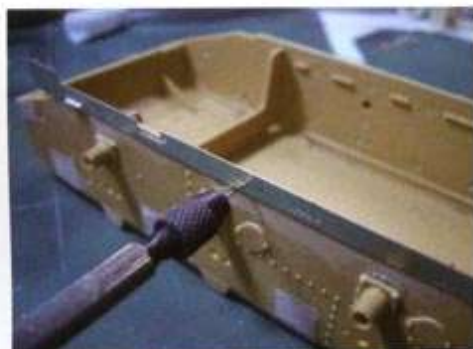
▲アペールのフェンダー取り付け用エッチング板にガイド用の穴を開ける。 ▼エッチング・フェンダーはこのようにしっかり固定。
