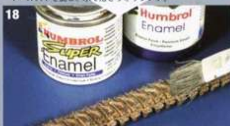
▲後にハンプロール・エナメルのシルバーとブラックを混ぜた色でドライブラシを行う。
