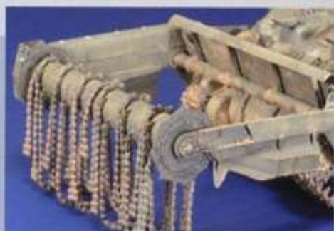
▲車体前方に装着された地雷除去装置“フレイル”。 ▼フレイルのアームは左右で構造が異なる。回転ドラムへの動力伝達は右アームで行われる。
