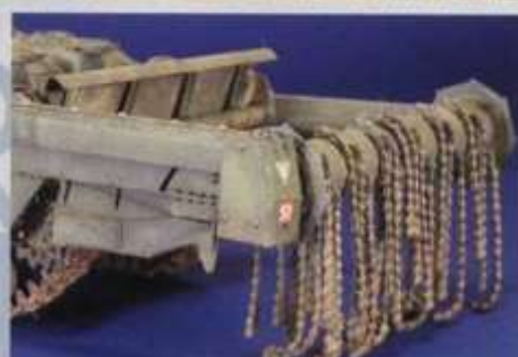
▲車体前方に装着された地雷除去装置“フレイル”。 ▼フレイルのアームは左右で構造が異なる。回転ドラムへの動力伝達は右アームで行われる。
