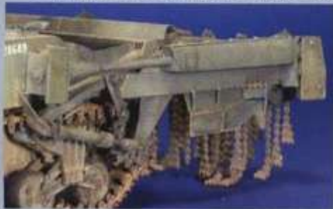
▲車体前方に装着された地雷除去装置“フレイル”。 ▼フレイルのアームは左右で構造が異なる。回転ドラムへの動力伝達は右アームで行われる。
