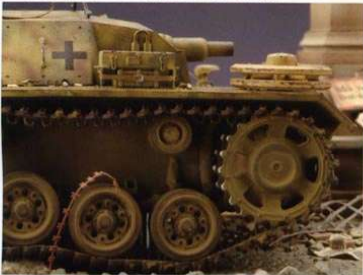
▼履帯、起動輪はモデルカステンに交換。サスペンションは可動式だ。
