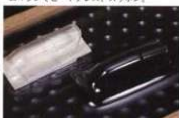
▼キャノピーは全型の傷みが劇辛で傷だらけなのですが、磨く根性も無いのでパーツを原型にし、0.3mm塩ビシートをバキュームマシンでヒートプレス、スッポン。
