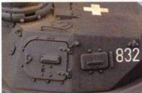
▲キューボラ、ハッチ、主砲基部、ピストルポート、クラッペなど初の量産型A型と比べBC型では細部がかなり変更されている。
