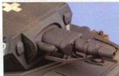
▼B型とC型との相違点は防盾の開口部の上下幅が狭くなったことと同軸機銃に装甲スリーブが付いていること。
