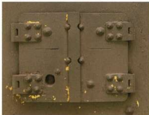
▲砲塔後部右側に設けられた小ハッチ。 ▼砲塔後部の機銃マウント。
