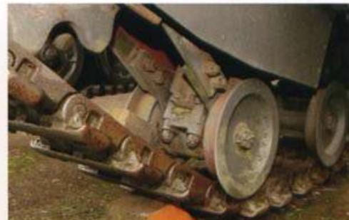
▲第1転輪。写真は内側から見たところ。 ▼上部補助転輪。写真は車体左側。
