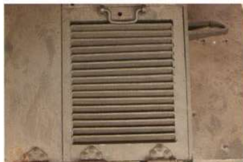
▲機関室後部の排気グリル。写真は右側。
