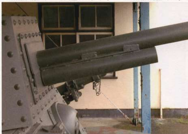
▲▶八九式は18口径の九〇式57mm砲を搭載していた。展示車の主砲と砲基部はダミーである。
