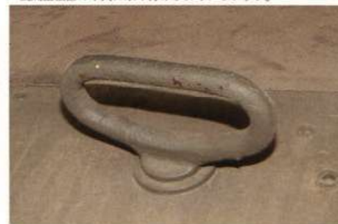
▲車体上部右側の張り出し部分後部。 ▼機関室後部の中央に取り付けられているフック。
