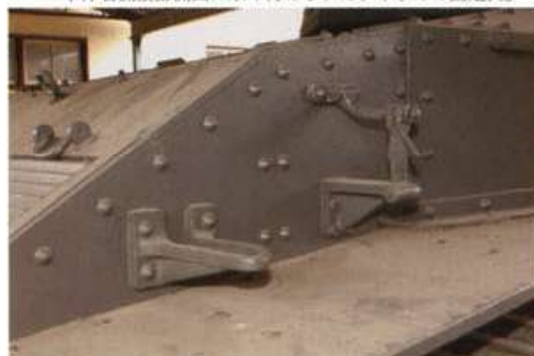
▲車体側面の張り出し後部に設置された注入口。 ▼車体右側後部側面に取り付けられたジャッキの固定具。
