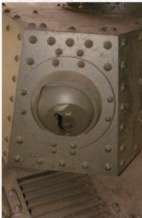
▲砲塔後部右側に設けられた小ハッチ。 ▼砲塔後部の機銃マウント。
