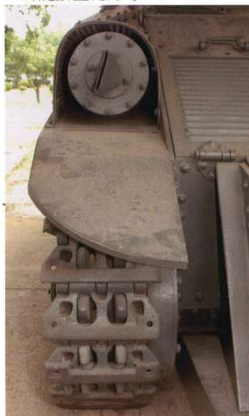
▼車体左側の後部フェンダー。
