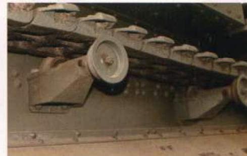
▲第1転輪。写真は内側から見たところ。 ▼上部補助転輪。写真は車体左側。
