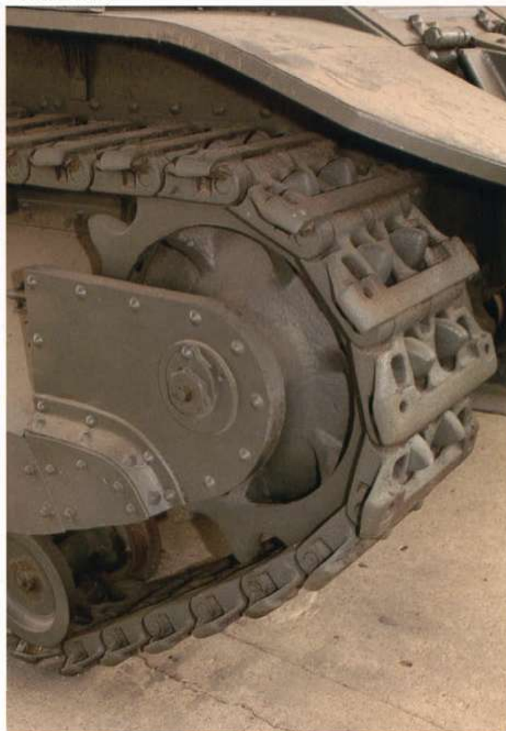
◀車体右側下部のサスペンションカバー。 ▼車体後部の誘導輪。
