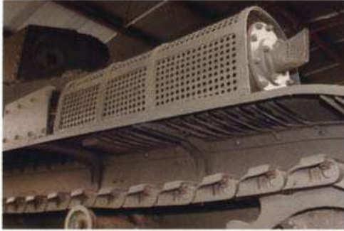
▲マフラー下部のフェンダーには放熱用のスリットが設けられている。▲排気管カバー。写真は車体左側。
