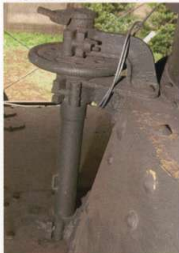
▼砲塔右側面に設置された機銃架。
