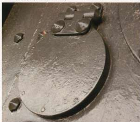
▲車体前面の機銃マウントの横に配置された小ハッチ。
