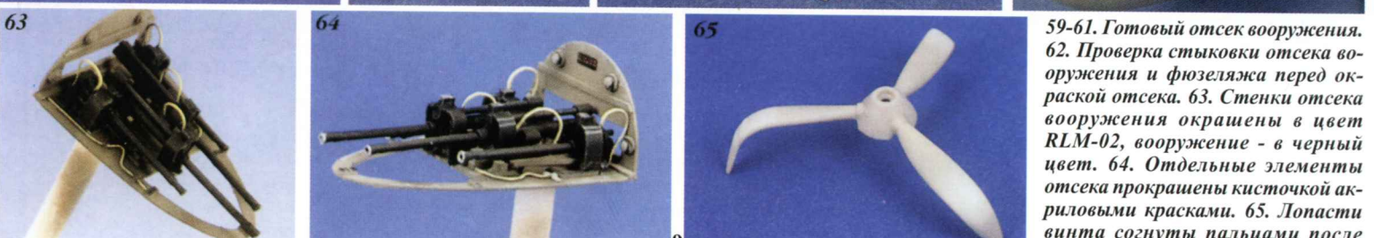
59-61. Готовый отсек вооружения. 62. Проверка стыковки отсека вооружения и фюзеляжа перед окраской отсека. 63. Стенки отсека вооружения окрашены в цвет RLM-02, вооружение - в черный цвет. 64. Отдельные элементы отсека покрашены кисточкой акриловыми красками. 65. Лопасти винта согнуты пальцами после предварительного нагрева.
