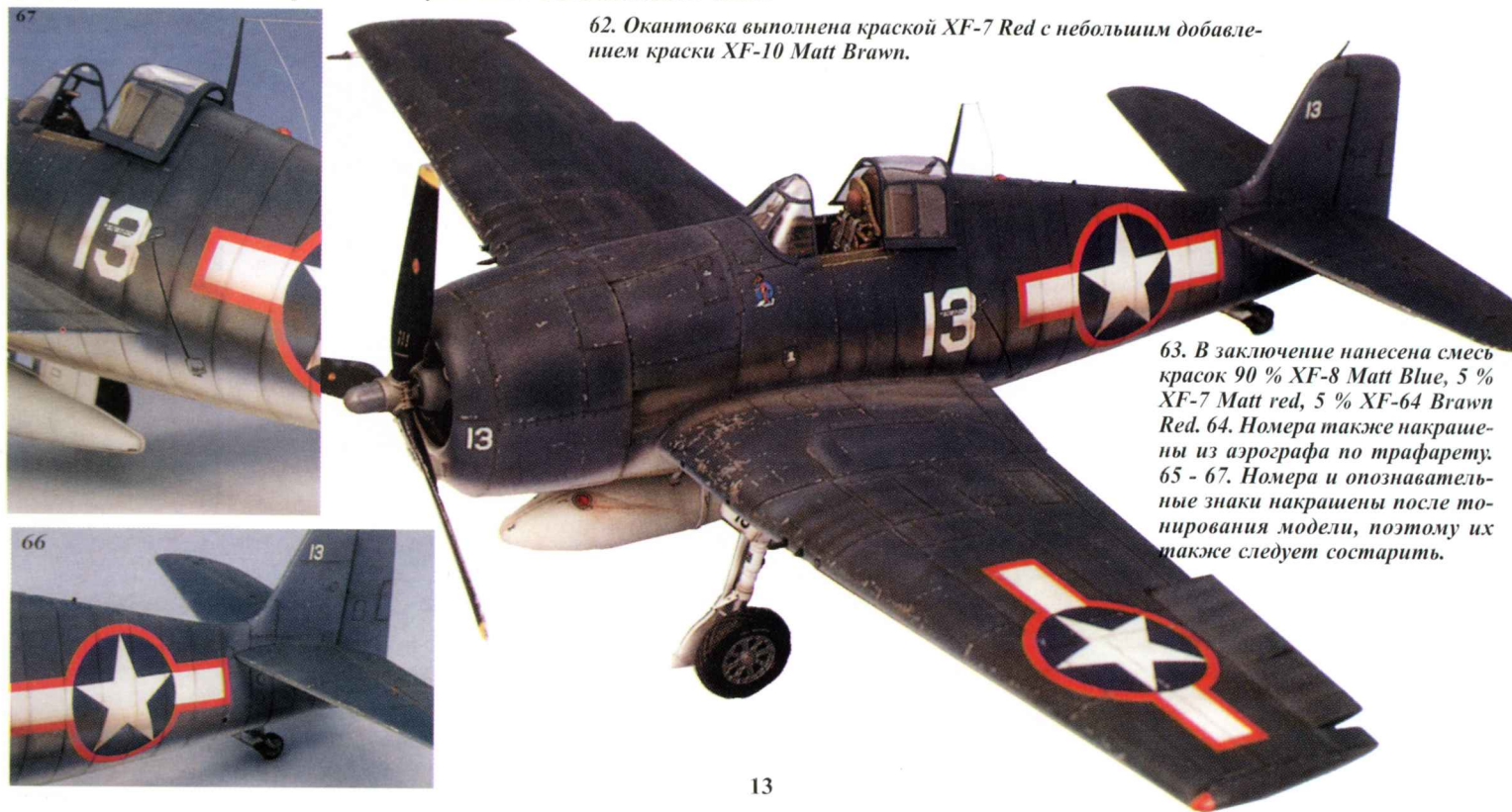
58. Декаль, инструменты и материалы для нанесения декалей. 59. Декаль в целом неплох, но опознавательные знаки лучше задуть из аэрографа по трафаретам ибо есть риск просвечивания окраски модели сквозь белые участки декали. 60. Нанесен слой белой краски из аэрографа сквозь трафарет. 61. Масками закрыты белые участки опознавательного знака. 62. Окантовка выполнена краской XF-7 Red с небольшим добавлением краски XF-10 Matt Brown. 63. В заключение нанесена смесь красок 90 % XF-8 Matt Blue, 5 % XF-7 Matt red, 5 % XF-64 Brown Red. 64. Номера также окрашены из аэрографа по трафарету. 65 - 67. Номера и опознавательные знаки окрашены после тонирования модели, поэтому их также следует состарить.
