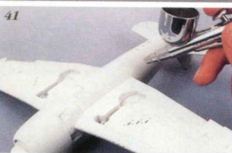
37. Окрашенный и тонированный воздушный винт. На лопасти переведены декали. 38. Двигатель окрашен в черный цвет и тонирован сухой кистью под алюминий. 39. На окрашенный и тонированный двигатель установлена электропроводка из медной проволоки. 40. Топливный бак перед окраской. 41. Нижние поверхности модели окрашены из аэрографа в белый цвет краской H-316. 42. Нанесен слой краски H-56 Intermediate Blue. 43. В последнюю очередь нанесена самая темная краска камуфляжа - NAVY Blue, H-54. 44. В профиль хорошо видны мягкие границы перехода цветов камуфляжа.
