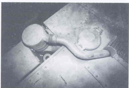
Корпус Тамии сконфигурирован как танк с дизельной силовой установкой. На снимке воздушный фильтр и воздуховод дизельного МЗ.
