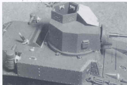
Углублены смотровые щели, сделан интерьер командирской башенки (ответные части смотровых блоков), дополнены самодельными воздушными фильтрами.
