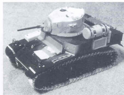
Ярко желтая маркировка модели выполнена следующим образом: башня окрашена в желтый цвет, после чего на окрашенную поверхность наклеены маски в виде маркировки, вырезанные из тамиевского модельного скотча.
