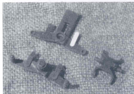
Одна из немногих доработанных деталей модели - тележка опорных катков. Здесь заново сделаны стяжки, отлитые вместе с телом тележки.
