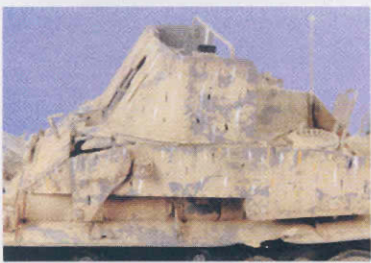
На модель случайным образом нанесены маленькие пятна масляной краски. Масляная краска размыта чистым растворителем движениями кисти сверху вниз. Результат должен быть весьма subtilным. Ходовая часть обильно присыпана пастелью. Пастель размыта водой или растворителем для эмали. Просушенная пастель отлично передает налет пыли и грязи.
