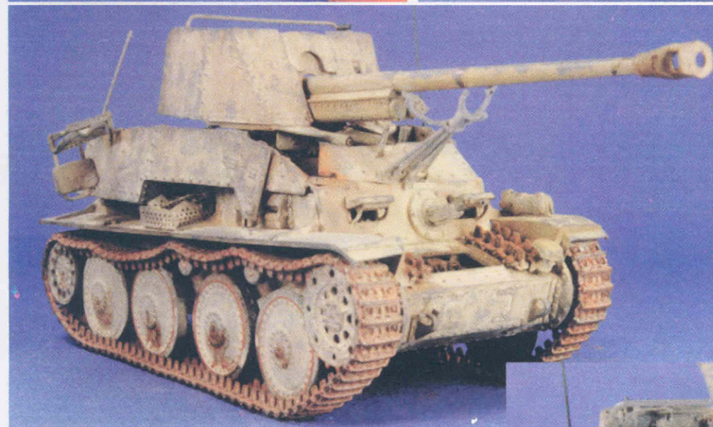
Дополнительная метализация выполнена графитовой пудрой, втертой в поверхности модели пальцами.
