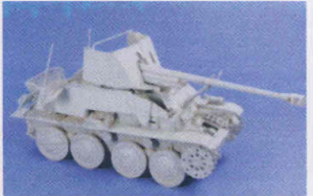
Модель покрыта грунтовкой с целью выравнивания цветовой гаммы деталей из разнородных материалов.
