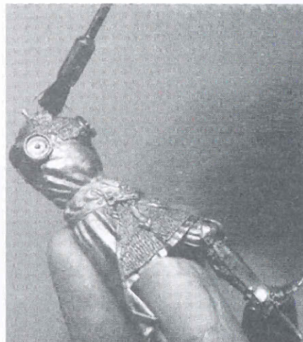
Полировка металлической фигурки проволоочной кисточкой, зажатой в патроне минидрели.
