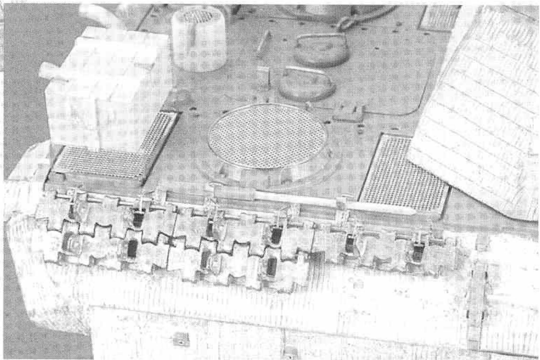
Запасные траки – металл от Friulmodel. Огнетушитель сделан из пластика и дополнен фототравленкой, инструмент собран по разным моделям. Лесенка сделана из проволоки диаметром 0,4 мм.
