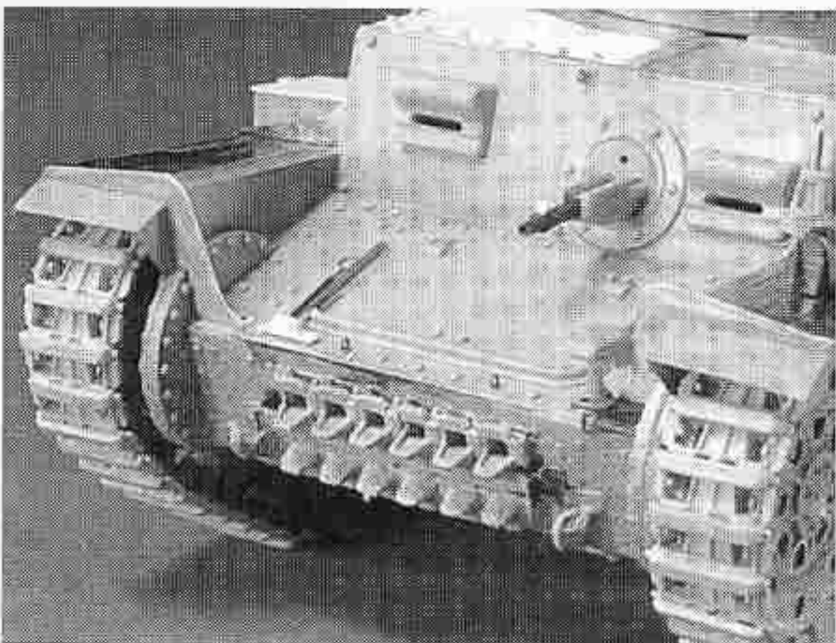
Кронштейны крепления подкрылков вырезаны из пластика толщиной 0,20 мм. Ствол пулемета взят от модели Pz.38 фирмы Итальяери. Лобовая плита надстройки корпуса - также Итальяери.
