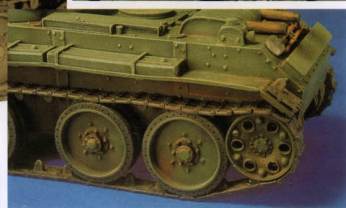
Траки гусениц покрашены в черный цвет, затем задуты из аэрографа тонким слоем краской серо-стального цвета. Тонирование выполнено в несколько приемов по методу заливки темперой желтого, красного и черного цвета. В последнюю очередь выполнено тонирование сухой кистью под полированный металл. Ржавчина покрашена смесью желтой и черной эмалей.
