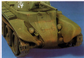
Базовый цвет окраски модели: темно-зеленый в смеси с черным. Высветление по методу сухой кисти выполнено травянисто-зеленой краской, кромки проработаны очень светлым оттенком травянисто-зеленой краски.
