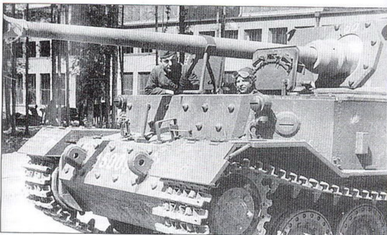
Один из «Фердинандов» (шасси № 150096), использовавшихся на заводе Нибелунгенверке для подготовки водителей. Хорошо видны траки раннего типа.
