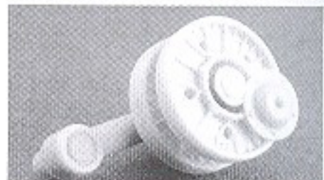
У одного из опорных катков самостоятельно изготовлены втулка и ось.
