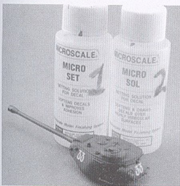
Декаль нанесена с использованием составов Микро Сет и Микро Соул.
