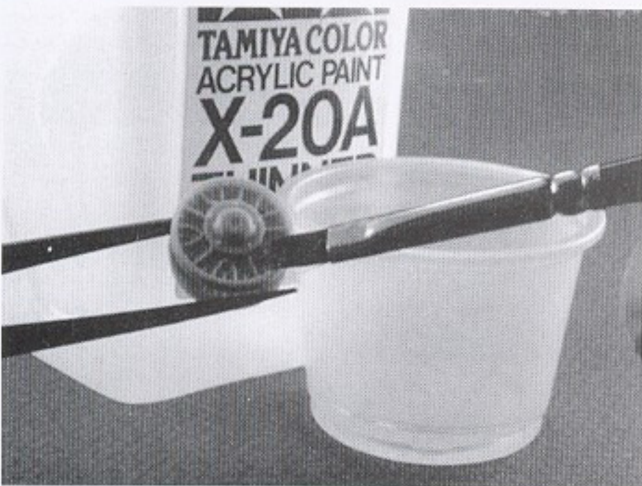
Для имитации грязи на опорных катках потребуются кисточка, растворитель для красок фирмы Тамия (можно использовать и обыкновенную водку). Опорный каток промазывается растворителем.
