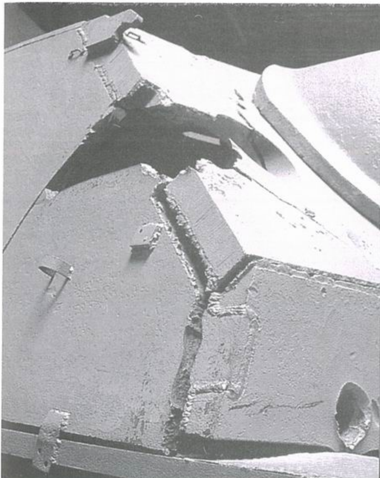
От удара снаряда броня рубки разошлась по швам.
