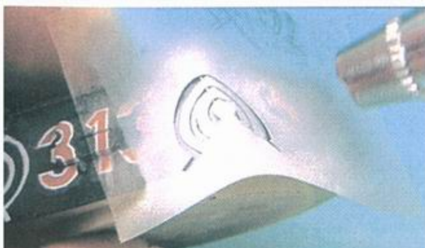
Концентрические окружности задуты из аэрографа по трафарету.
