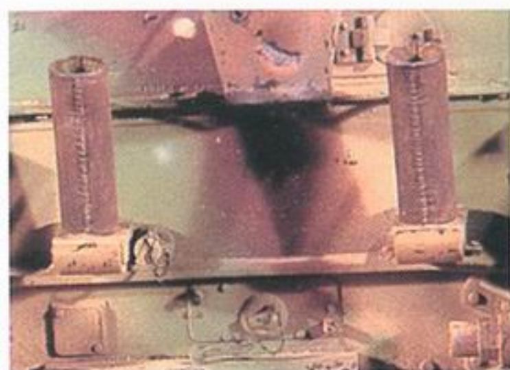
Выхлопные патрубки окрашены в матовый коричневый цвет и тонированы под ржавчину масляными красками по технологии заливки.
