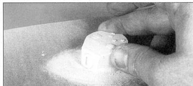
Остатки литьевого блока башни зашкуриваются на плоской поверхности.
