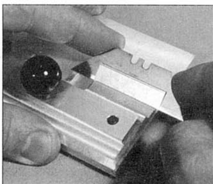
Использование приспособления Hold and Fold. Приспособление является лучшим инструментом для получения изгибов под прямым углом, при изгибании протяженных по длине деталей приспособа просто незаменима.
