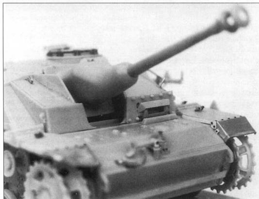
37. Вид на переднюю часть StuG III Ausf. G позднего типа. Хорошо видна литая маска орудия. Справа на рубке приварен крюк для подъема. Обратите внимание на то, что в его нижней части есть отверстие, которое на крюке модели придется просверлить самостоятельно.
