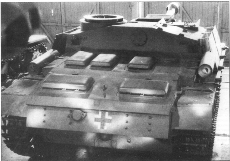
27. StuG III Ausf. G примерно середины выпуска серии. Эта машина из коллекции танкового музея в Кубинке. По бокам рубки закреплены дополнительные броневые листы.
