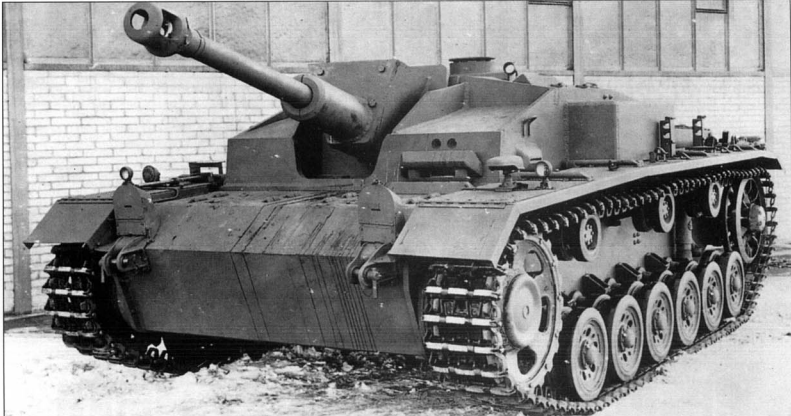
1. Sturmgeschütz III Ausf. F, сфотографированный в марте 1943 года. Штурмовая установка недавно вышла из ворот сборочного предприятия, и почти не имеет следов эксплуатации. Установка орудия 7,5см STUK 40 L/43 явилась реакцией на встречу с советскими танками Т-34 и КВ.
