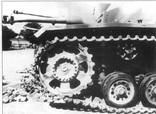
14. Отсутствие защитного колпака на ведущем колесе позволяет видеть головки болтов крепления.
