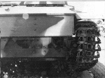
20. Вид на заднюю часть штурмового орудия. Видна правая выхлопная труба и механизм натяжения гусеницы.
