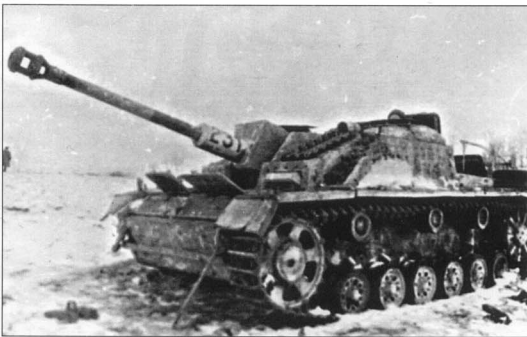
39. Подбитая советским танком StuG III Ausf. G, имеющая бортовой номер 231, декабрь 1943 года. Обратите внимание, что машина оснащена натяжным колесом от StuG III Ausf. A или Ausf.B. Разумеется, оно было заменено во время ремонта.
