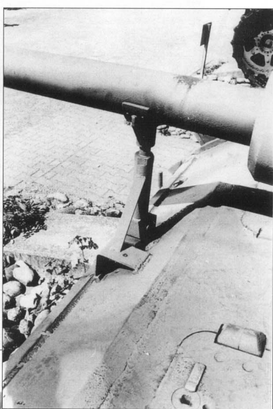
47. Механизм крепления ствола орудия по-прежнему. Боковая планка приварена в музее. На площадке, куда приварена эта планка была установлена фара «Notek». На люке доступа к трансмиссии отсутствует защитный щиток на отверстии для ключа.
