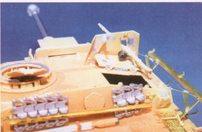
На внутренней поверхности щитка пулемета имелись дефекты литья, они заделаны шпательной и зашкурены.
