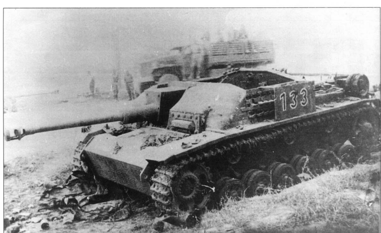
1. Sturmggeschütz III Ausf. G приблизительно середины выпуска. Крыша рубки сорвана детонировавшими боеприпасами. Машина имеет черный номер 133 с белой каемкой. Это и Sturmовое орудие имеет «циммеритное» покрытие. Лобовая часть рубки усилена слоем бетона.
