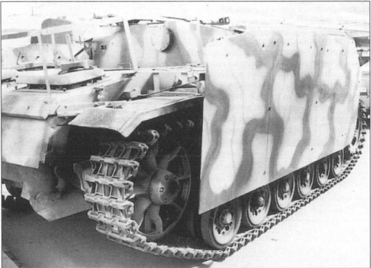
54. Бортовые экраны защищали и значительную площадь ходовой части.
