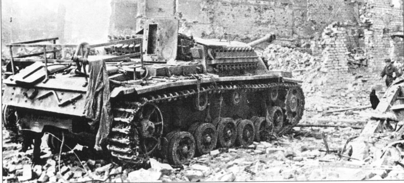
94. Подбитый StuG III Ausf. G на улице Берлина. Май 1945 года. Обратите внимание на крепления для запасных трактов на борту рубки. Сзади на корпусе закреплена заводная рукоятка. В задней части моторного отделения прикреплено ограждение для крепления дополнительного имущества.
