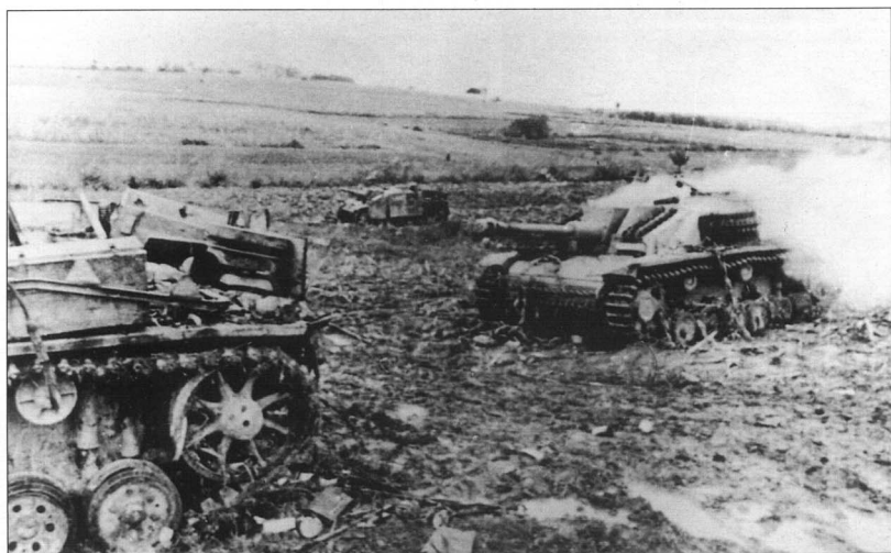
54. Три StuG III Ausf. G, подбитые советскими войсками, окрестности Будапешта, конец весны 1944 года. На переднем плане кормовая часть StuG III Ausf. G середины выпуска. За ней дымится ранний вариант этой штурмовой пушки, что видно по обрешеченным поддерживающим каткам.
