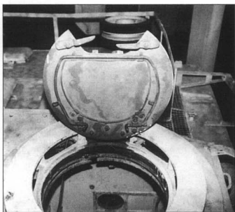
57. Фотография внутренней части люка командира StuG III Ausf. G. Недостает только кожаной защитной подушки в центре люка. Вырез сверху – для стереотрубы.
