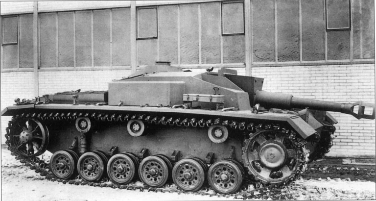
35. Вид справа на 10,5 CM Sturmhaubitze 42. Вероятно на снимке один из прототипов истребительной гаубицы, смонтированный на шасси StuG III. Кроме новой артсистемы эта машина ничем не отличается от серийной StuG III.
