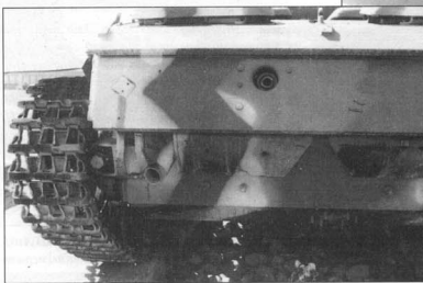
18. Крупный план задней части StuG III Ausf. G. На буксирной проушине даже сохранилась цепочка фиксации. Гусеница шириной 400 мм.
