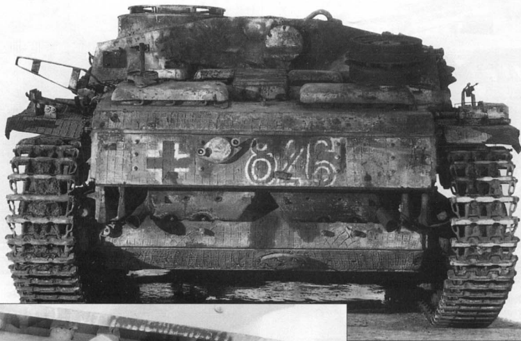
15. StuG III Ausf. G №826. Это машина – середины производственной серии. Хорошо видно «циммеритное» покрытие. Отсутствие «отражателя» под карманом выброса воздуха, позволяет хорошо рассмотреть глушители. На этом StuG III Ausf. G видны следы позжара.
