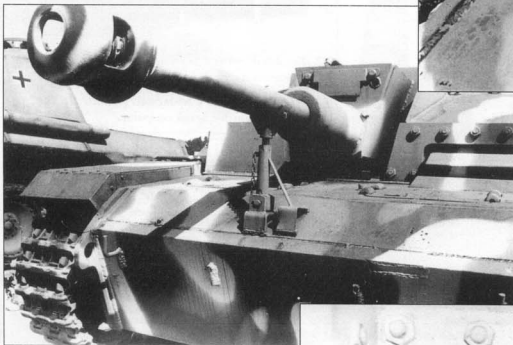
46. Передняя часть StuG III Ausf. G. Приваренный к нижнему лобовому листу крюк, вероятно, служил для навески запасных траков гусениц. Этот крюк имеет не заводское происхождение.
