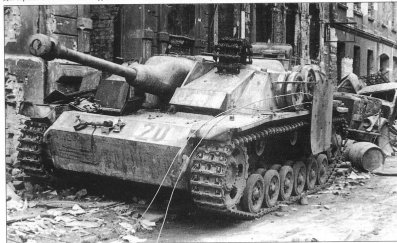
1. StuG III Ausf. G позднего выпуска. Эта фотография сделана в Кенигсберге в апреле 1945 года. На этой машине установлен дополнительный бронекзырек над смотровым прибором водителя. Сбоку рубки закреплены два запасных опорных катка. Пулеметный щит сорван и лежит на правом крыле. Фара «Notek» отсутствует. Спереди в левой проушине установлен буксирный рым.
