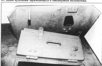
64. Поднятый в положение для стрельбы щит пулемета. Рукоятка для подъема щита отсутствует, остался только сварной шов. Хорошо видна внутренняя часть передней створки люка заряжающего.
