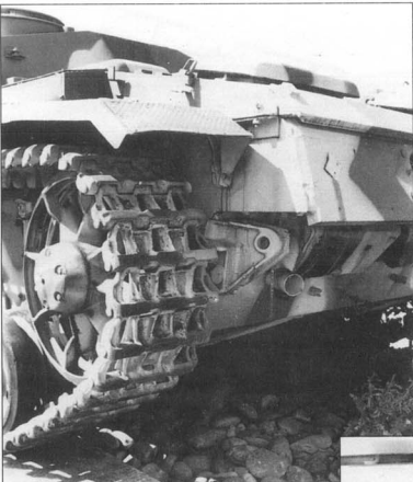
18. Крупный план задней части StuG III Ausf. G. На буксирной проушине даже сохранилась цепочка фиксации. Гусеница шириной 400 мм.
