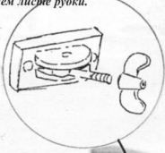
Рис. 2. Гайка крепления запасных траков гусениц на заднем листе рубки.
