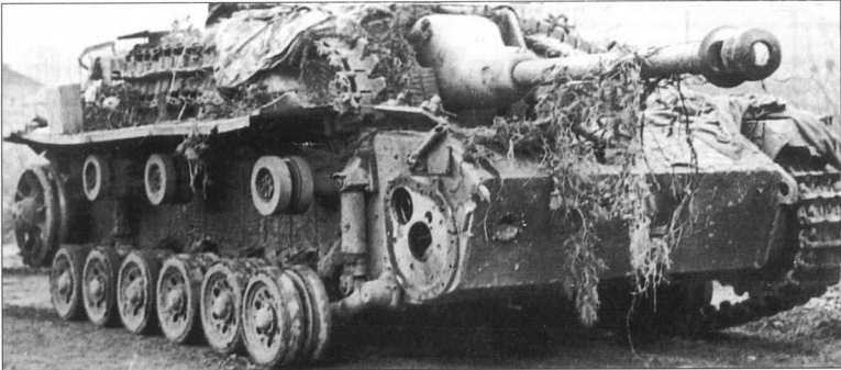
25. Захваченный поврежденный StuG III Ausf. G. Рубка полностью обвешена запасными траками. На нижнем переднем листе виден след от попадания снаряда.
