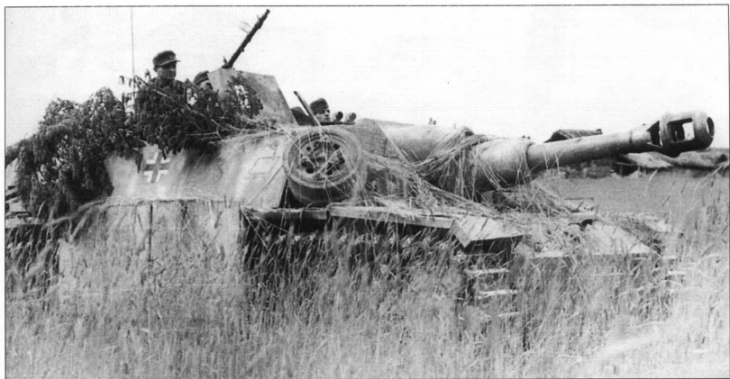
Замаскированная с помощью подручных материалов 10,5 см Sturmhaubitze 42 Ausführung G L/28. На бортах рубки установлена дополнительная броня, на которой нарисован крест и тактический знак. Пулемет на крыше рубки пригнотел для зенитной стрельбы, что видно по установленному кольцевому прицелу.
