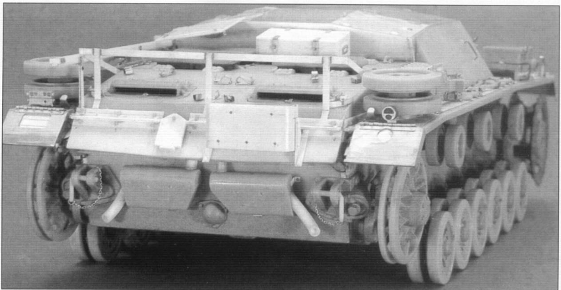
Выхлопные патрубки – пластиковые стержни диаметром 2 мм. Стержни изогнуты, а их торцы высверлены. Импровизированный багажник склеен их полосок листового пластика, имитированы сварные швы.
