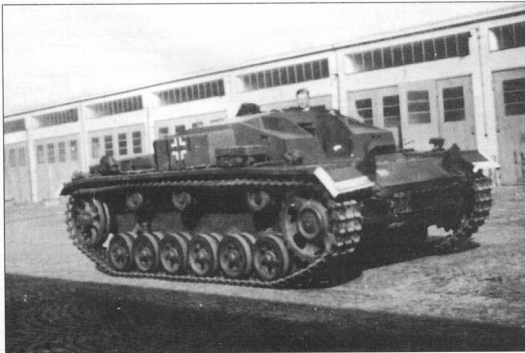
Фотография «Штурмгешуц III» без пушки. Такие самоходные пушки использовались для подготовки экипажей.
