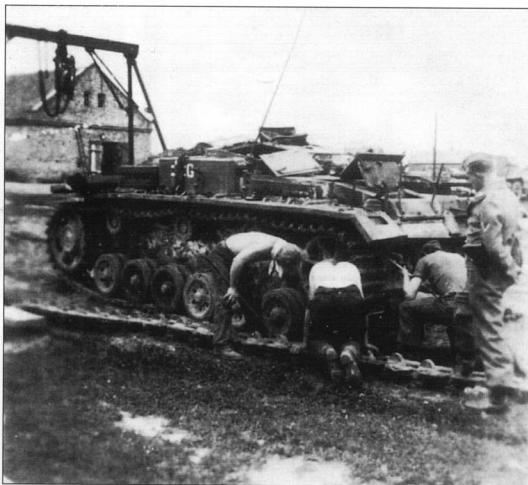
31. Ремонт ходовой части StuG III Ausf. E. На откидной части крыла видно прямоугольное отверстие. При откидывании крыла на шарнирах, в него проходил задний габаритный огонь.
