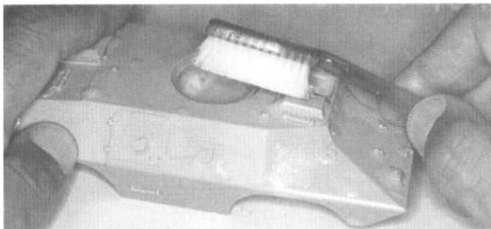
44. Эпоксидные детали тщательно очищаются старой зубной щеткой от пыли и грязи.
