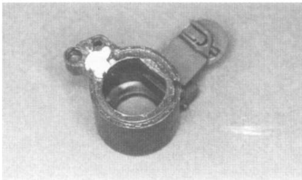
11. Утяжина заделана смесью цианакрилата и шпаклевки фирмы Тесторз.
