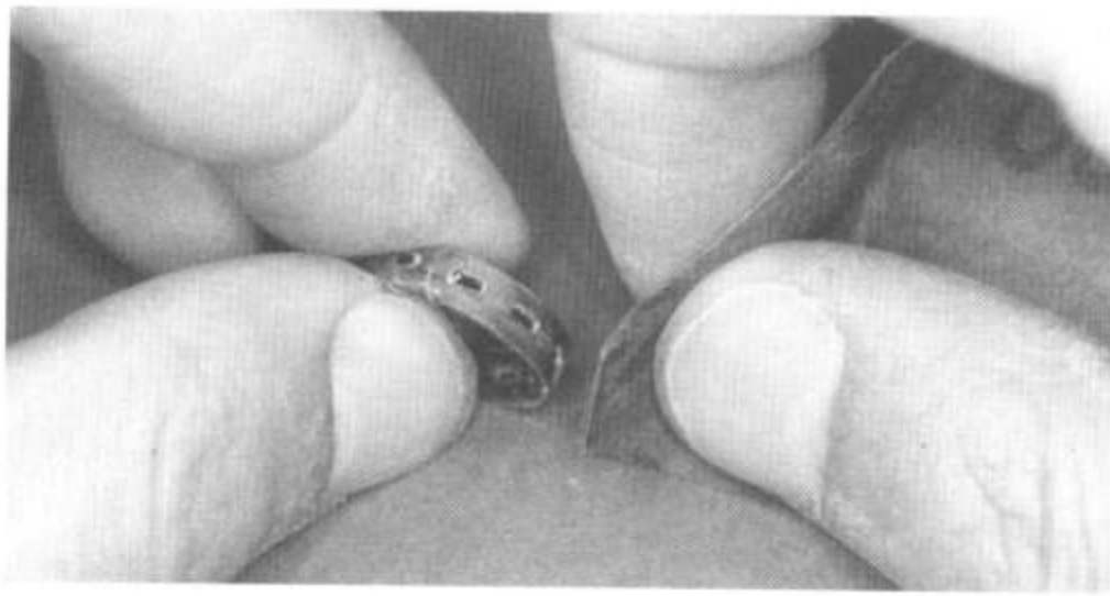
37. Цианкрилат тщательно зачищается сначала ножом, а потом наждаком.
