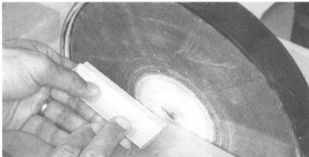
53. В отдельных случаях, когда большой прилив невозможно отпилить, приходится использовать механический наждак для стачивания лишней эпоксидки.
