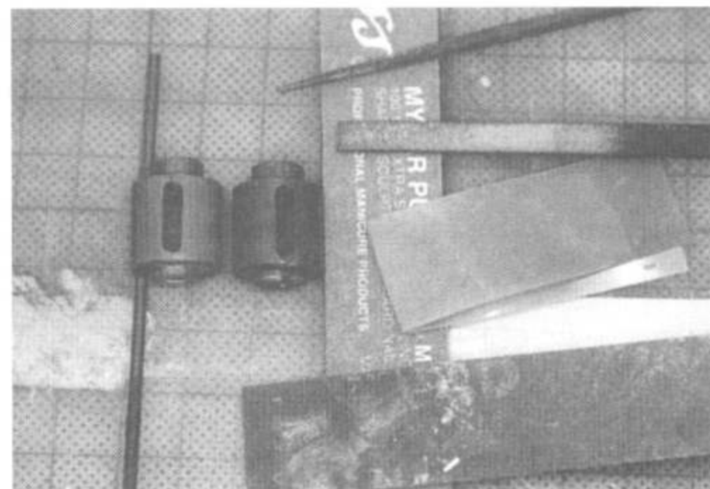
73. Половинки спонсона модели британского танка периода Первой мировой войны. Вырезы под ствол орудия в половинках спонсонов не совпадают. Вырез расточены круглыми надфилями.
