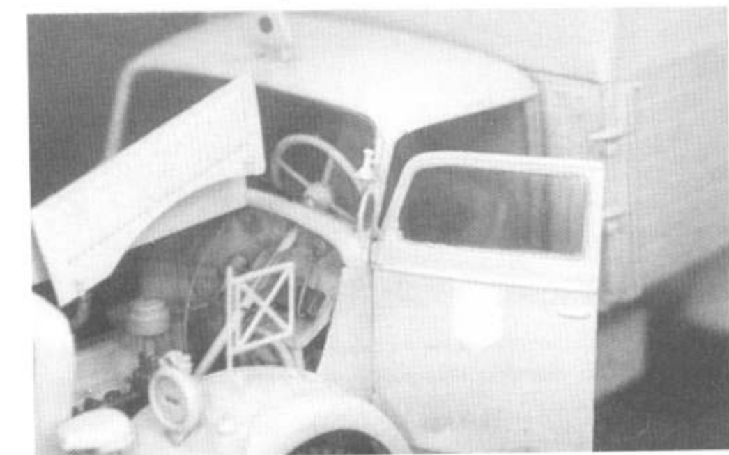
36. Прозрачные детали устанавливаются на клее ПВА. Излишки клея легко удаляются с прозрачных деталей, не мутняя поверхностей.
