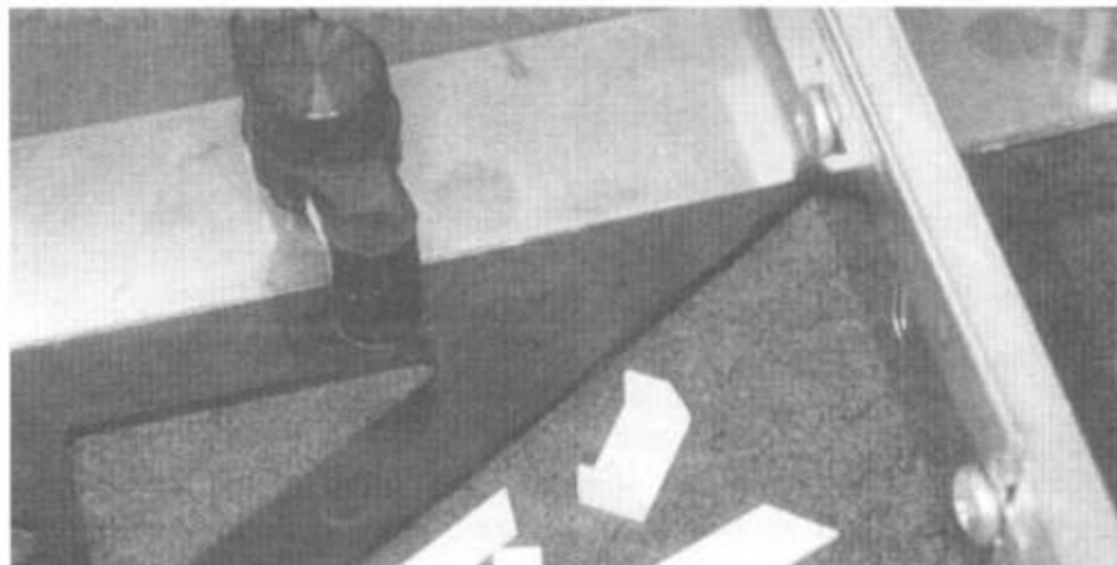
12. Резак фирмы NorthWest Short Line идеален для нарезки из листового пластика идентичных деталей.
