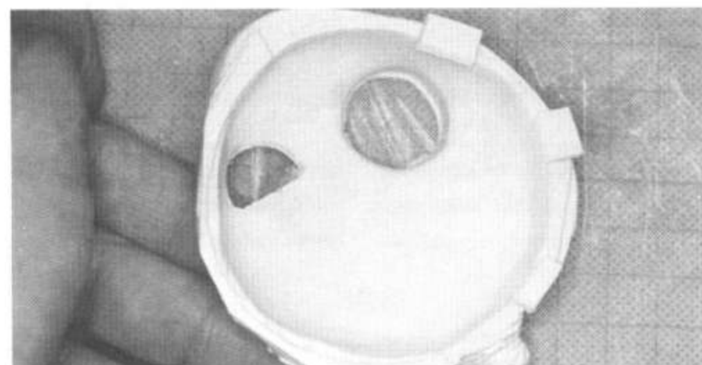
72. Поскольку прилив эпоксидки был только с одной стороны, то выдержать плоскостность нижней кромки башни при сошкури-вании довольно сложно. Шкурка наклеивается на плоский деревянный брусок. Об брусок стачивается низ башни до плоского уровня. Предварительно не повредит выровнять уровень башни, приклеив кусочки пластика на ту часть башни, где не надо стачивать эпоксидку.
