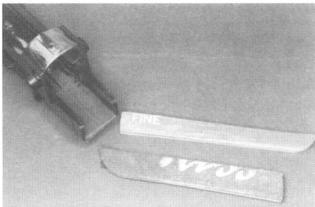
15. Прошпаклеванный шов зачищен нарезанными кусками маникюрных пилочек различной степени зернистости.
