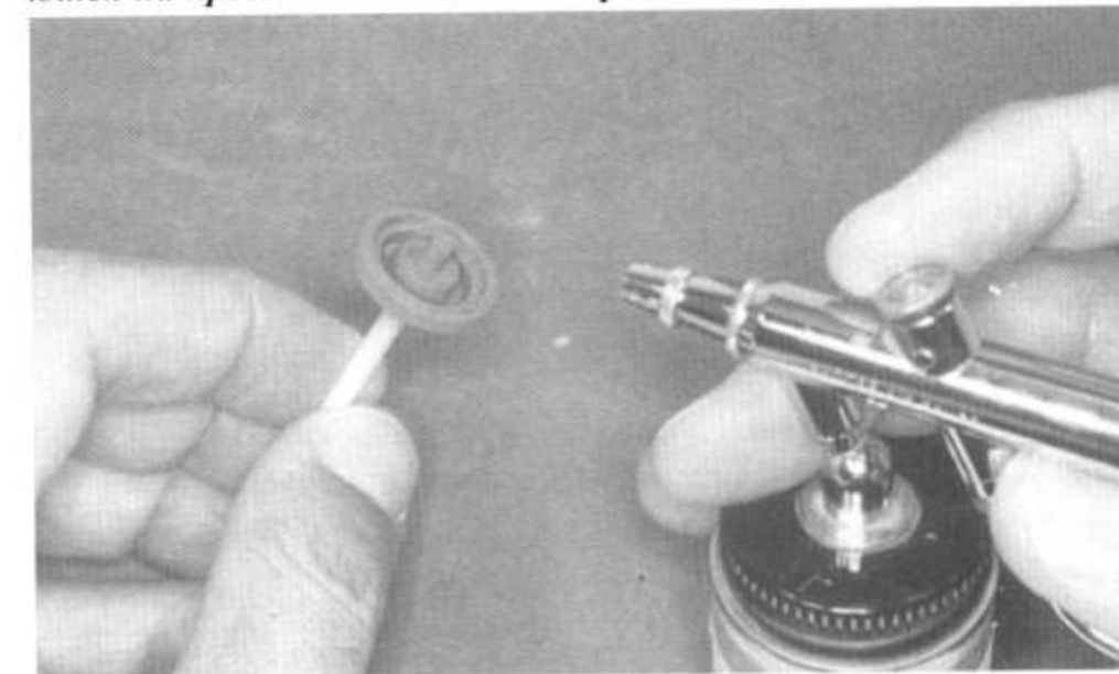
16. Опорные катки и другие колеса удобно окрасить насадив на зубочистки, а зубочистки вставив в пластилин, закрепленный на плоской поверхности.
