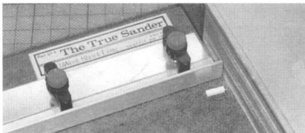
13. Для шлифовки мелких деталей, в данном случае распределительной коробки, использовано другое приспособление фирмы NorthWest.
