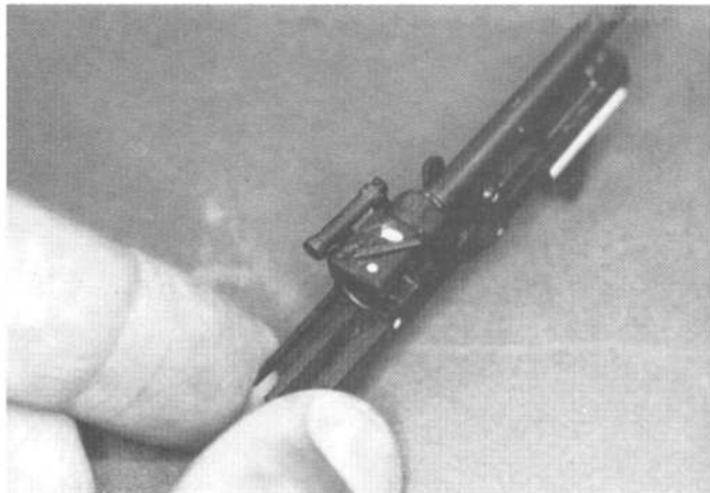
19. Собранное тело орудия модели германской противотанковой пушки калибра 75 мм. Хорошо видны заделанные вырубленные из листового пластика кружками следы от толкателей.
