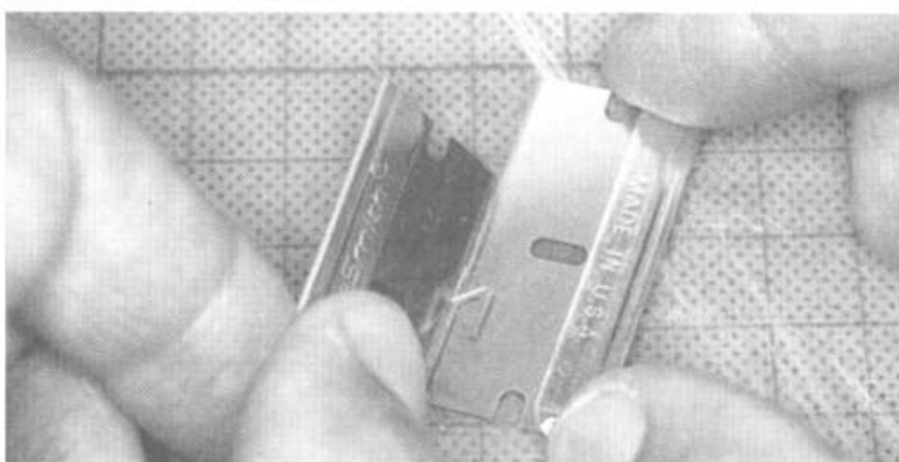
70. Мелкие детали гнутся двумя пилками из бритвенных лезвий.
