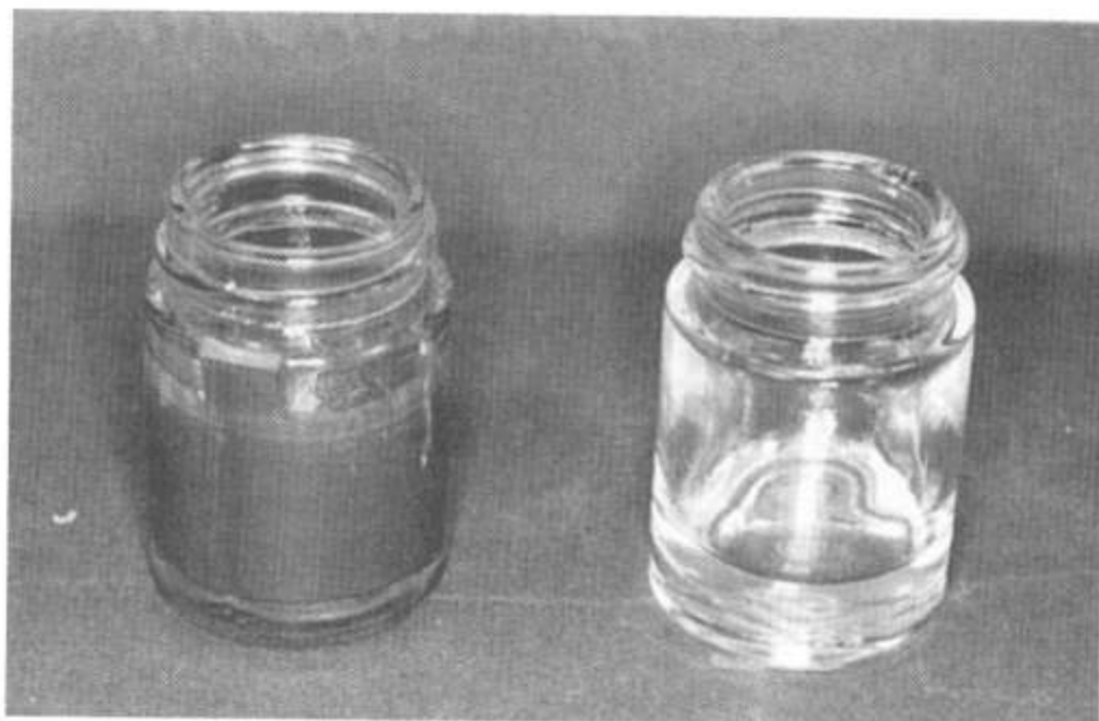
39. Для смешивания краски удобно использовать два одинаковых пузырька. В один наливается три части краски, в другой – одна часть растворителя.
