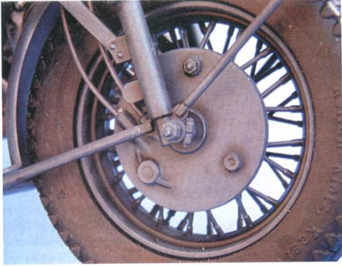
Переднее колесо и тормозной барабан. Шина отлита из синтетической резины с очень высоким качеством.
