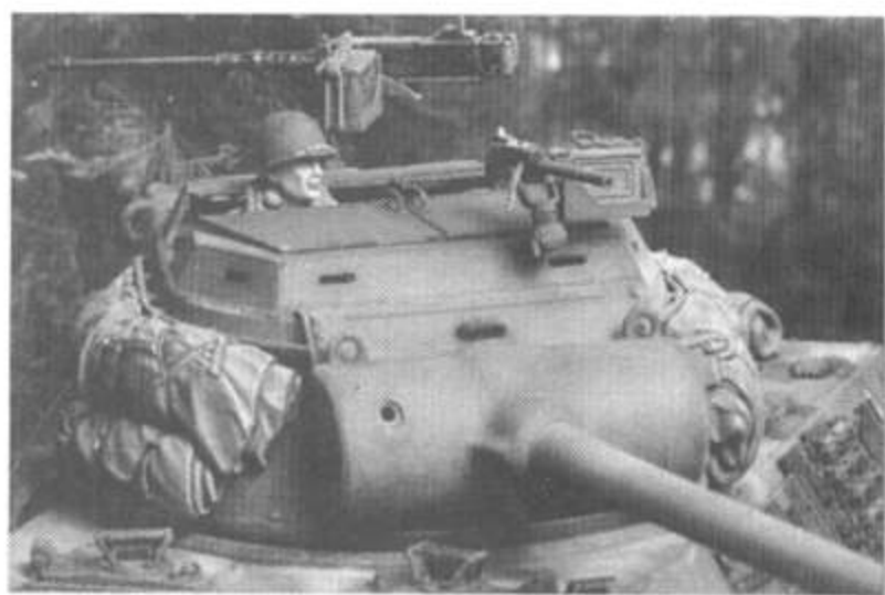
Благодаря установке бронированной крыши экипаж получил защиту от огня снайперов и гранат.
