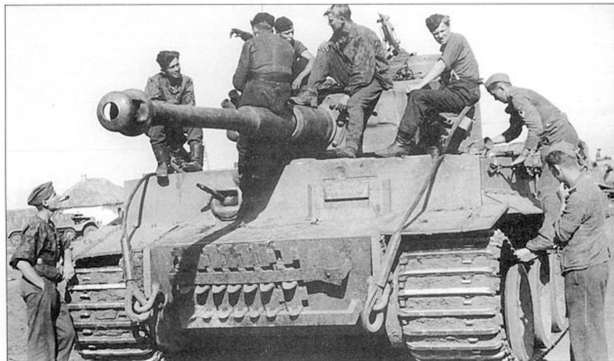
«Тигры» из 503-го тяжелого танкового батальона действовали в составе танковых дивизии СС «Дас Рейх» и «Мертвая Голова». Согласно книге Шнейдера «Tigers in Combat» снимок сделан 12-13 августа 1943 г. Танк скорее всего изготовлен в мае 1943 г. Номер шасси 250251. На машине установлен более мощный двигатель Майбах HL-230 P45 и усилена маска пушки.
