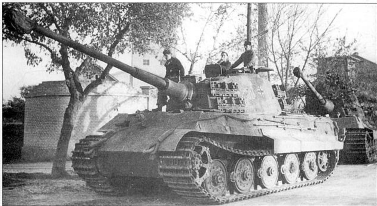
В ноябре 1944 г. танки 503-го тяжелого танкового батальона двинулись в направлении города Gyongyos в Венгрии. Снимок сделан 15 ноября. Стиль цифр тактических номеров на танках 2-й роты не изменился со времен «Тигров», состоявших на вооружении роты в 1943 г. Потерянные секции бортовых экранов – обычное дело у «Королевских Тигров». Для ускорения возможной буксировки, тросы уже закреплены на лобовых буксирных узлах танка. Поломки преследовали «Королевские Тигры» на протяжении всей их карьеры в войсках. Танк обладал для своих ходовой части и силовой установки слишком большой массой.
