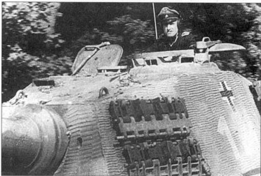
Опять кадр из фильма (спасибо доктору Геббельсу) – «Тигр II» из 101-го тяжелого танкового батальона СС, Нормандия, август 1944 г. Классический вариант «Королевского Тигра», машина изготовлена в июне 1944 г. Толщина люка заряжающего 15 мм, циммерит нанесен в заводских условиях.
