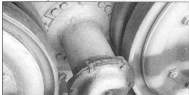
Второй, четвертый, шестой и восьмой опорные катки имели удлиненные втулки.
