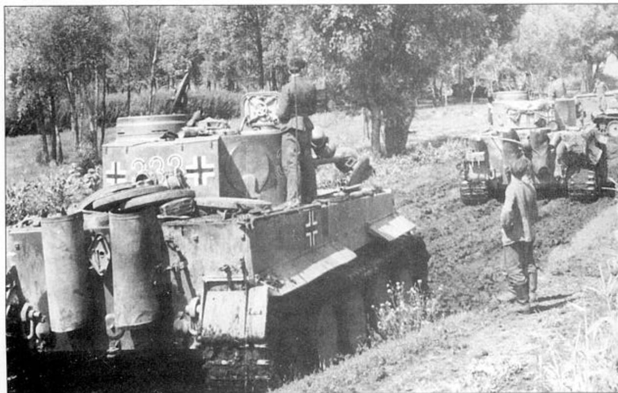
Первое хорошо заметное изменение облика «Тигра» - ликвидация пушечной амбразуры в правом борту башни. На месте амбразуры сделан круглый люк, предназначенный для погрузки снарядов и аварийной эвакуации из танка. Люк внедрен в декабре 1942 г., вероятно с танка № 250080. Танк «333» также принадлежит 503-му тяжёлому танковому батальону. Опять – «лишние» кресты, номера в трех местах вместо обычных двух. Интересно, что «Тигр» лишен практически всего навесного оборудования – инструмента, инструментального ящика, домкрата. Зато на крыше моторного отделения валяются четыре опорных катка.
