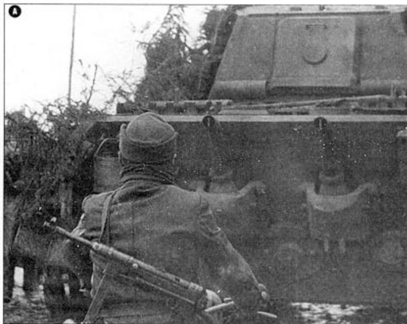
Танк «Тигр II» из 501-го тяжелого танкового батальона СС, наступление в Арденнах, 18 декабря 1944 г. Машина изготовлена не ранее октября 1944 г., это можно установить по отсутствию докмата ниже выхлопного патрубка.
