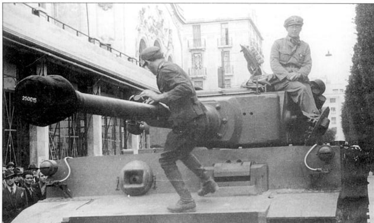
Первые «Тигры» прибыли в Тунис 23 ноября 1942 г. На снимке – танк с шасси № 250015, номер шасси написан на заглушке дульного тормоза. Шасси с данным номером было изготовлено в октябре 1942 г. Оплетка электропроводки фар имеет цвет натурального металла. На снимке сложно разглядеть, но фильтры Фейфель окрашены в очень темный цвет.
