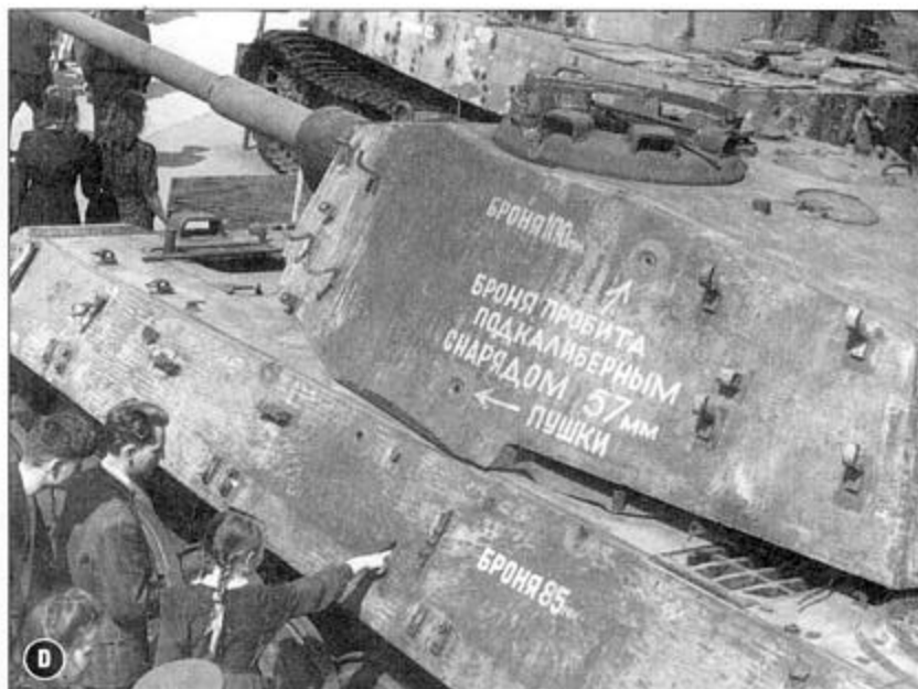
«Королевский Тигр» среди других трофеев Красной Армии на выставке в Москве. Металл подписан какой снаряд куда попал. Полностью отсутствует вся навеска и даже гусеницы.
