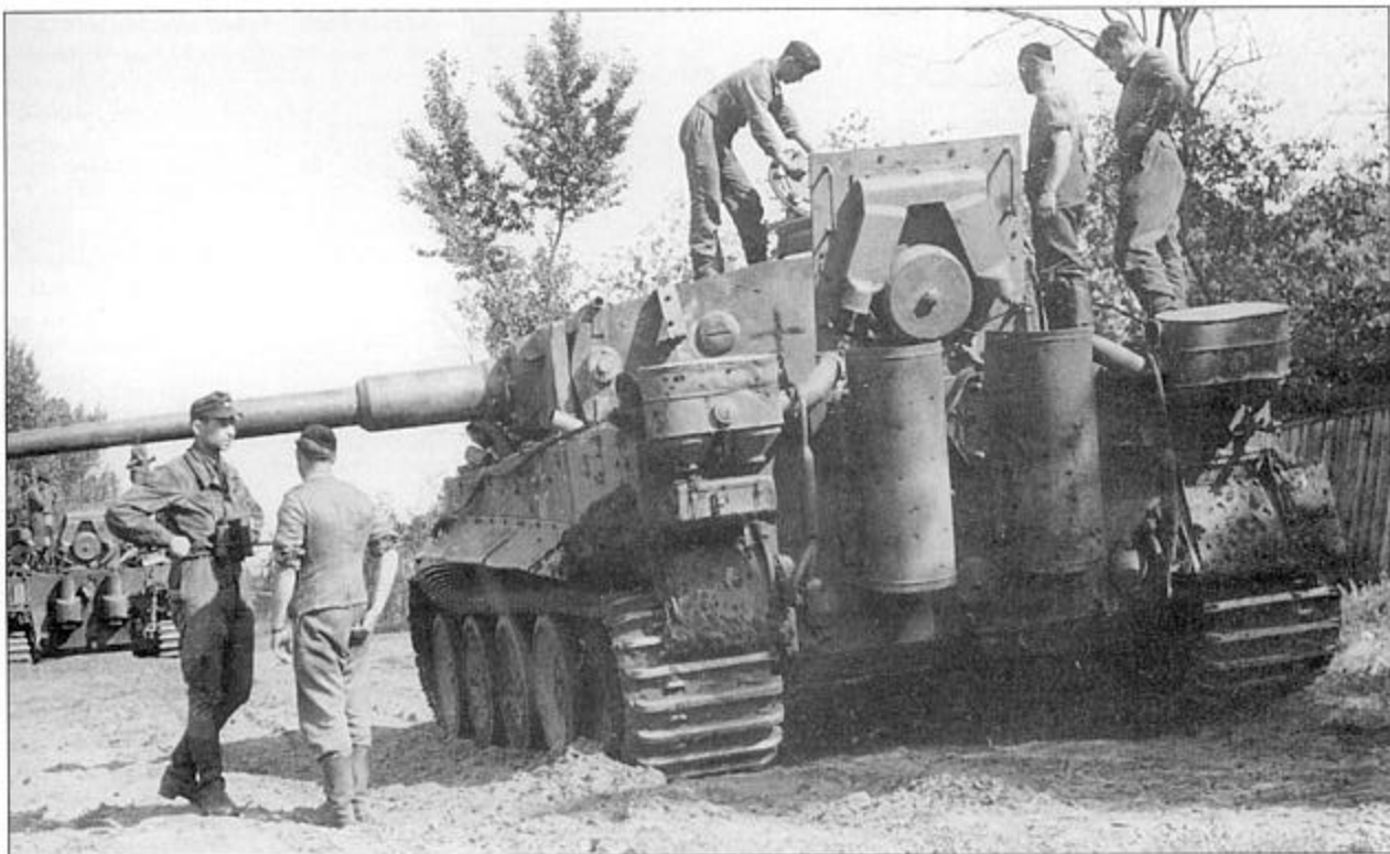
«Тигры» на стоянке, на переднем плане – танк с бортовым номером «323». Машина изготовлена в период с марта по май 1943 г. Фильтры «Фейфель» с одной вместо двух «канистр» были внедрены в серийное производство в марте 1943 г., а форма платы ручного стартера изменена только в мае. Танк – с новыми фильтрами, но со старой платой, значит он изготовлен в период с марта по май 1943 г.
