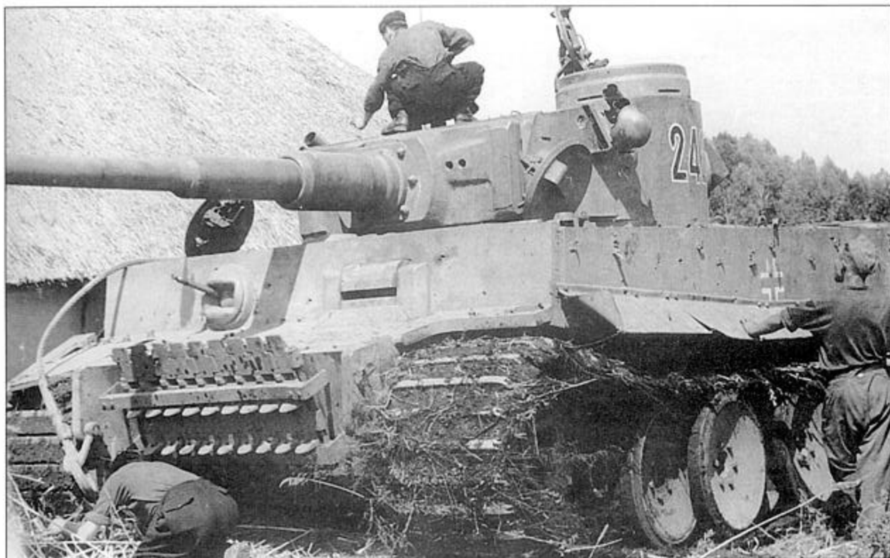
«Тигр» из 2-й роты 503-го тяжелого танкового батальона. Цифры номера машины второй роты отличались стилистикой от цифр номеров танков в других ротах батальона. Запасные траки в лобовой части корпуса – обычное дело. Крепеж для траков наварили в плевых условиях и никогда на заводе. Оцените украинский чернозем, полностью заливший ведущее колесо и передние опорные катки, а вот гребни траков сияют полированным металлом.
