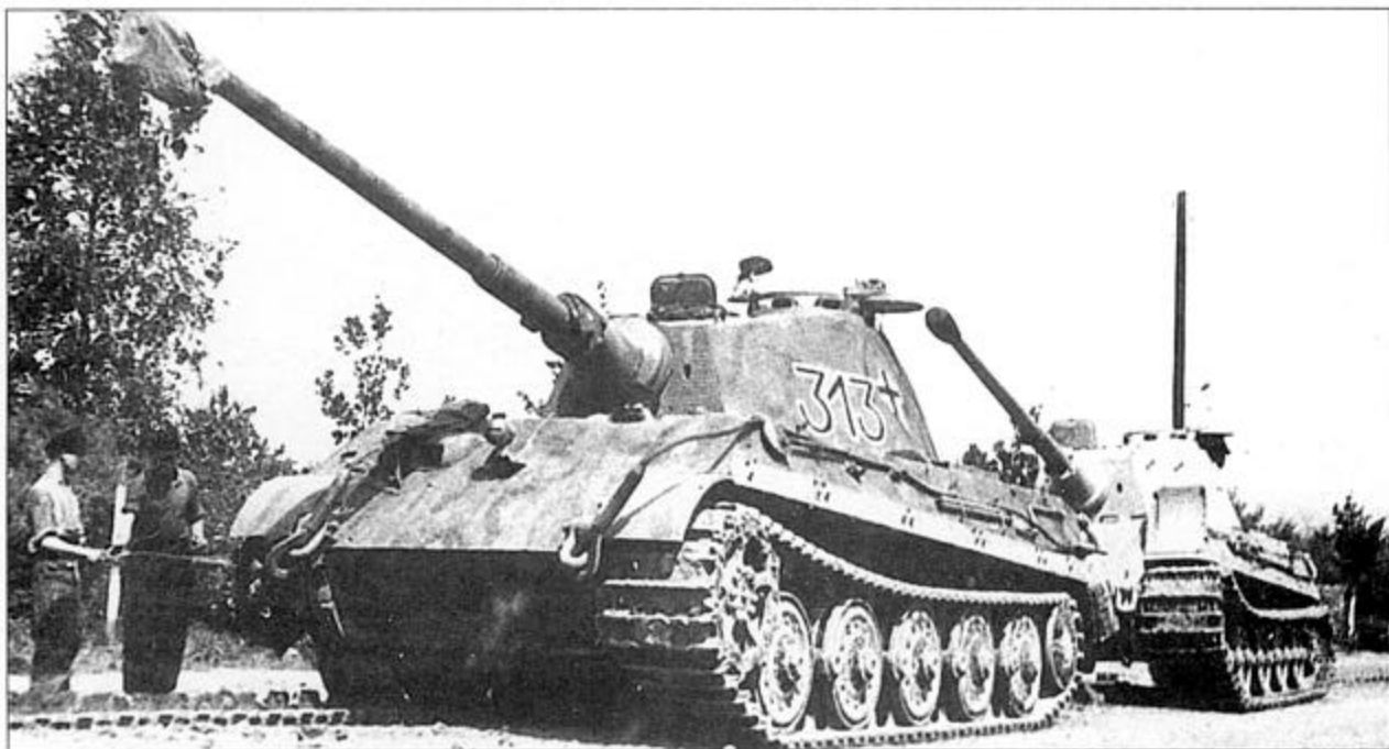
«Королевские Тигры» из 501-го тяжелого танкового батальона, сектор Кильце, Восточный фронт, лето 1944 г. Замена транспортных гусениц на боевые. Гусеница правого борта уже снята, на левом борту пока стоит транспортная гусеница. На заднем танке - боевые гусеницы. Бортовые экраны демонтированы на обеих машинах. Номера танков 3-й роты имели особый стиль изображения цифр: верх цифры «3» выполнялся плоским, а не с загондулиной. Кресты в 3-й роте обычно наносились укрупненно.
