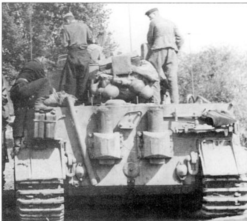
Серия снимков танков «Тигр» из 503-го тяжелого танкового батальона, конец лета 1943 г. Здесь представлен командирский Panzerbefehlswagen, что легко определить по нескольким установленным на нем штыревым радиоантеннам. На задней стенке корпуса закреплен цилиндрический контейнер с запасной антенной к радиостанции Fu-8. По форме пластины под ручкой стартера видно, что это машина ранней постройки.
