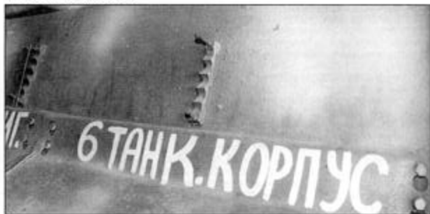
Крепеж стержней багника, на снимке видны головки болтов крепления секций бортового экрана. Секции можно демонтировать без полного отворачивания болтов.
