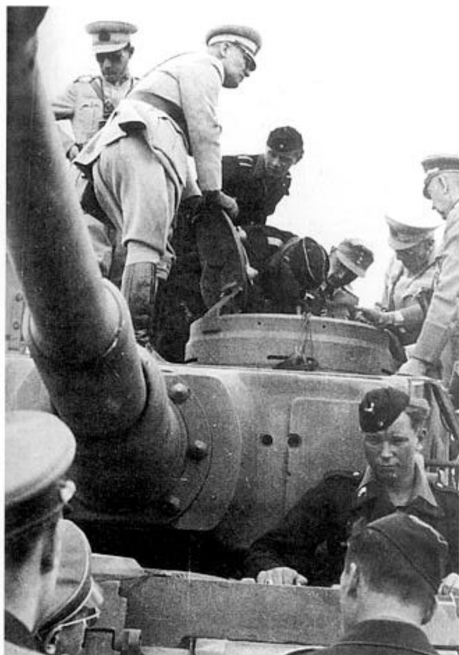
Танк «Тигр I» раннего выпуска осматривают венгерские офицеры. Маска пушки раннего типа, один из вариантов (вариант «Е» рисунка на предыдущей странице)
