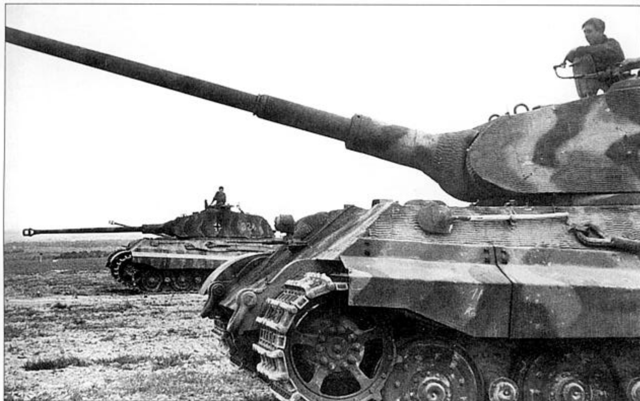
В числе первых танки «Тигр II» получила 3-я рота 503-го тяжелого танкового батальона, в большинстве своем это были машины раннего выпуска с узкими масками орудий и сегментированным бордюром вокруг подбашенного кольца. Снимок сделан на учениях в Мале-де-Камп во Франции в июле 1944 г. Позже танки 3-й роты были доставлены в Париж, но крайней мере один «Королевский Тигр» был потерян на маршруте при попытке съехать с железнодорожной платформы во время налета авиации союзников. Большинство своих «Королевских Тигров» рота потеряла в ходе боев в Нормандии.
