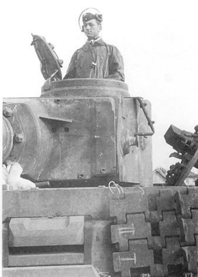
Еще один вариант ранней маски. Хорошо видна типичная полевая доработка – щиток от дождя и солнца над отверстиями биноклярного прицела.
