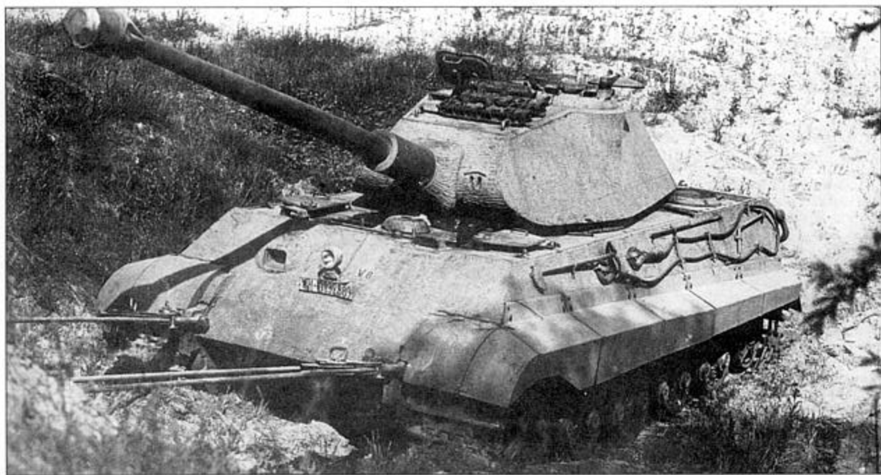
В феврале 1944 г. один из первых серийных «Королевских Тигров» проходил обкатку на полигоне в Куммерсдорфе. Согласно изданию «German's Tiger Tanks VK45.02 to Tiger II» это была машина номер 250008 февральского выпуска. На лобовой детали корпуса нанесена маркировка «V8», вероятно «V» обозначает «versuch». Даже циммерит не скрывает сварных швов. Танк снят при проверке возможности буксировки тяжелой машины. Представляет интерес номерной знак вермахта на лобовой детали корпуса и фара Бош без светомаскировочной щели.
