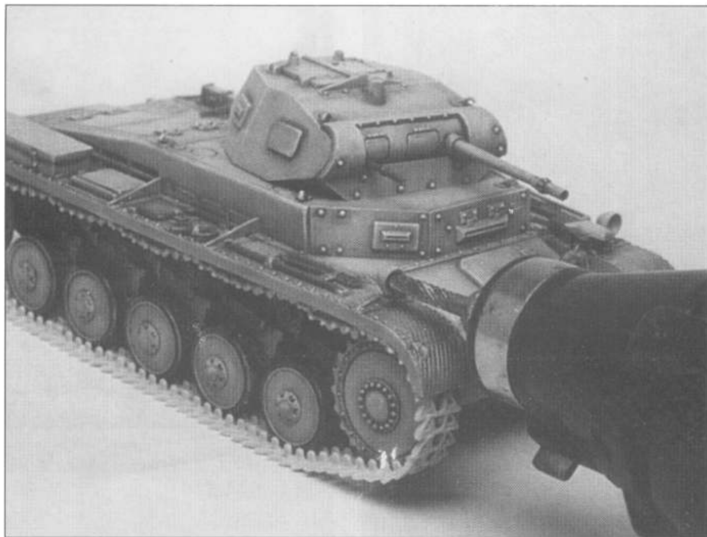
Полость фары высверливается микродрелью.
