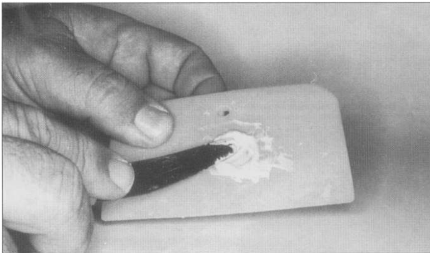
Смешивание двухкомпонентной эпоксидной шпаклевки.
