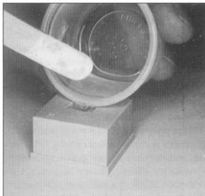
Заполнение формы литьевым составом.
