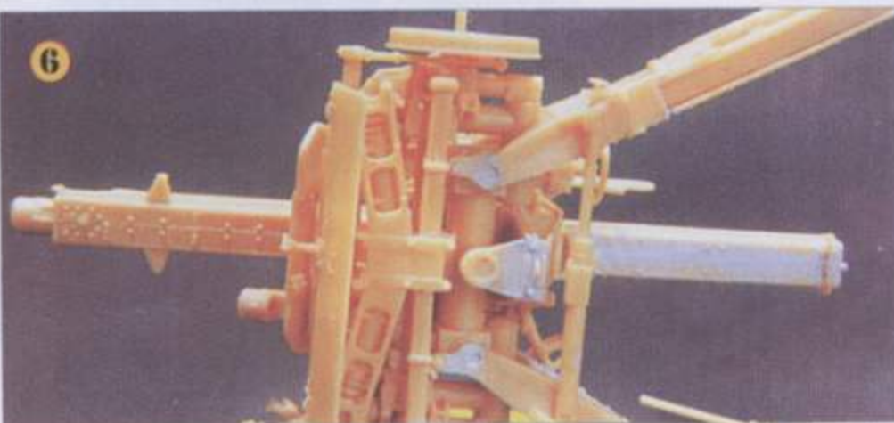
6. На виде снизу хорошо видны элементы подвески, тормоза, а также фиксатор станин в раздвинутом положении.
