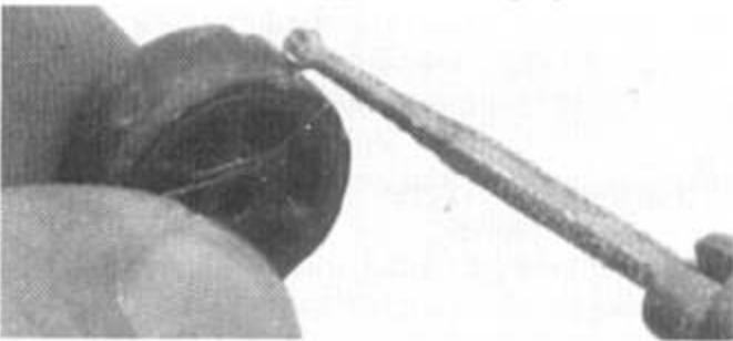
С помощью зубоврачебного бура и минидрели имитирован износ бандажей опорных катков.
