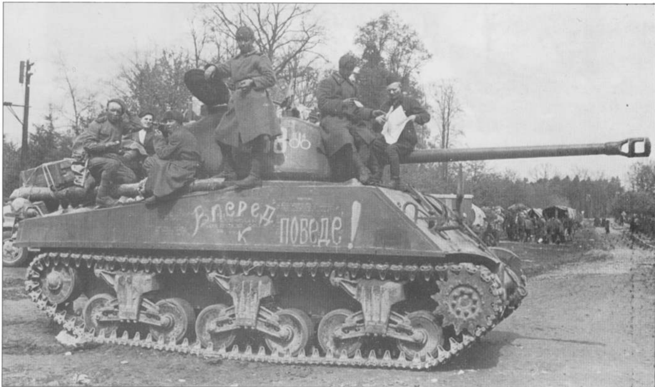
«Шерман» М4А2 из 64-го танкового полка 8-го Гвардейского танкового корпуса, Грабов, Германия, 3 мая 1945 г. Обратите внимание на гусеничные траки с металлическим шевроном, сплошные неспицованные опорные катки, ведущая звездочка тоже без отверстий. На корме танка навалено имущество экипажа, есть и бревно для самовытаскивания. Пушка оснащена дульным тормозом. Под надписью «Вперед к победе» просматриваются американские предупреждающие надписи.
