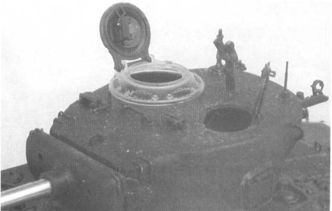
Башина в сборе. Хорошо видна прозрачная командирская башенка фирмы Caliber 35. Замена, как оказалось, была совершенно необязательна, но уж больно сложным делом оказалось удержаться от покупке великолепной конверсионной детали.
