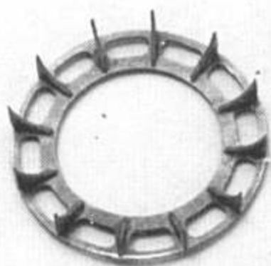
Кронштейны приклеены на свои места.
