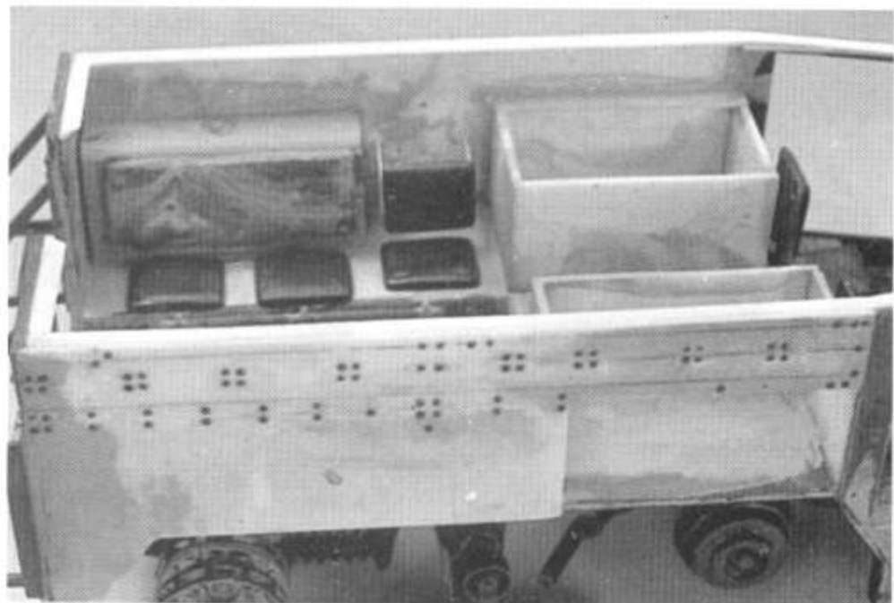
Крупный план борта кузова. Все заклепки аккуратно приклеены на свои места. При необходимости головки заклепок можно срезать с деталей любой ненужной модели.
