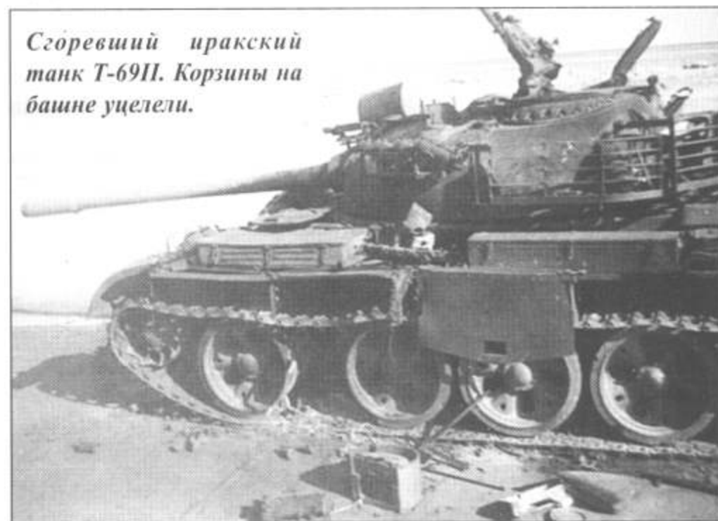
Т-69II, Ирак, 1991 г. На британском танкисте одет американский бронежилет. Танк можно идентифицировать как Т-69II только по бульбообразному выступу в кормовой части днища корпуса, башня — лысая, как на Т-55.
