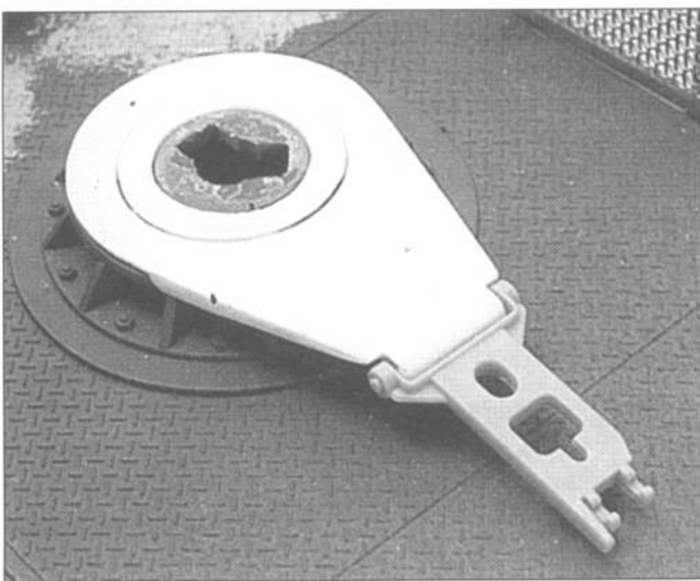
Еще один снимок установленной на место пластины с фиксатором ствола в походном положении.
