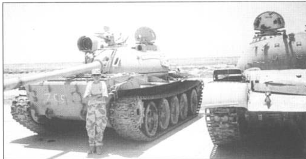
Танки Т-55 (слева) и Т-69II (справа) из 10-й иракской бронетанковой дивизии, Ирак, 2003 г. На Т-69II можно разобрать ограждение фар (самих фар нету) и узлы крепления минного трала.
