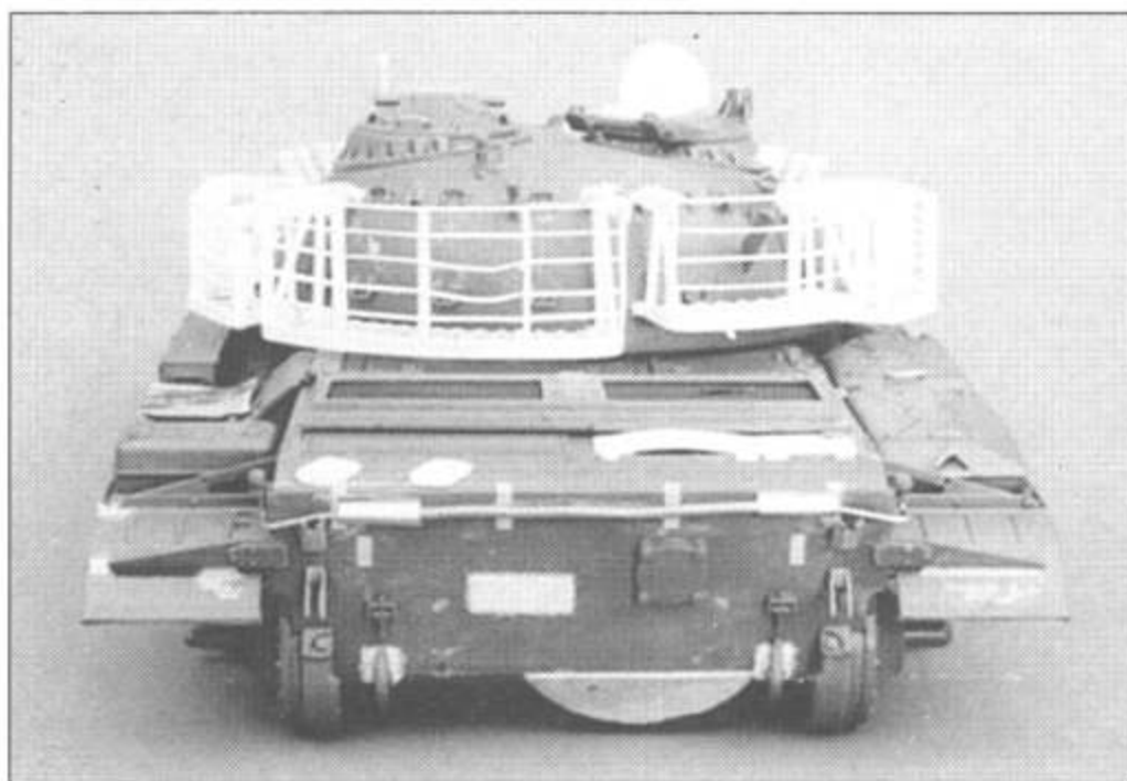
На этом снимке хорошо виден разный размер двух задних башенных корзин и прямоугольная плата на заднем листе корпуса.
