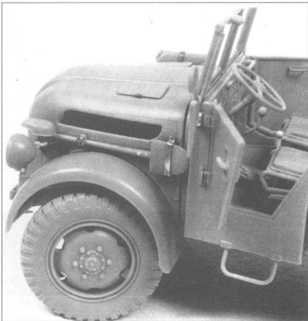
Левое переднее колесо крупным планом. Подножка сделана из стального стержня.
