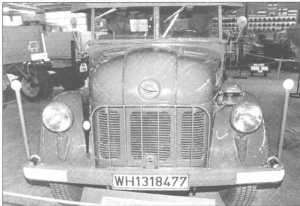
Вид спереди на автомобиль Штейр 1500. Видны две ошибки, сделанные реставраторами. Удивительна форма бампера, который концами загибается аж за крылья, а решетка установлена слишком близко к капоту двигателя.
