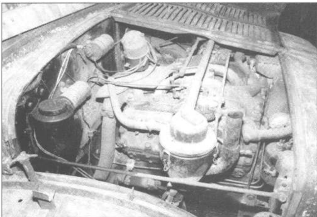
Двигатель. Обратите внимание на тесную, почти самолетную, компоновку моторного отсека. 8-цилиндровый V-образный двигатель с объемом цилиндров 3,8 л выпускала фирма Хорьх.
