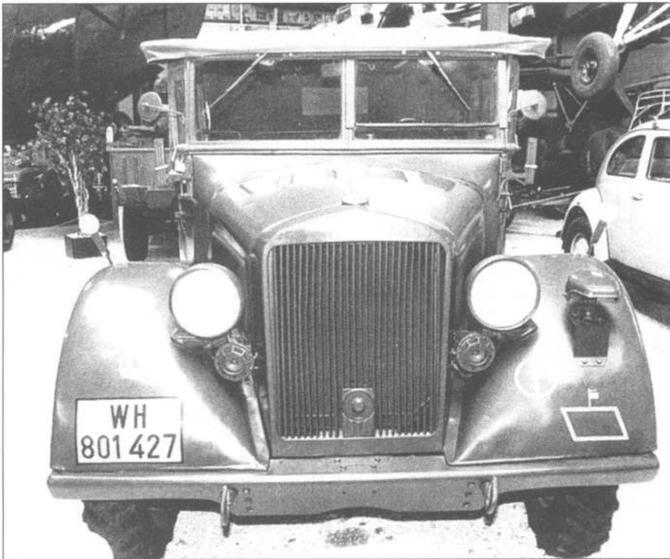
Передняя часть Хорьха. Видны головки болтов крепления бампера. Двух болтов в центре бампера не хватает. Ветровое стекло шофера приоткрыто.
