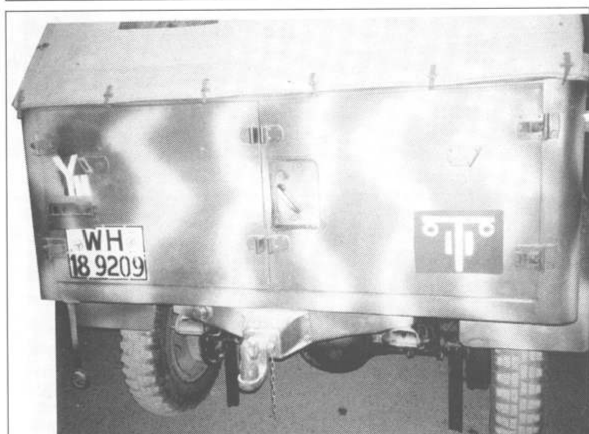
Качественный снимок задка кузова. Хорошо видны ручка, номерной знак, крепеж тента, петли дверок.
