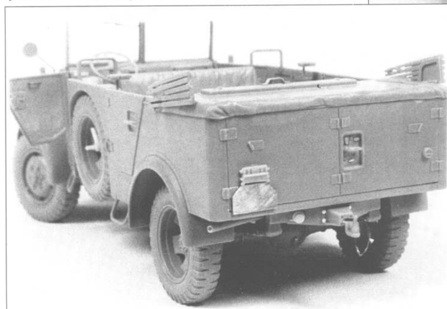
Качественный снимок задка кузова. Хорошо видны ручка, номерной знак, крепеж тента, петли дверок.
