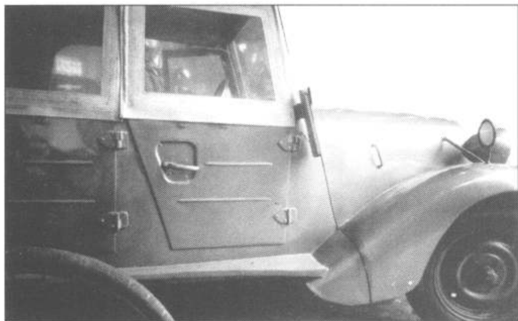
Правый борт. Видны выштамповки для увеличения жесткости дверей. На крыле установлено второе зеркало заднего вида.
