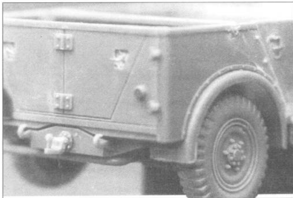
Задняя стенка кузова. Конвойная фара – от модели танка Pz.Kpfw. IV. Ручки дверей сделаны из медной проволоки. Доработаны петли дверей.
