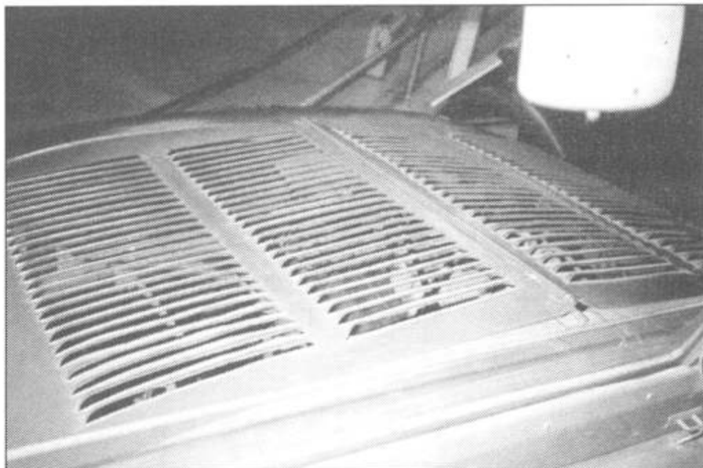
Вентиляционные щели на капоте двигателя начинаются прямо от лобового стекла.
