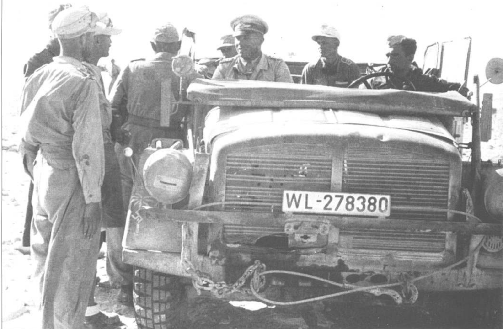
Автомобиль Auto-Union Horch Kfz. 70 одного из подразделений люфтваффе. На правом крыле нанесена эмблема корпуса Африка, а также на задней дверце кузова. Фары закрыты светомаскировочными насадками. На бампере видны цепи и буксирный трос. Лобовое стекло закрыто тентом.
