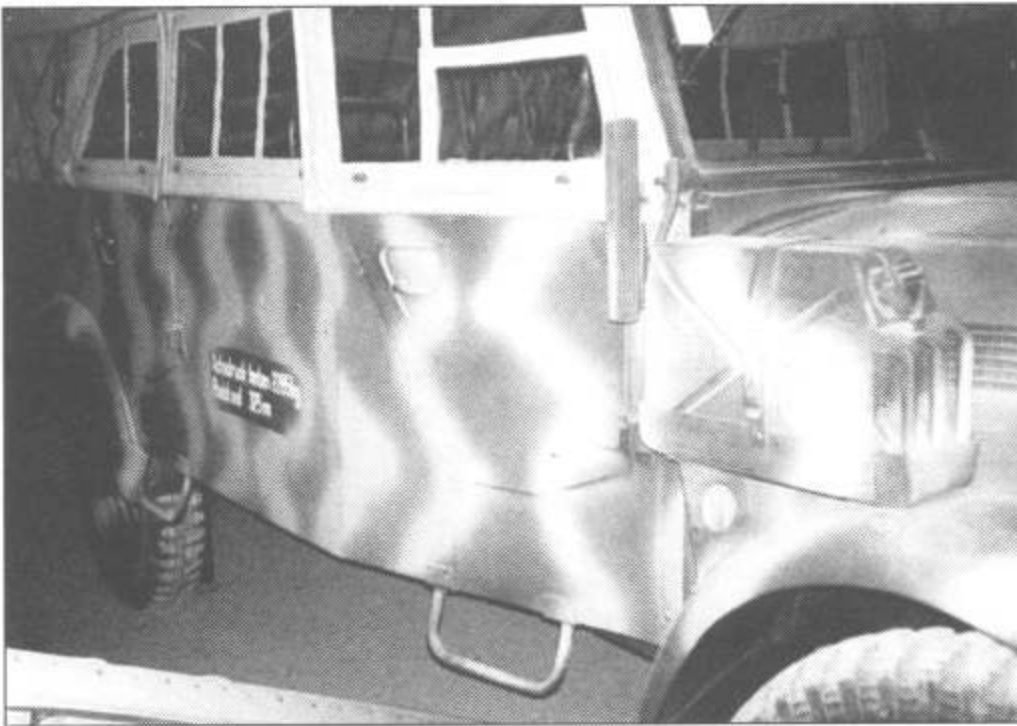
Правый борт автомобиля Штейр 1500. Запасные канистры для бензина закреплены на крыле.
