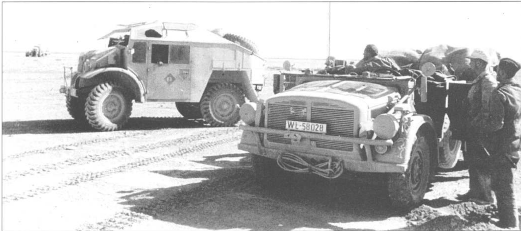
Радиомашинa Хорьх Kfz. 23 подразделения люфтваффе, приданного 15-й дивизии. Хорошо виден трубчатый бампер с номерным знаком.
