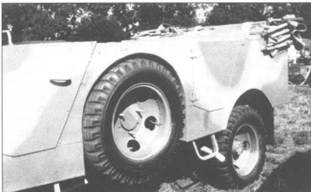
Вариант крепления запасного колеса на трех стержнях.
