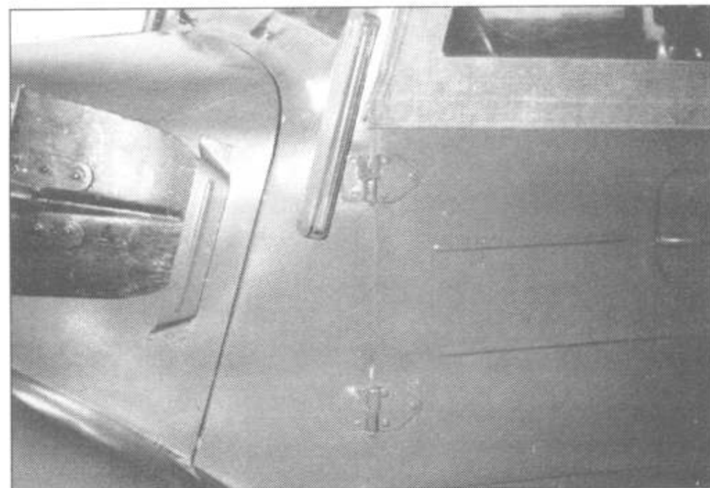
Детализировка петель дверей, ручка, крепеж лопаты.
