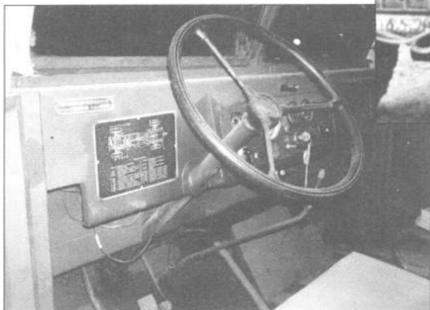
Приборная доска. Хорошо видны таблички. Табличка поменьше содержит информацию о заводе-изготовителе и дату выпуска автомобиля, на табличке побольше изображены механические элементы шасси. Таблички прикручены к панели корпуса винтами.
