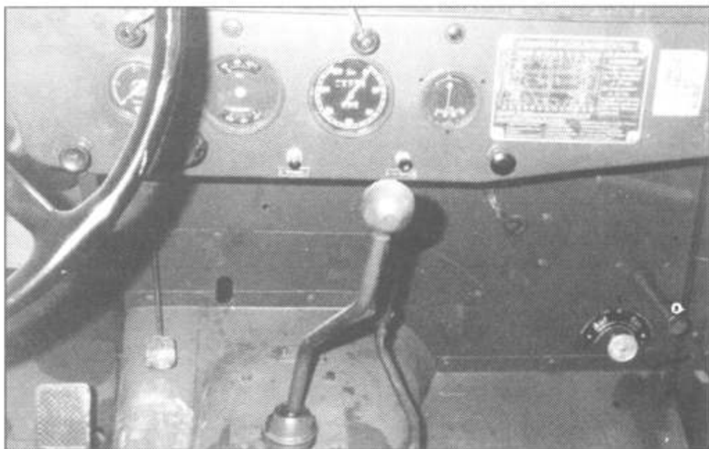
Приборная доска и рычаг переключения передач. Внизу видны педали газа и тормоза. Правее приборов закреплены две таблички. Таблица побольше изображает элементы ходовой части.
