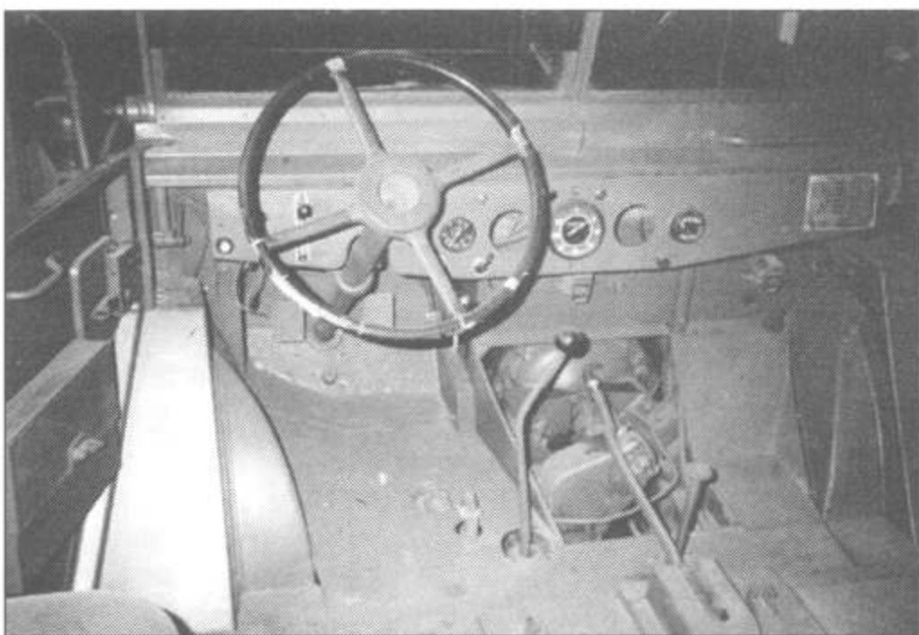
Рулевое колесо и приборная доска. В ходе серийного производства менялись дизайн рулевого колеса, размещение рычагов управления и приборов.
