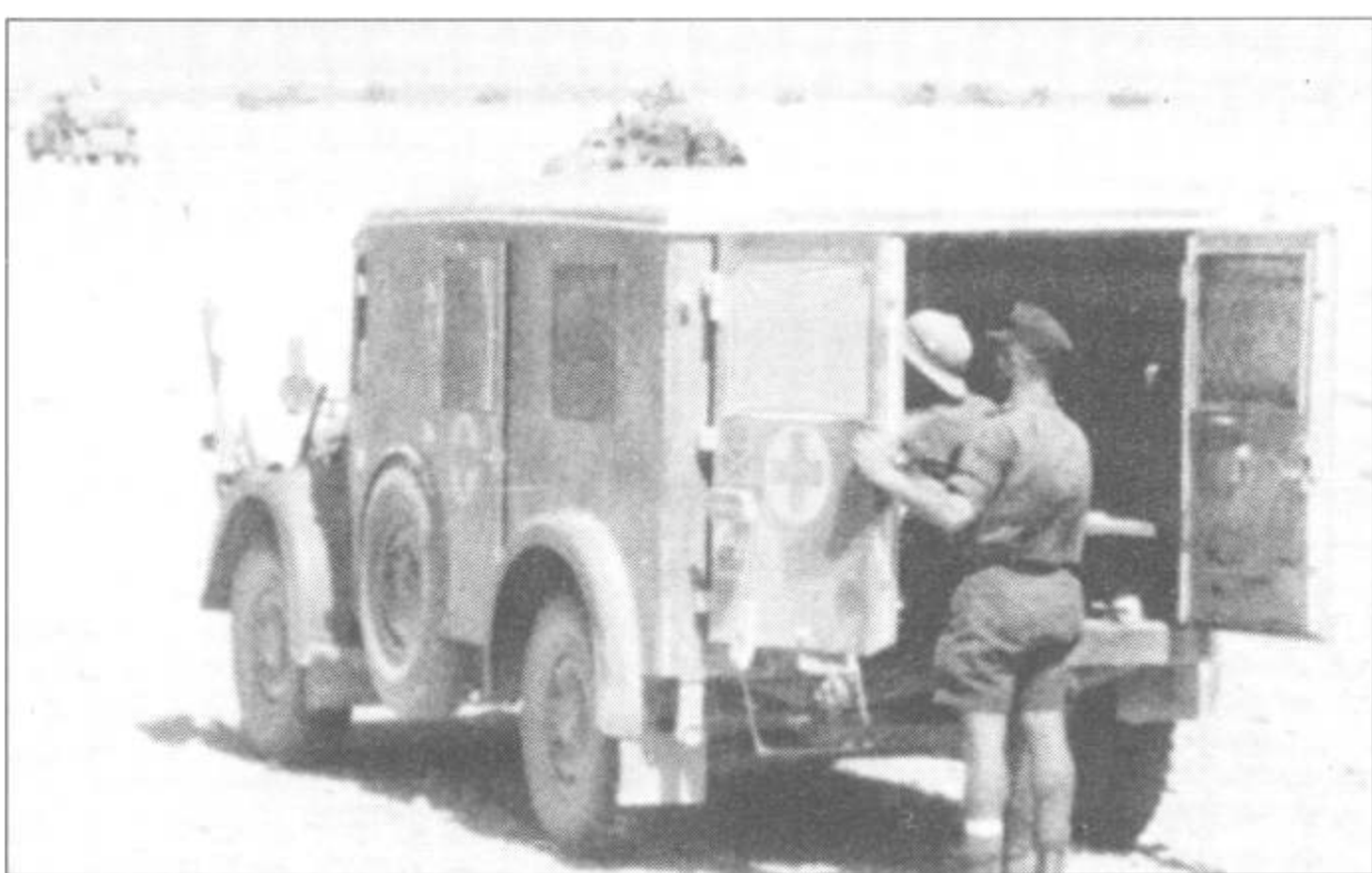
Санитарный Хорьх Kfz. 31 – крайне редкая машина. Снимок сделан в Северной Африке. Грузоподъемность санитарного Хорьха составляла 3050 кг, в то время как второй по грузоподъемности санитарный автомобиль вермахта Phaeton Granit мог перевозить только 2 400 кг груза. Хорошо видны нарисованные на кузове красные кресты в белых кругах.
