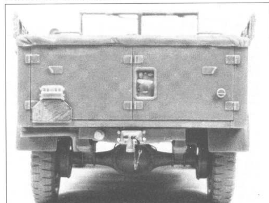
Корма модели доработана в очень незначительной степени. Заменены ручки на дверцах, таблички номерных знаков вырезаны из алюминиевого листа. Обратите внимание на головки четырех болтов, которыми крепится к раме буксирный крюк.
