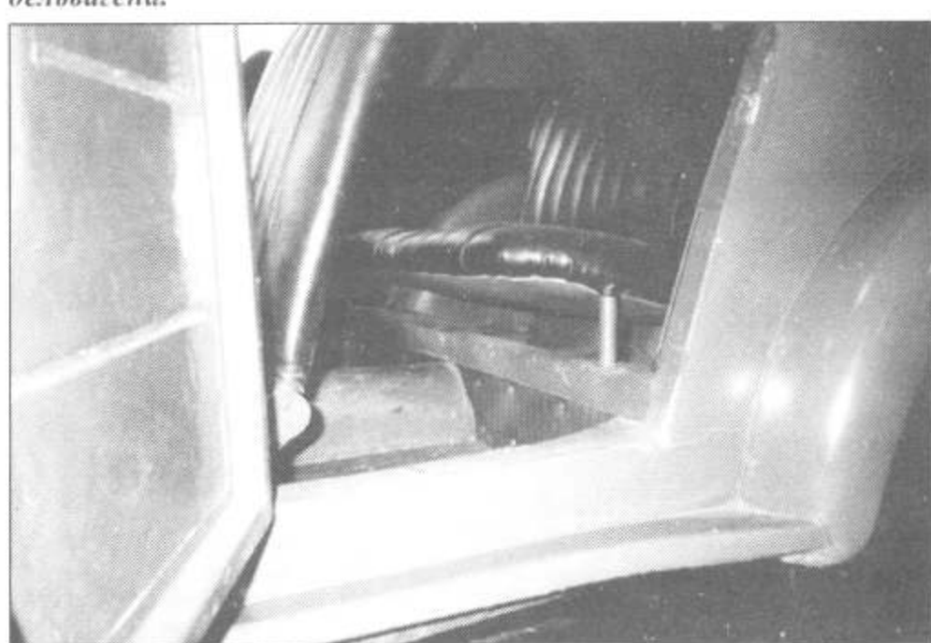
Заднее сиденье-диван. Сиденье также гражданского образца. На военных машинах сиденья были сделаны по типу сидений Кюбельвагена.
