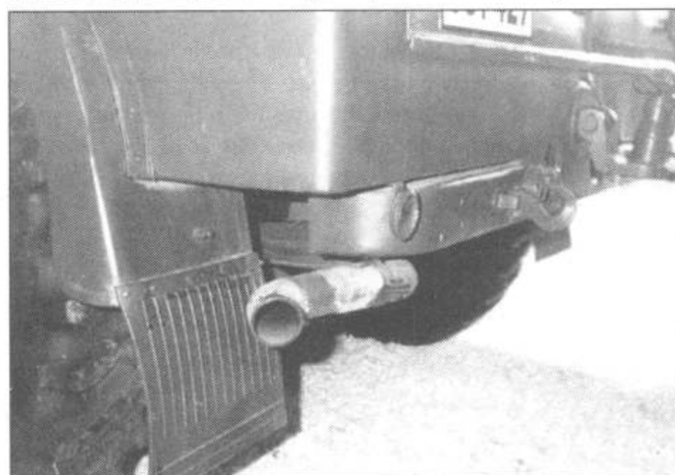
Левый нижний задний угол корпуса Хорьха. Бросается в гла- за выхлопная труба. Фартук крепится к крылу винтами.
