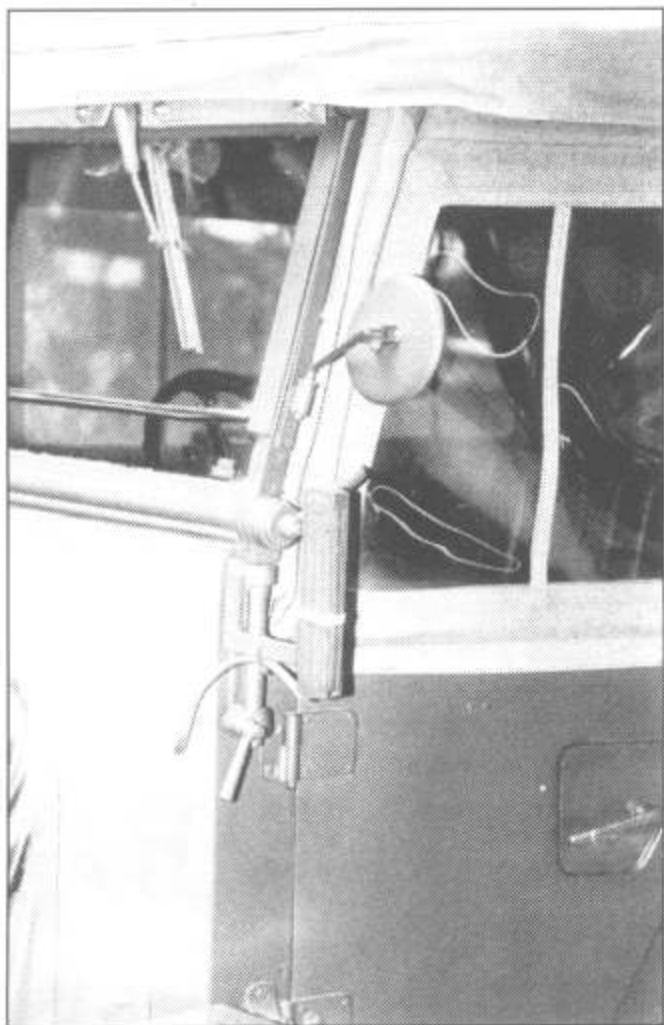
Левый передний угол кабины. Видны зеркало заднего вида и указатель положения передних колес.
