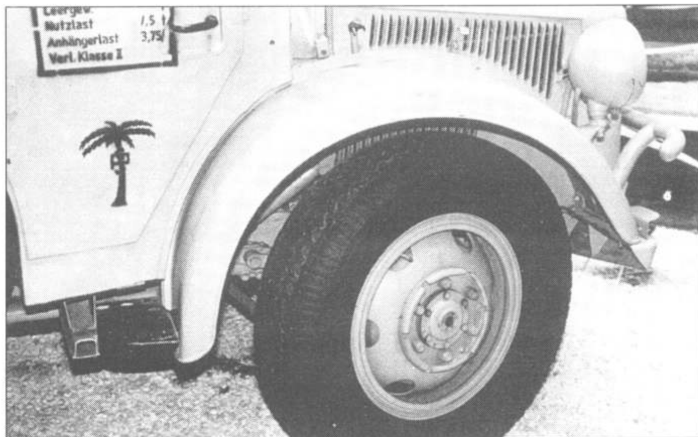
Крыло и правое переднее колесо. Ниже подножки видно крепление домкрата.
