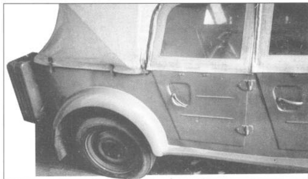
Задняя часть правого борта Татры 57К. Крыло явно больше, чем на модели, к нижней части крыла прикреплен резиновый фартук.
