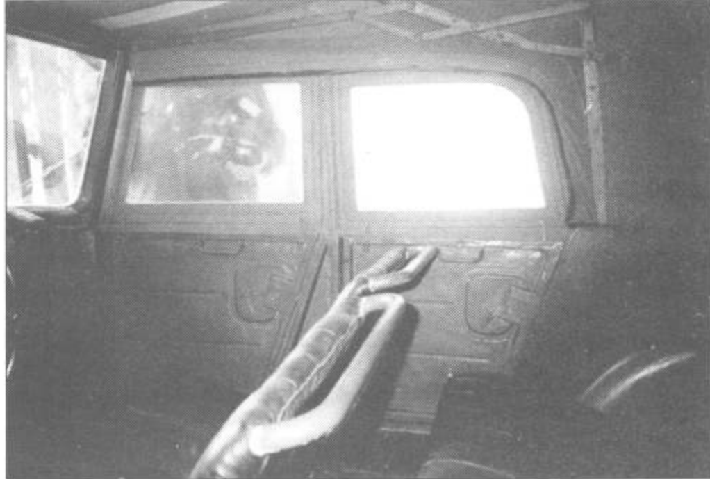
Спинки передних сидений. Хорошо видны внутренние поверхности дверок и тента. Сиденья – гражданского, а не военного образца.
