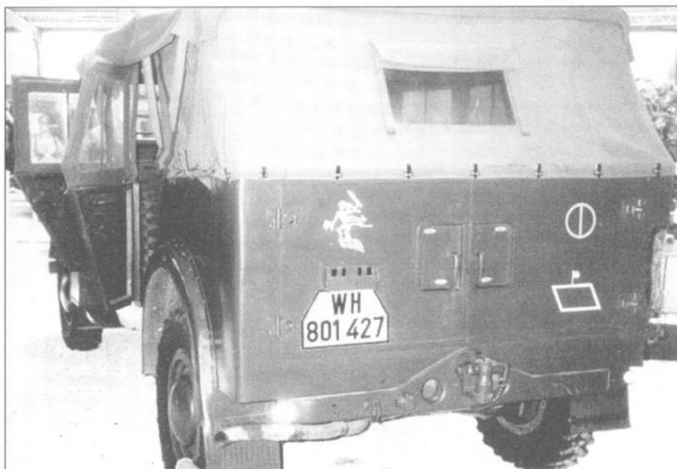
Корма Хорьха Кфz.16 отличалась от кормы кузова Хорьха Кфz.15. Так у 16-й модели в задней стенке сделаны две двери, а у Кфz.15 была одна дверь.
