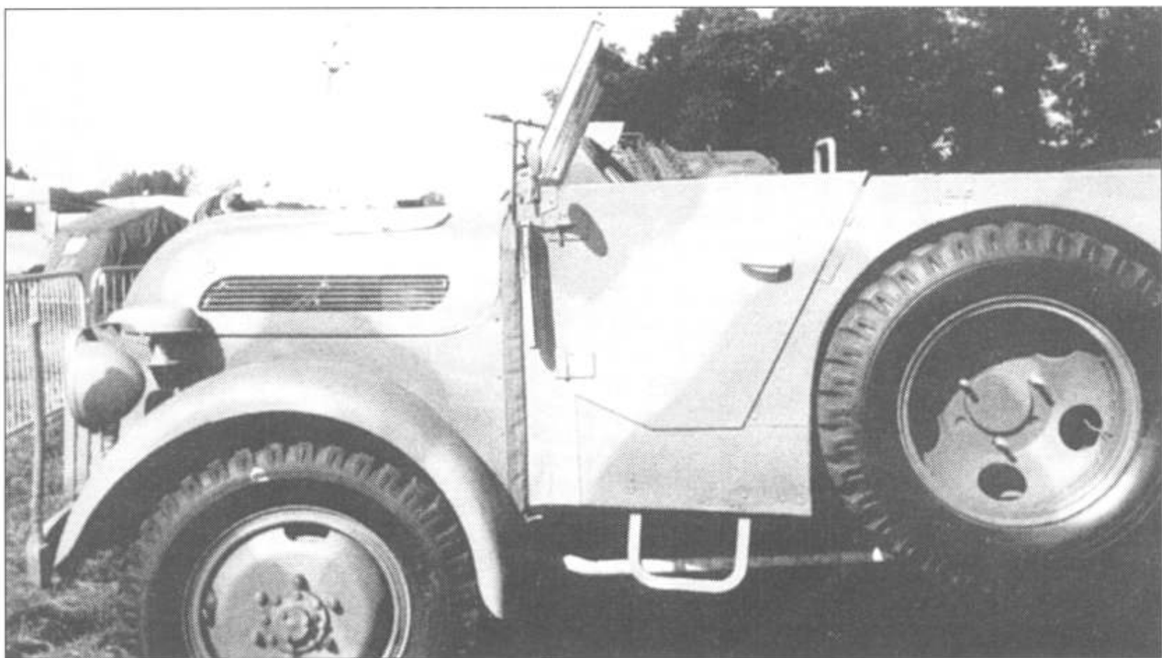
Зеркало заднего обзора и указатель поворота передних колес. Перед зеркалом видна рукоятка механизма откидывания лобового стекла.
