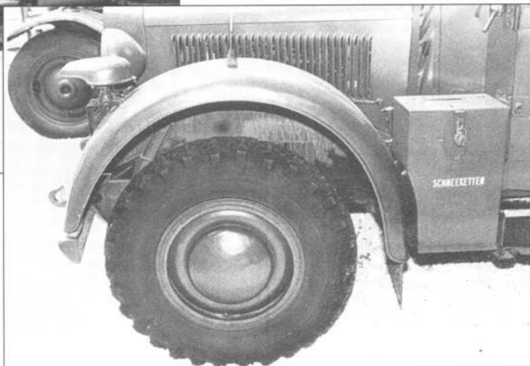
Крупный план передней части левого крыла – обычная фара и фара Нотек. Ниже фары закреплён клаксон.
