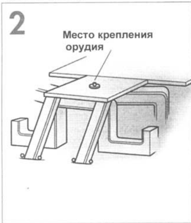
Рисунок крепления люльки пушки в боевом отделении. Сборка приклеена вместо пары выступов, уже срезанных.
