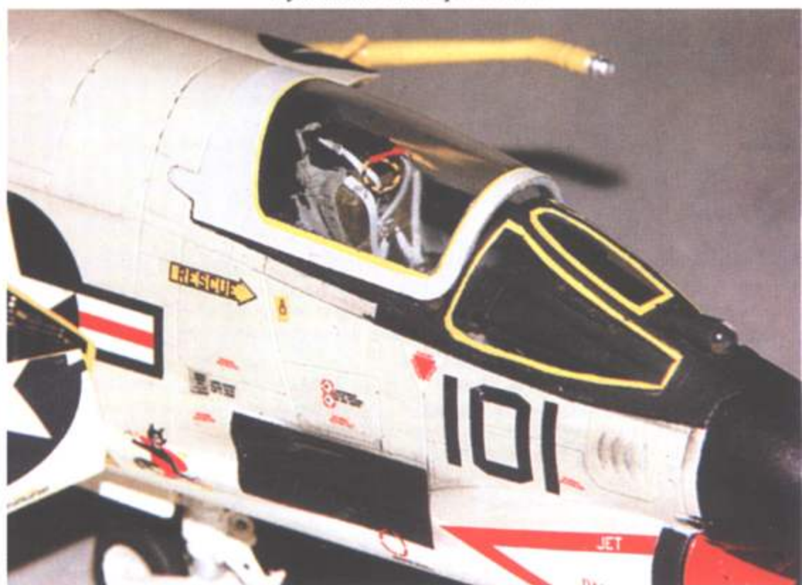
Фонарь кабины установлен в слегка приоткрытом положении; его полное открытие требует корректировки, как самой подъемной части фонаря, так и фюзеляжа.
