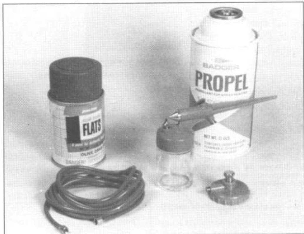
Дешевая альтернатива компрессору и аэрографу: аэрозольные баллончики с краской и примитивный аэрограф.
