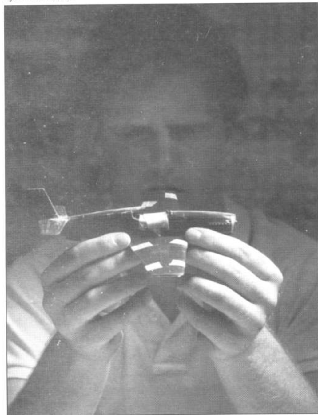
Проверка правильности установки крыла.
