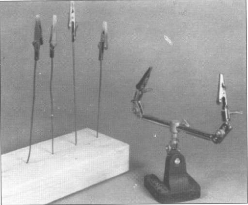
«Дополнительные руки» - радиотехнические зажимы-аллигаторы помогут окрасить мелкие детали модели.
