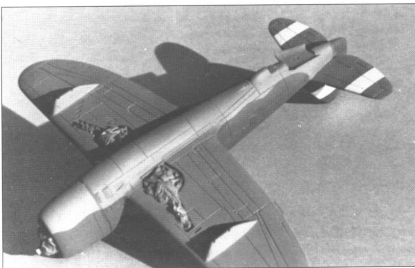
Четкая волнистая граница цветов получена на модели истребителя P-47 «Тандерболт» в М 1:72 с помощью масок.
