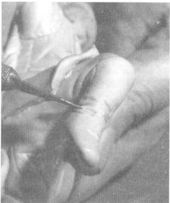
328. Прорезаем шов, который отделяет колодку от голенища.
