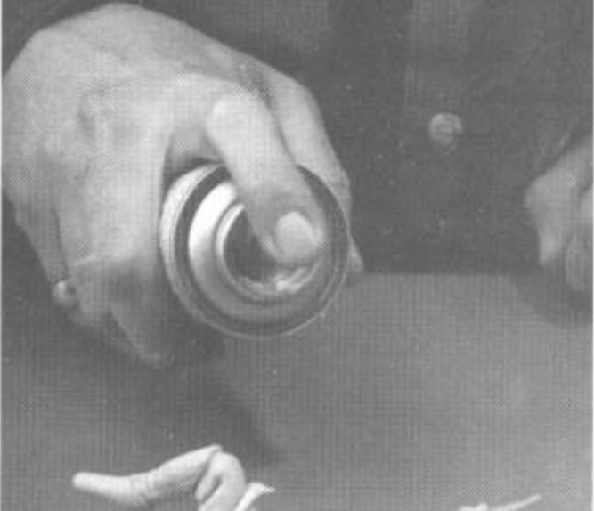
375. Первый шаг в окраске изделия – грунтовка аэрозолем.
