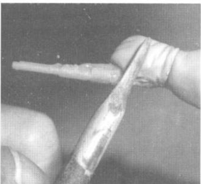
352. Формируем лопаткой складки на перчатке.
