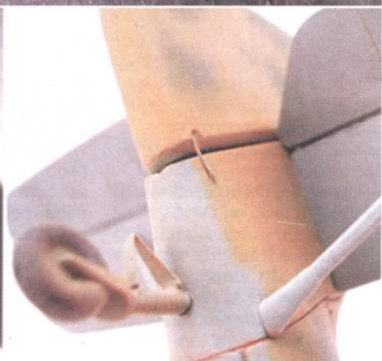
При сборке использовались фототравленные детали, например – тяга руля направления и элемент опоры шасси.
