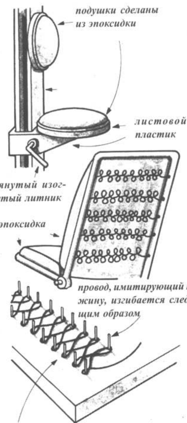
кондуктор сделан из деревянного бруска с набитыми в него гвоздями
