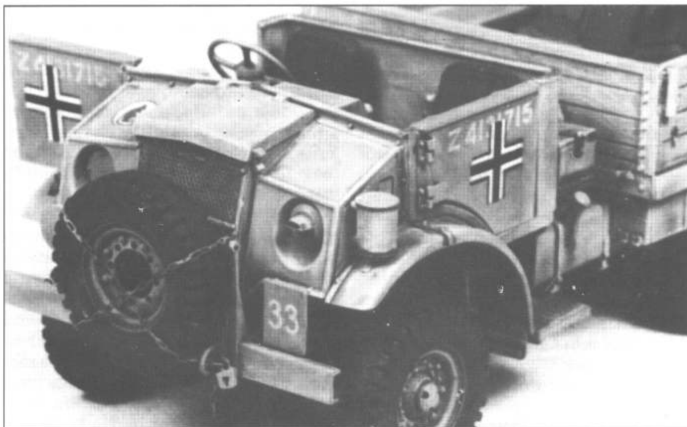
Запасное колесо закрепленное цепями на решетке радиатора здорово оживляет облик модели грузового автомобиля Шевроле. Машина окрашена под трофейную. Рифленая подножка сделана заново.
