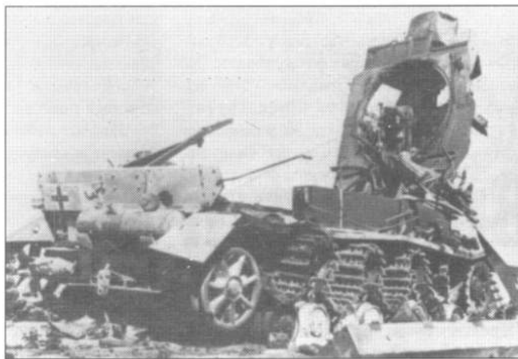
Вот что бывает, когда взрывается танковый боекомплект! Обратите внимание на изгибы верхней ветви гусеничной ленты. В Северной Африке ощущался недостаток в запасных частях к танкам как у немцев, так и у союзников, поэтому с поврежденных машин немедленно снималось все, что могло представлять хоть какую-нибудь ценность.
