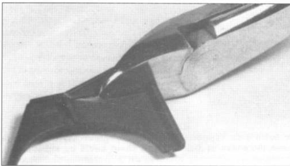
Намеченная часть пластика удаляется кусачками.
