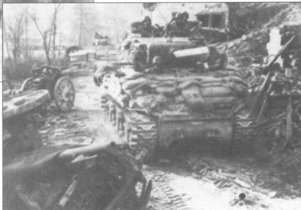
Реальный снимок времен второй мировой войны. Дополнительная защита лобовой части «Шермана» обеспечена мешками с песком. Мешки с песком укреплены также по бортам корпуса и башни. На траки гусениц установлены уширители с целью снижения удельного давления машины на грунт.
