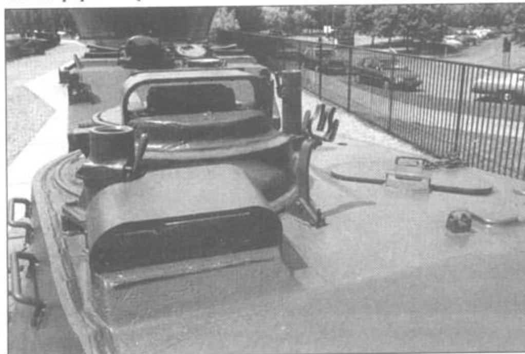
Командирская башенка, прицел командира и перископ наводчика, видна также вторая тумба для крупнокалиберного пулемета и фиксатор пулемета в походном положении. Фиксатор на модели установлен иначе.
