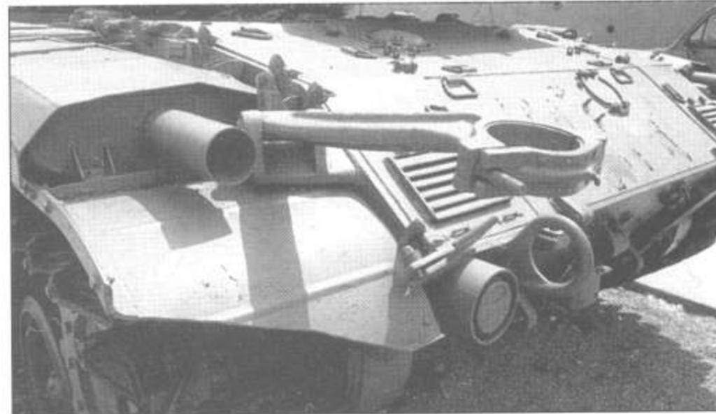
Фиксатор ствола орудия в походном положении. Хорошо видна детализровка кормы корпуса.
