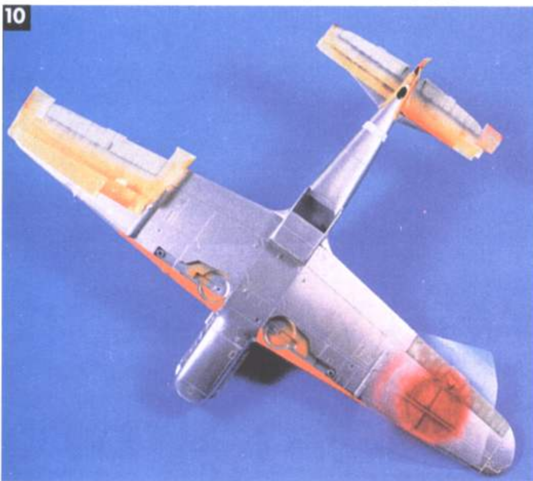
Вся доработка опор шасси свелась к имитации тормозных магистралей медной проволокой, однако окраска элементов опор шасси – процесс не столь простой.
