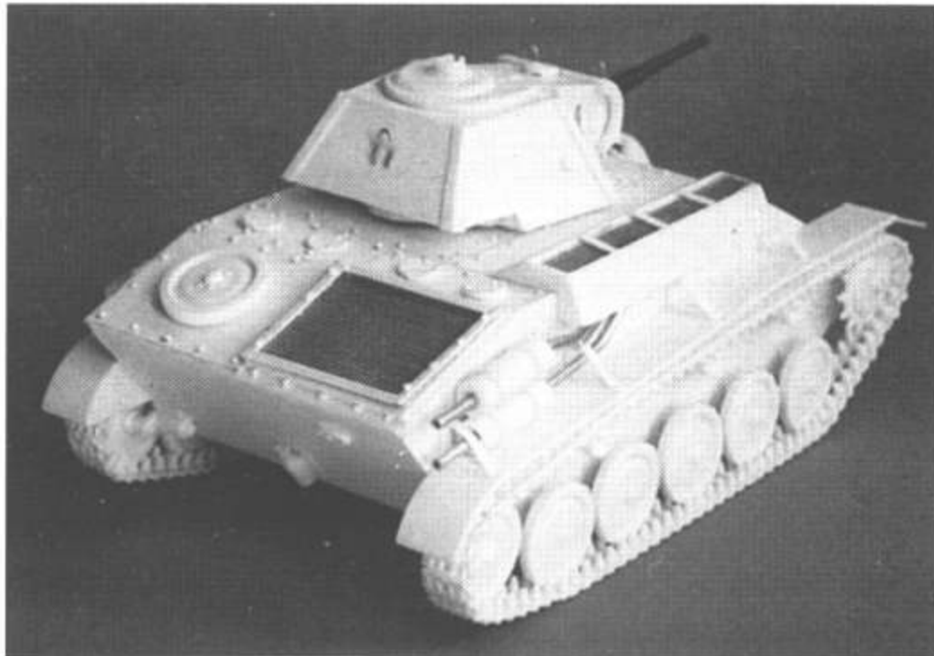
На широком корпусе свободно удалось разместить четыре смот- ровых лючка, на корпусе из модели их только три. Выхлопные трубы сделаны заново. От модели вообще-то остались борта корпуса и ходовая часть.
