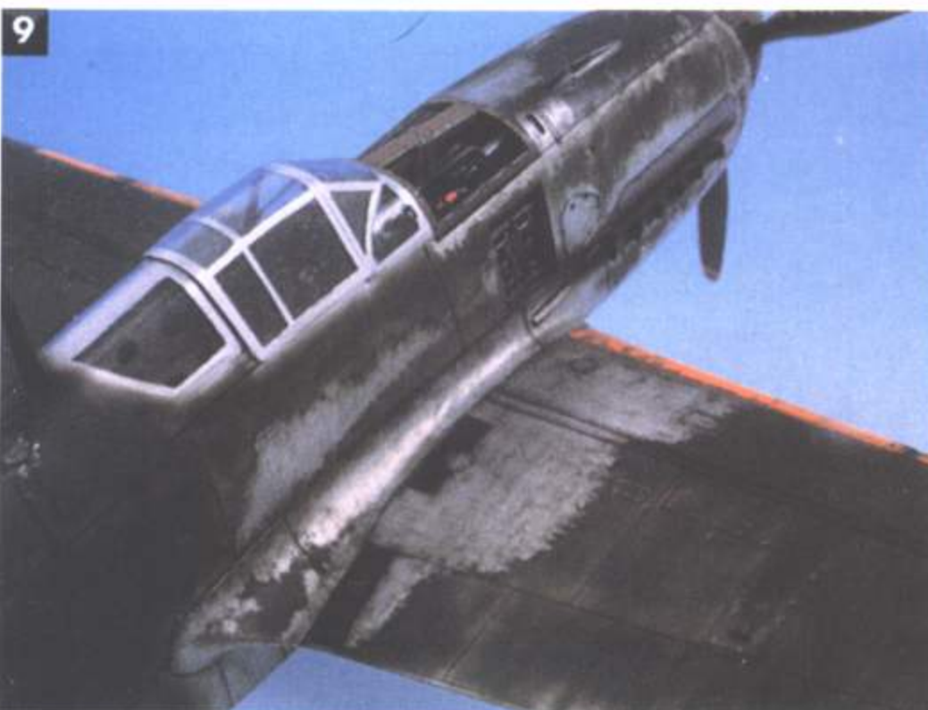
После нанесения зеленой краски имитировались облеслости до металла.
