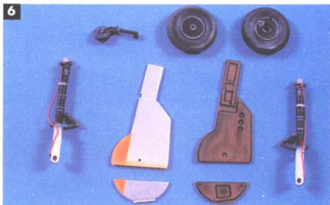
Вся доработка опор шасси свелась к имитации тормозных магистралей медной проволокой, однако окраска элементов опор шасси – процесс не столь простой.
