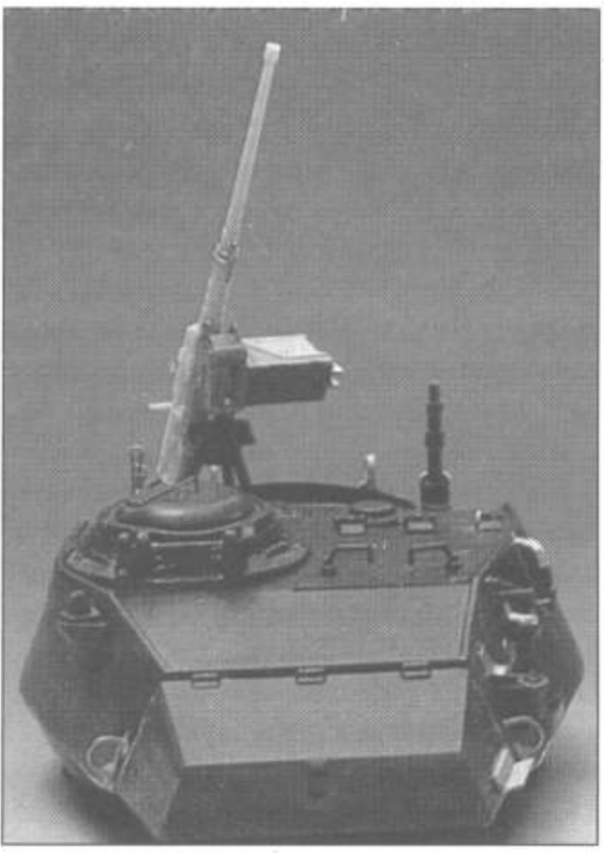
Вид башни сзади. Монтажные проушины - медная проволока, крепежные крюки фототравленные.
