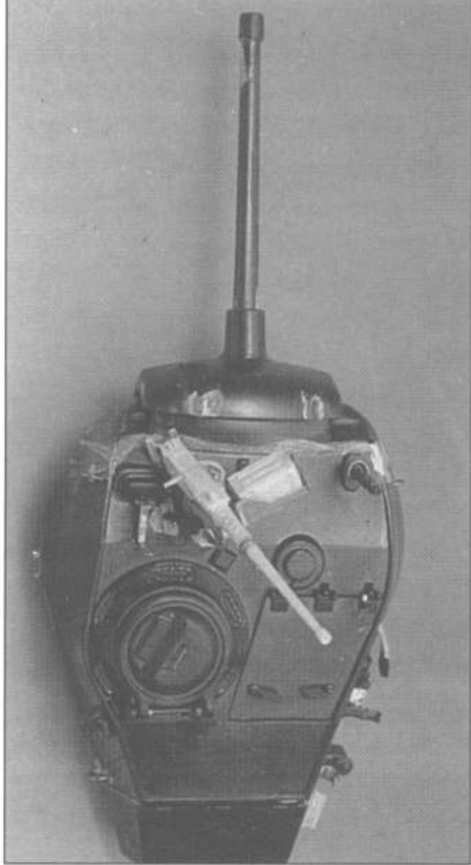
На башне установлен пулемет от фирмы Верлинден, он сделан более подробно.
