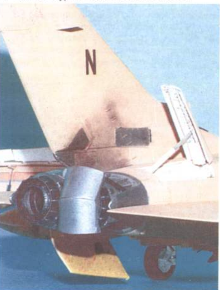
Установленные в открытом положении щитки реверса тяги на правом двигателе.
