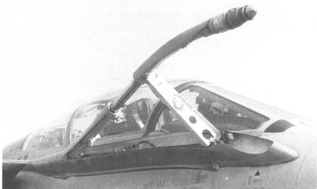
Штанга для дозаправки топливом в воздухе в выпущенном положении.
