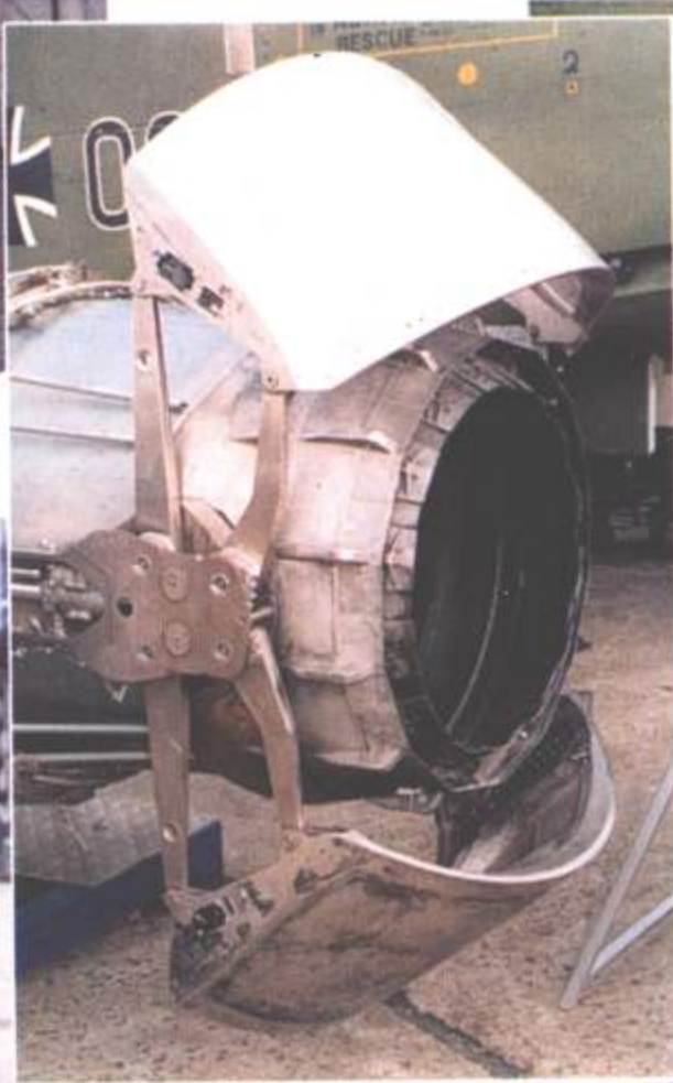
Наполовину отклонен- ные щитки реверса тяги.
