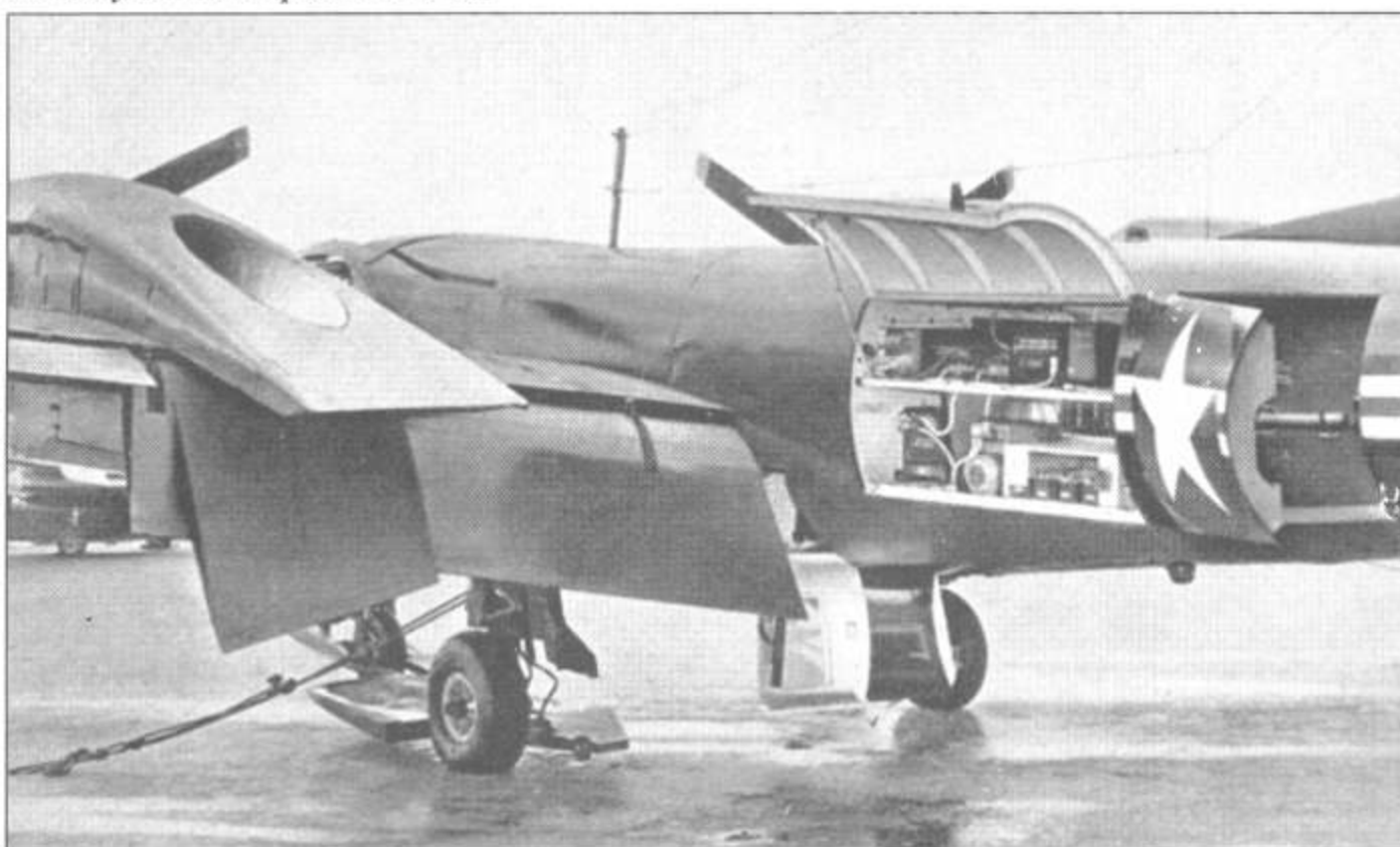
Открыт отсек радиоэлектронной аппаратуры
