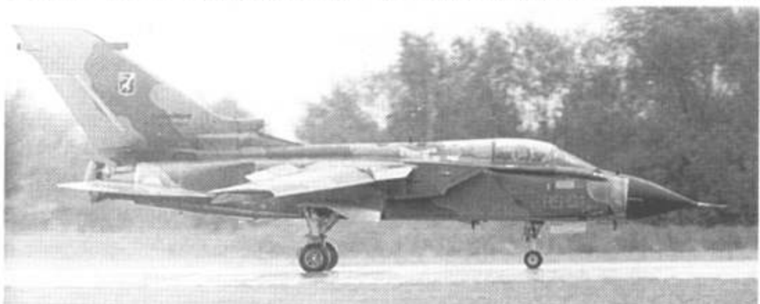
Итальянский Tornado IDS. Прекрасно видны выпущенные закрылки, аэродинамические тормозные щитки и щитки реверса тяги.
