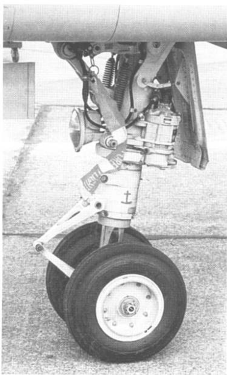
Передняя стойка шасси – вид сбоку.
