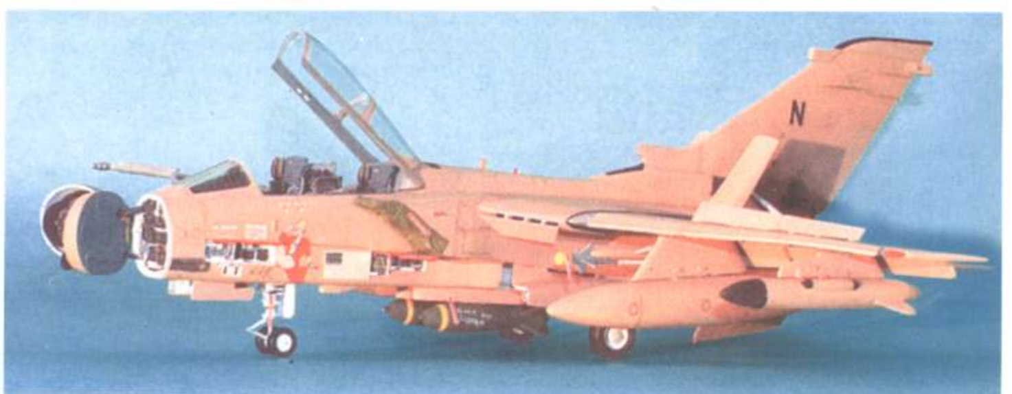
Установленные в открытом положении щитки реверса тяги на правом двигателе.
