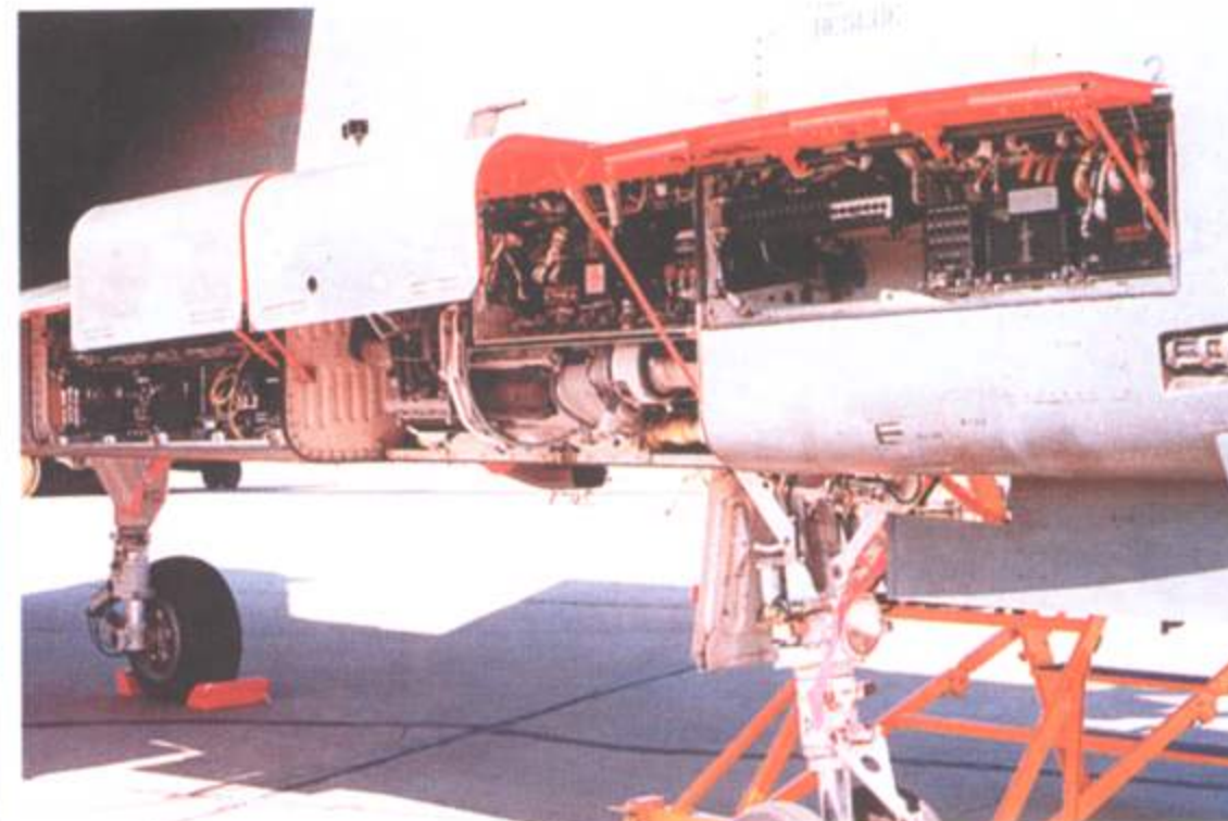
Открытые люки с блоками электроники, здесь же виден люк пушки «IWKA-Mauser» калибра 27 мм.
