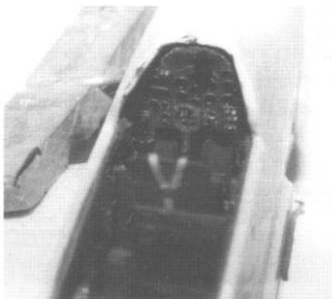
9. Эпоксидный интерьер, вклеенный в половинки фюзеляжа.
