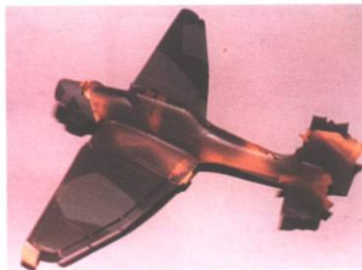
14. Снятие масок после окончания окраски.
