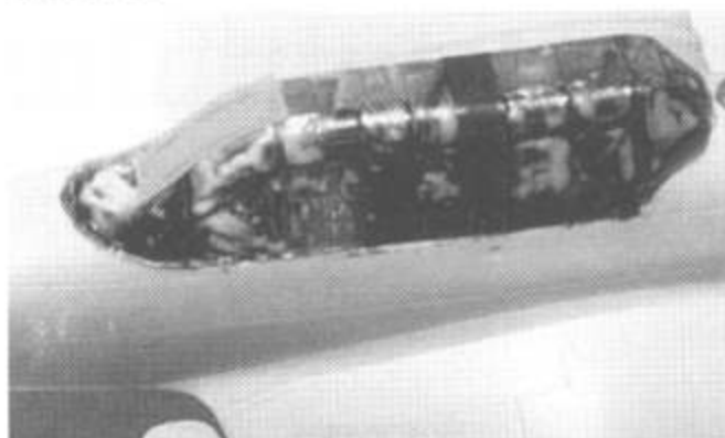
13. Остекление кабины, приклеенное двухкомпонентным клеем roxipol, укрытое масками и лентой Tamiya в ожидании окраски RLM 66.
