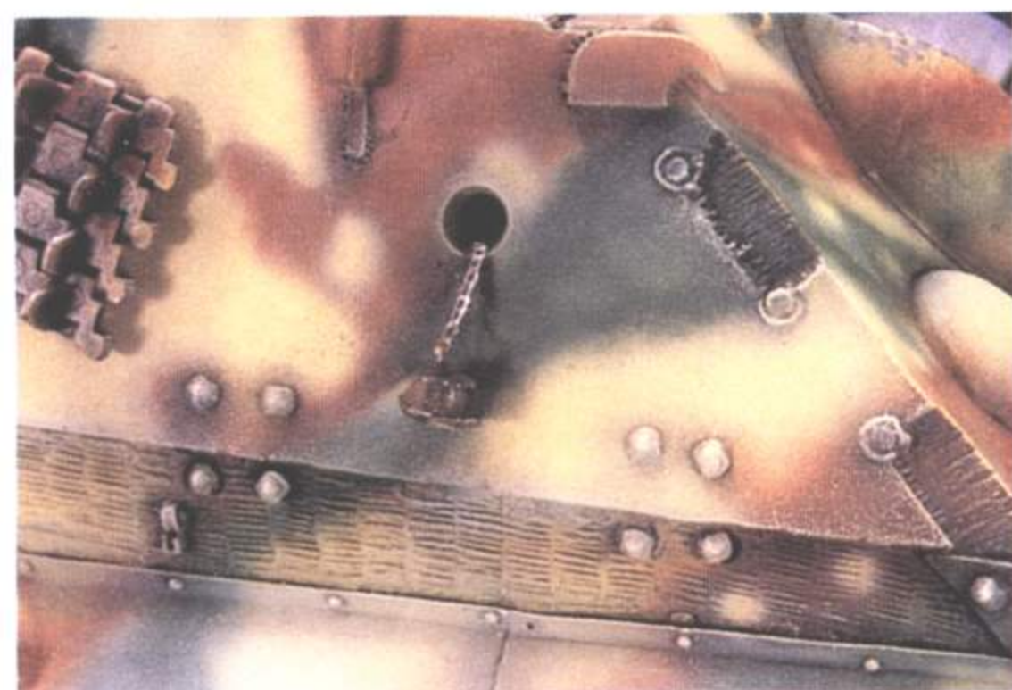
Амбразура в правом борту сделана открытой, обратите внимание на свисающую на цепочке заглушку. Амбразура предназначена для стрельбы из пулемета.
