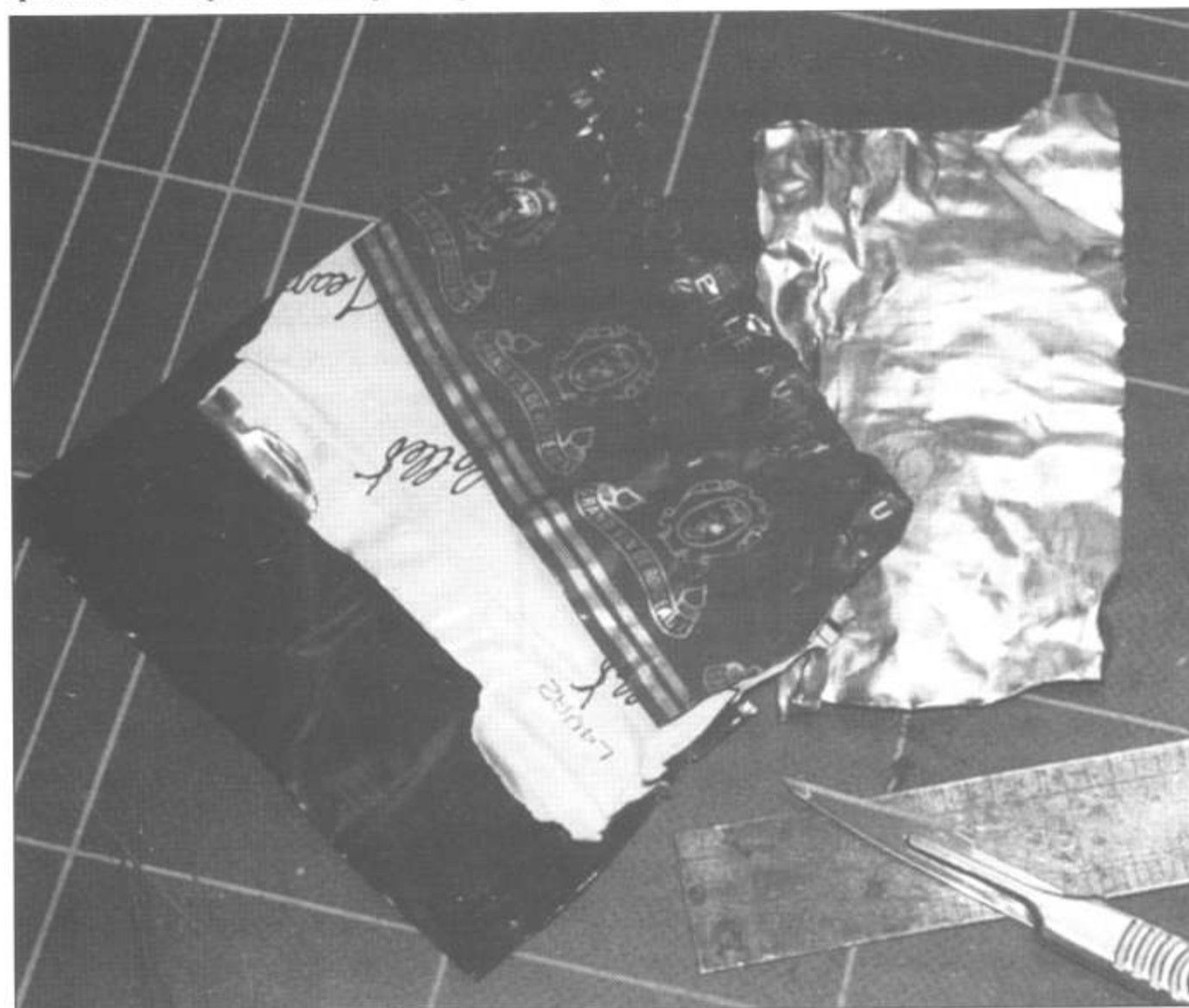
Алюминиевая и свинцовая фольга от бутылок шампанского часто применяется при доработке моделей. Из нее получают превосходные привязные ремни на кресла и стяжные полосы крепления гидропроводов на стойках шасси.
