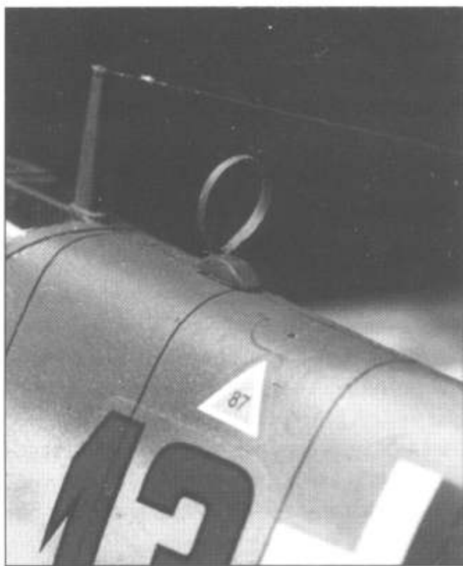
Самодельная рамочная антенна на модели Bf.109G-6.
