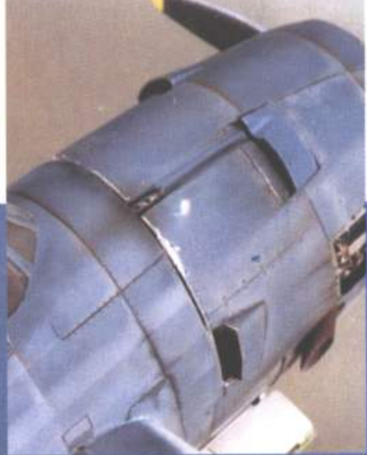
Обратите внимание на щели между панелями капота двигателя – щели сделаны специально, на настоящих самолетах они тоже были.
