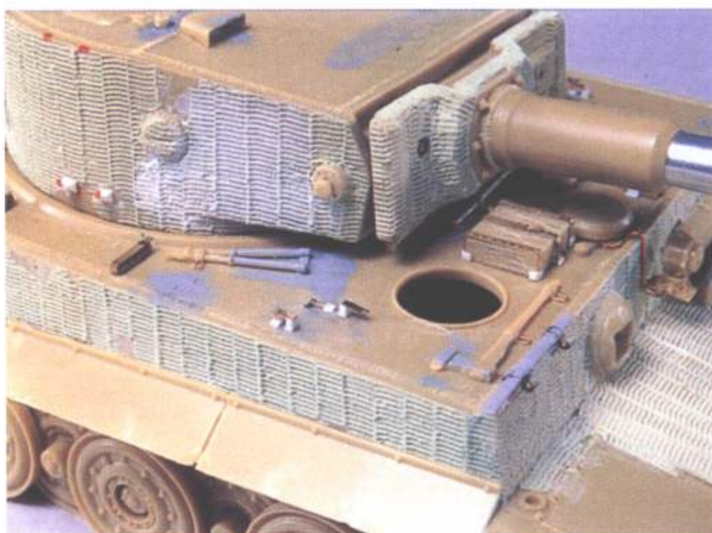
Крепеж для троса сделан из кусочков тонкого пластика и фототравленных деталей.
