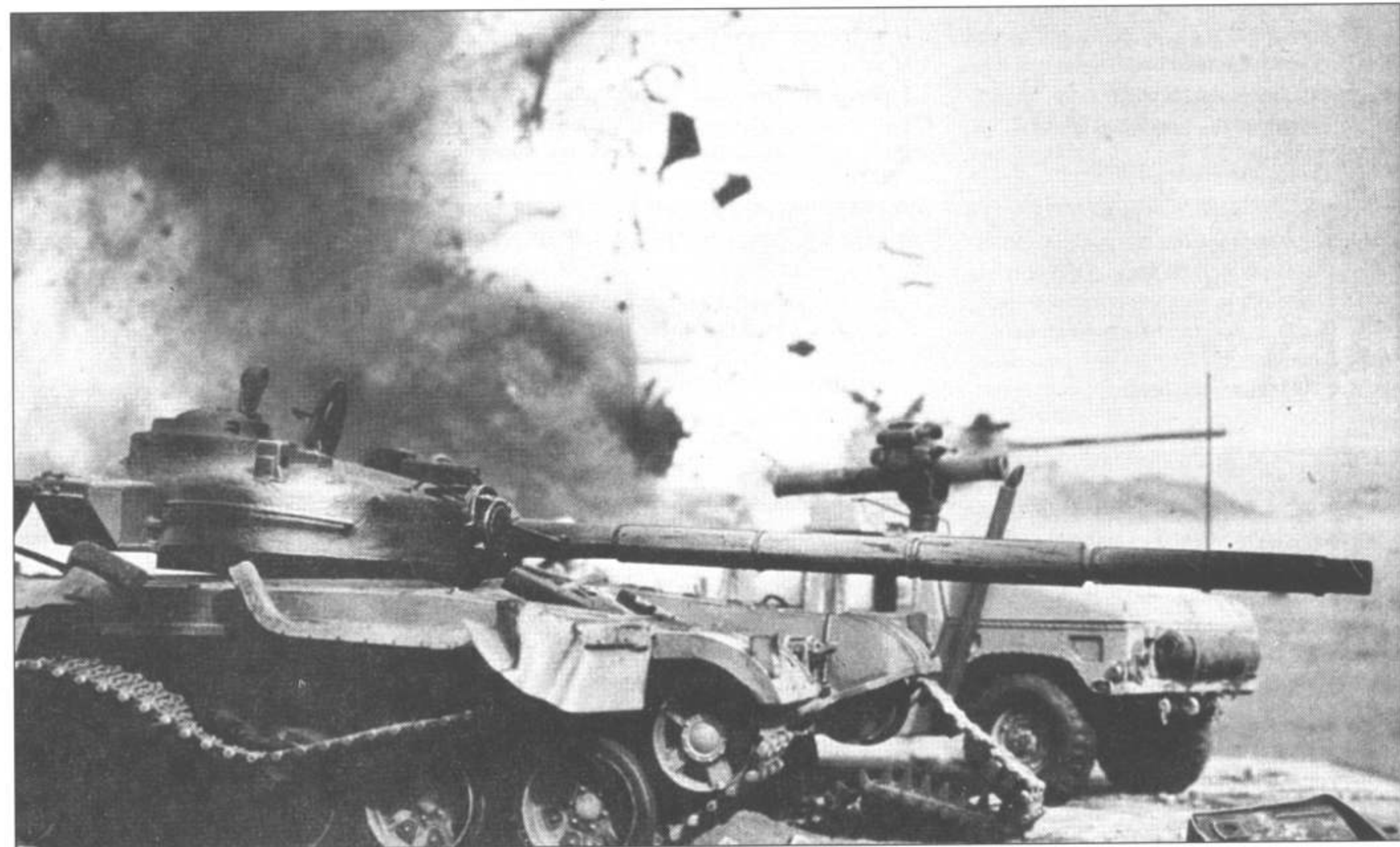
Бортовые экраны модели Т-72 выполнены из очень тонкого листового пластика. Экраны сильно деформированы.
