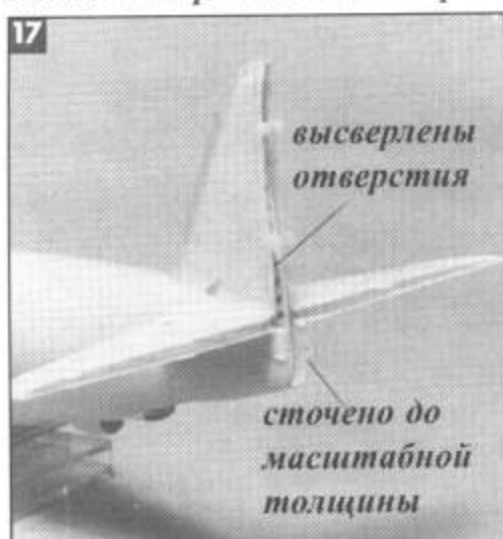
После демонтажа руля направления необходимо воспроизвести внутренности киля по линии навески руля направления.
