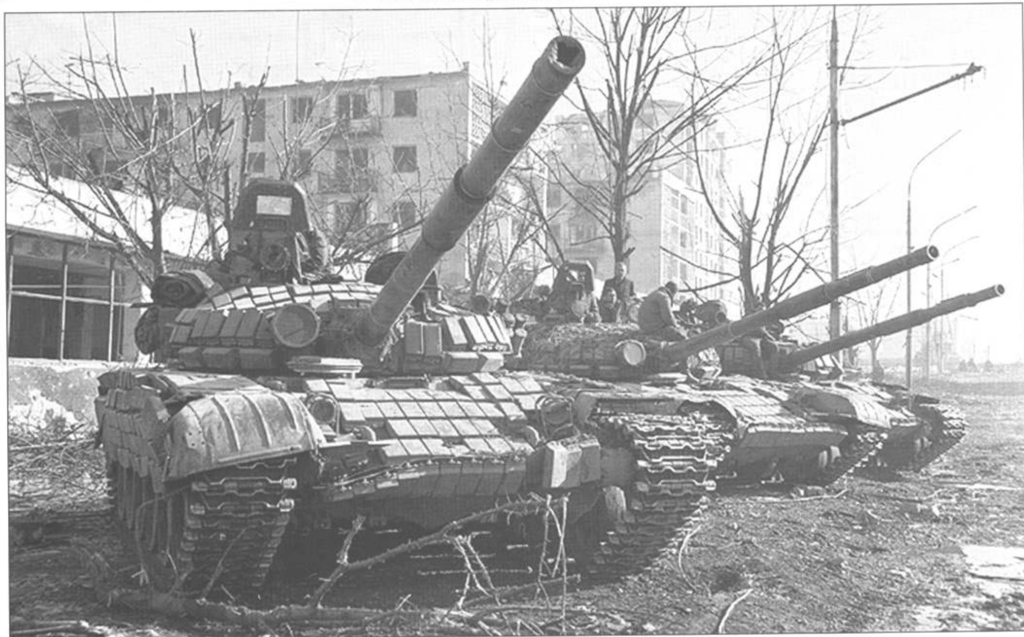
Т-72 Б на одной из улиц Грозного. Обратите внимание, что на участвующих в боевых действиях танках контейнерами ДЗ покрыта не только верхняя лобовая бронеплита, но и часть нижней.
