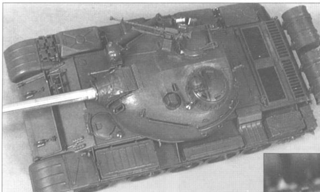
Вид сверху: пушка смещена вправо относительно осевой линии башни. Все другие производители неверно располагали ее по центру.
