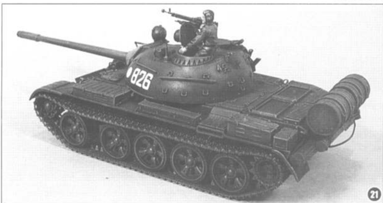
Верхняя ветвь гусеницы приклеена к опорным каткам цианакрилатом.
