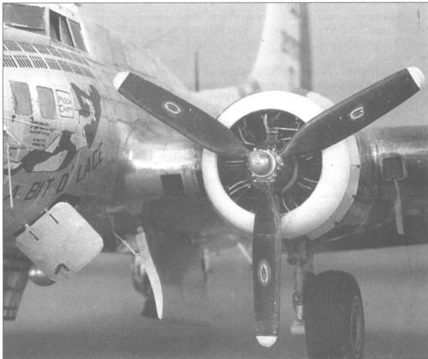
Передняя часть двигателя доработана путем установки мелких деталей, створки юбки капота отклонены.
