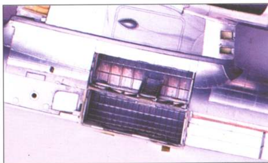
Интерьер бомбоотсека окрашен серебрянкой № 11 фирмы Хамбрел и тонирован пастелью.
